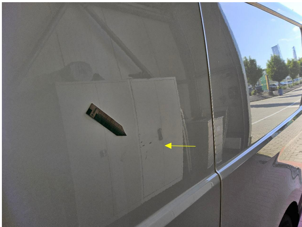
Bild 14 : Seitenteil hinten links, eingedellt, instandsetzen und lackieren mit Lackaufbau
