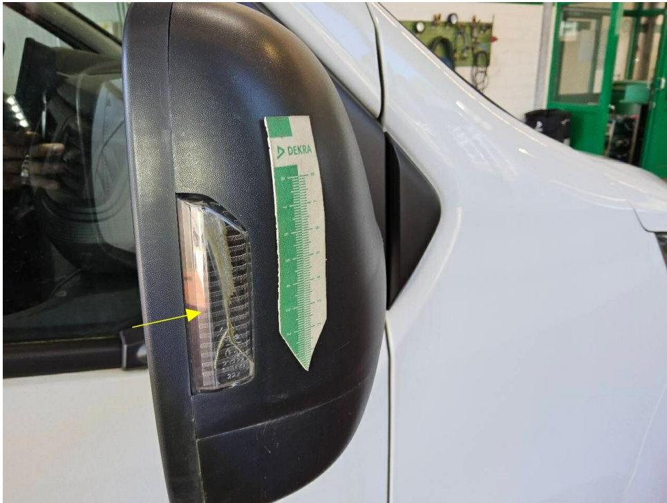
Bild 21 : Spiegelblinker rechts, zerbrochen
