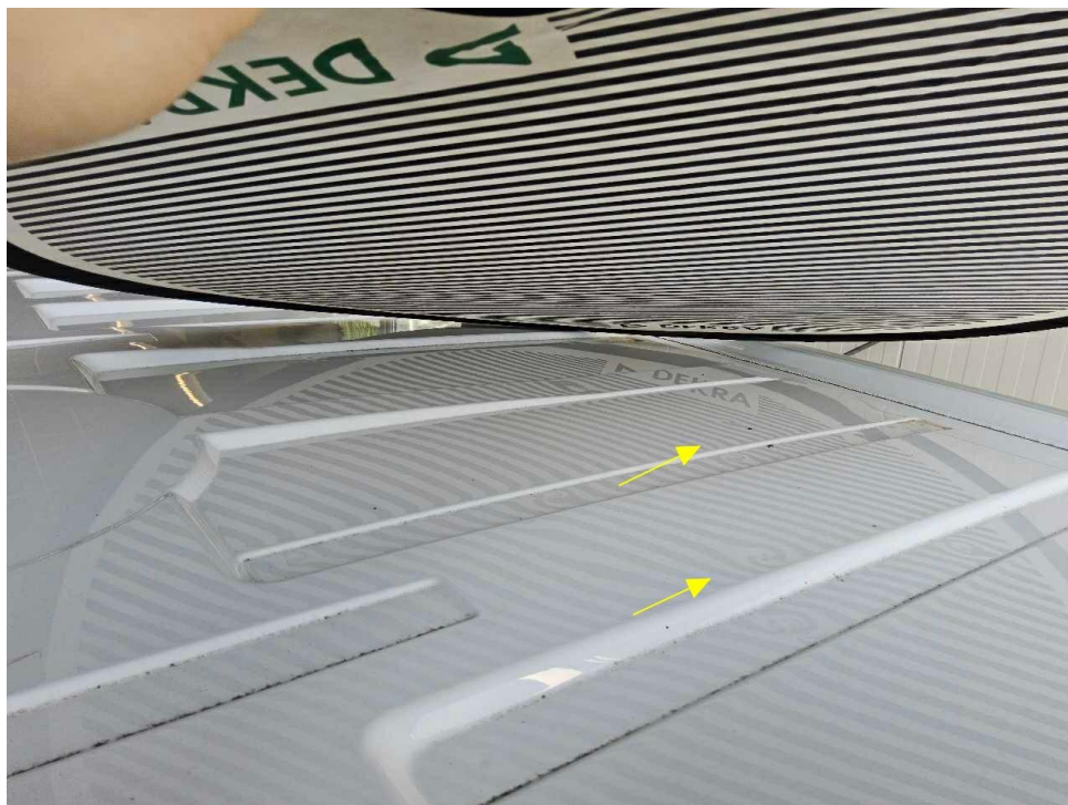
Bild 26 : Dach, mehrfach eingedellt, drücken
