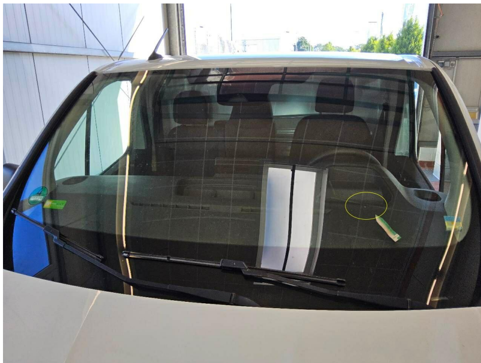
Bild 17 : Frontscheibe, Steinschlag im Sichtfeld
