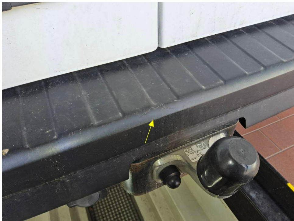
Bild 28 : Stoßfänger hinten, zerkratzt, Gebrauchsspur
