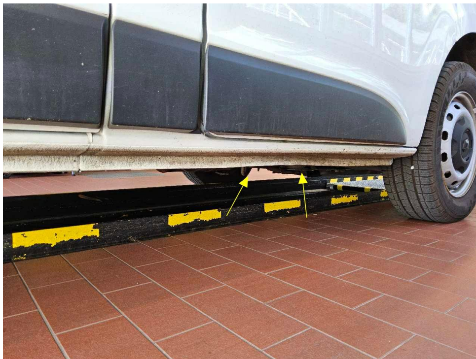
Bild 23 : Seitenschweller rechts, verformt, instandsetzen und lackieren mit Lackaufbau
