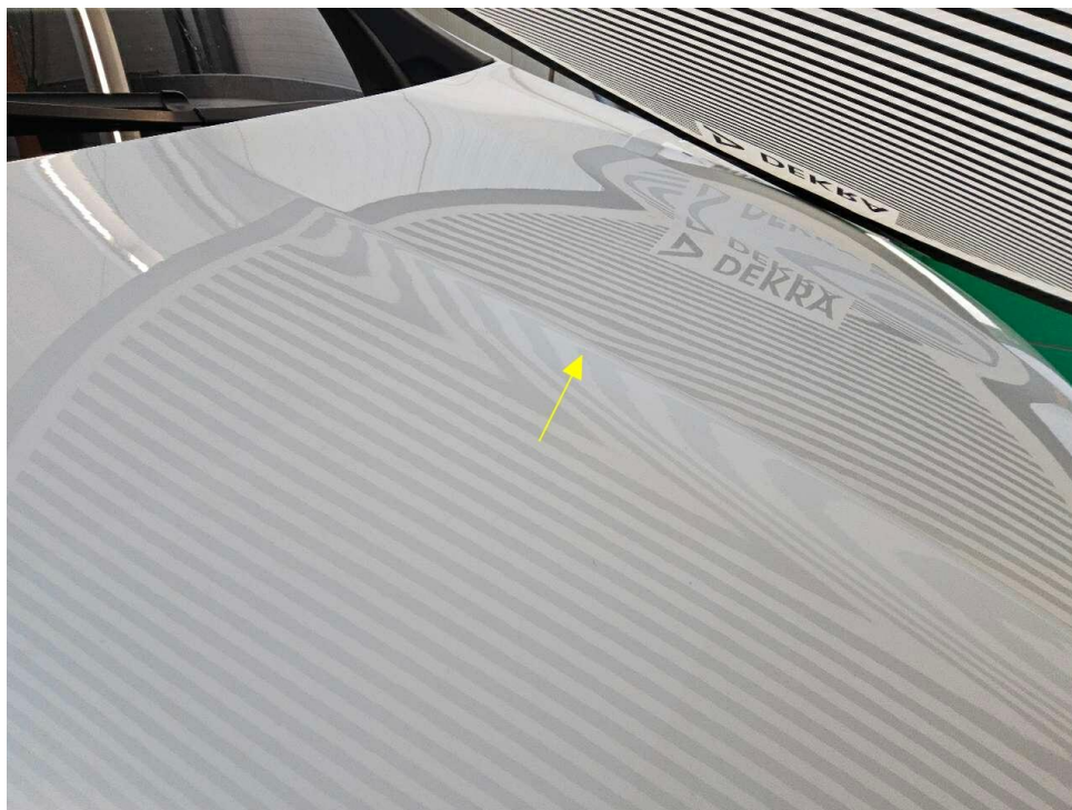
Bild 19 : Motorhaube, eingedellt, drücken
