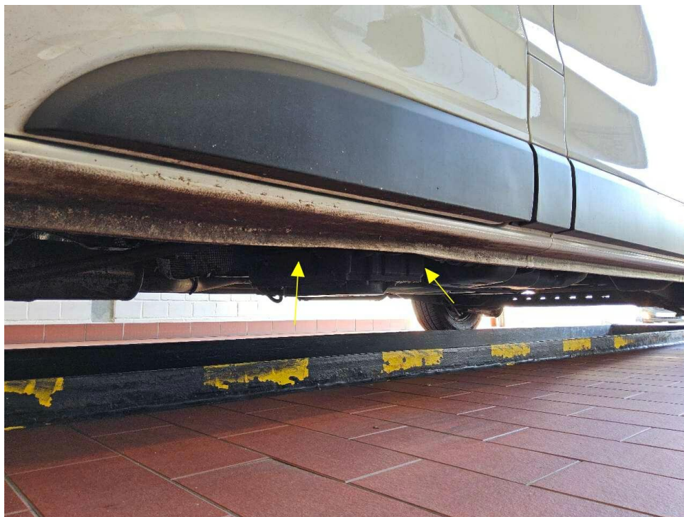
Bild 15 : Seitenschweller links, verformt, instandsetzen und lackieren mit Lackaufbau
