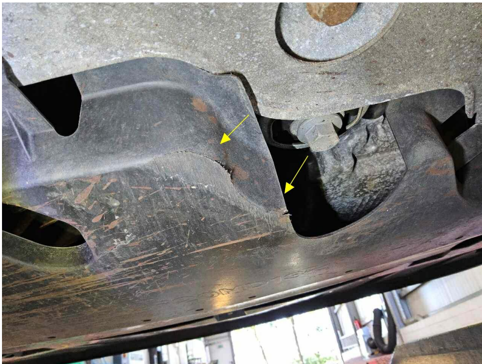
Bild 32 : Unterfahrschutz vorne, zerkratzt
