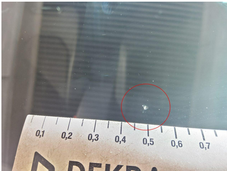
Bild 15 : Frontscheibe, Steinschlag mit Rissbildung
