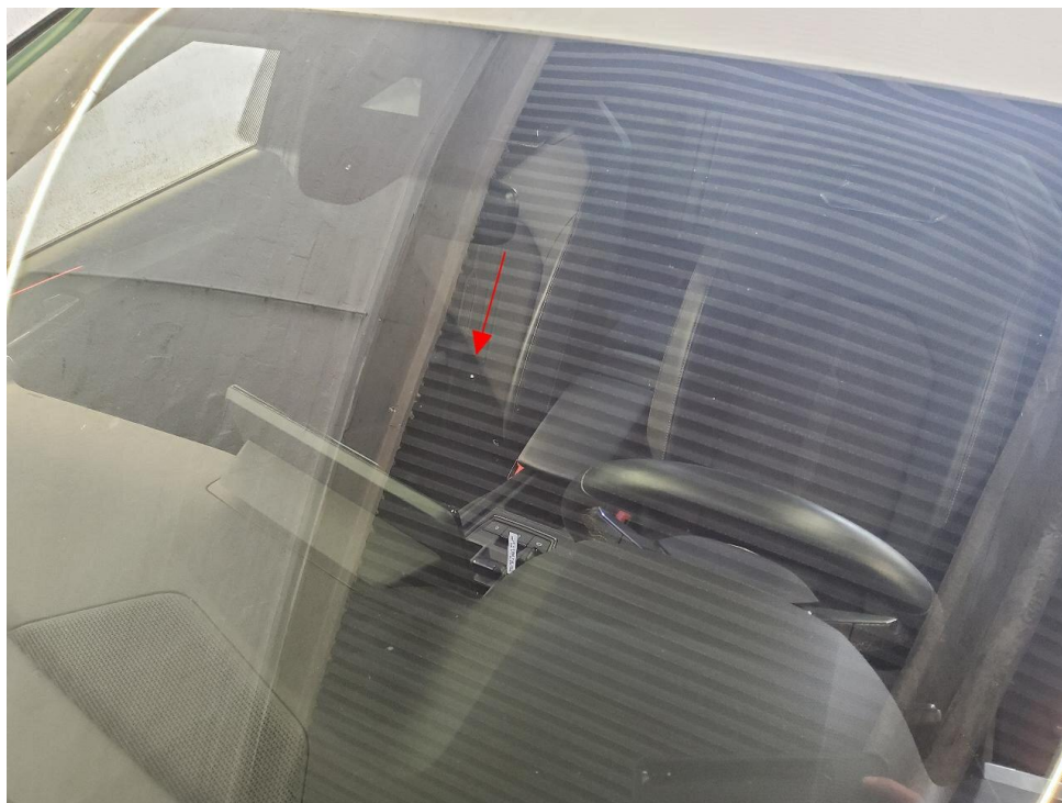
Bild 14 : Frontscheibe, Steinschlag mit Rissbildung
