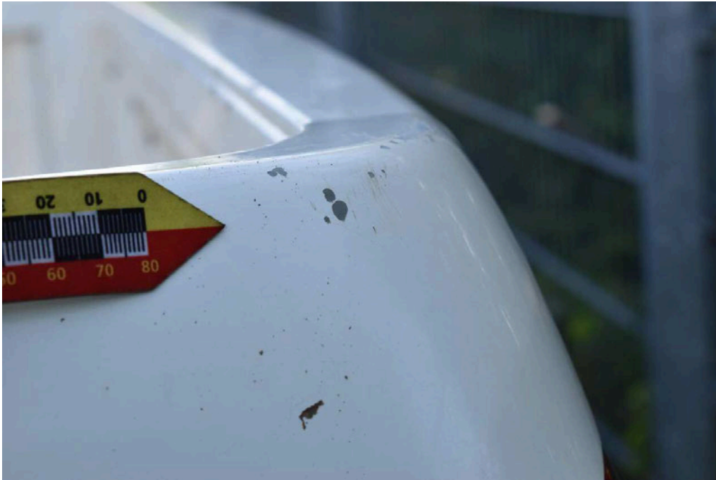
Bild 45 linke Seite Seitenwand links Kratzer/Dellen
