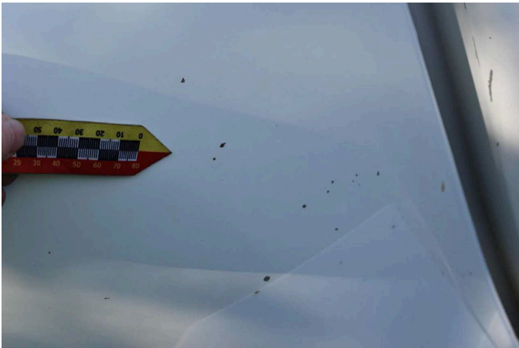
Bild 60 rechte Seite Seitenwand rechts Kratzer/Dellen
