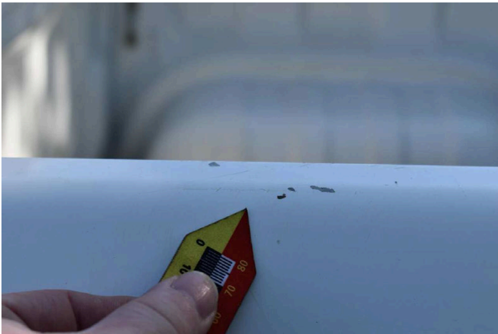
Bild 42 linke Seite Seitenwand links Kratzer/Dellen
