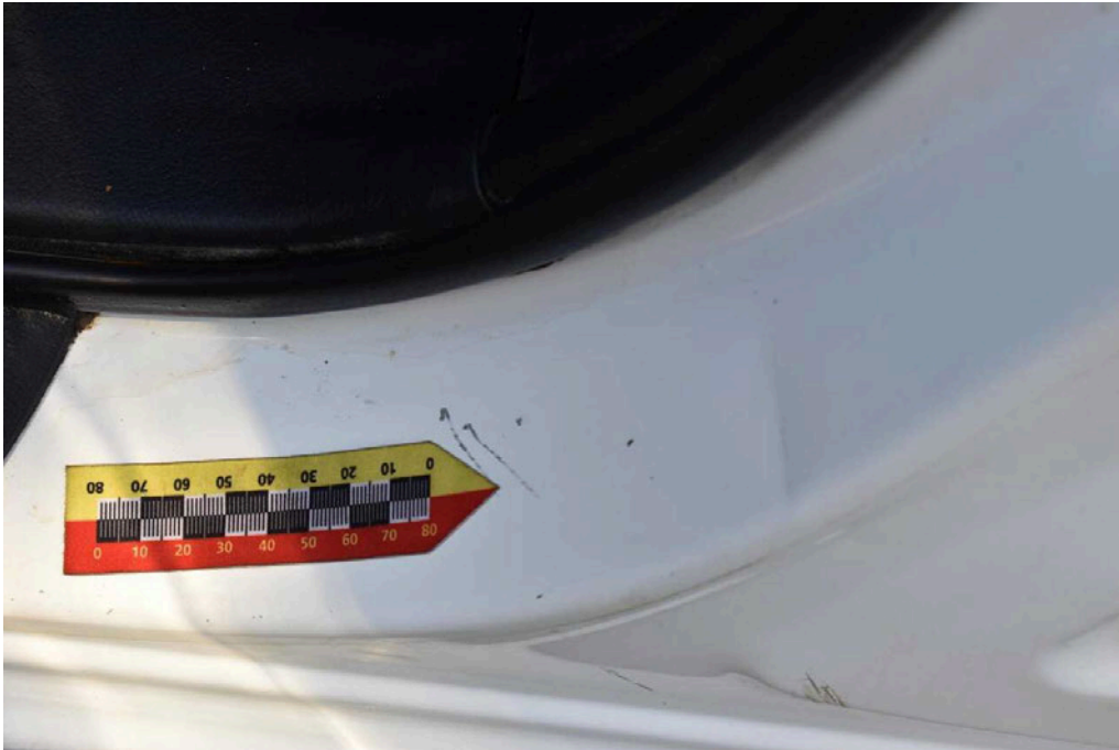
Bild 35 Innenraum Einstieg vorne links Kratzer/Dellen
