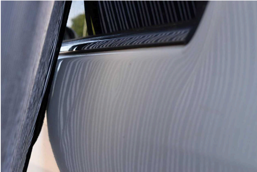
Bild 39 linke Seite Tür hinten links Dellen
