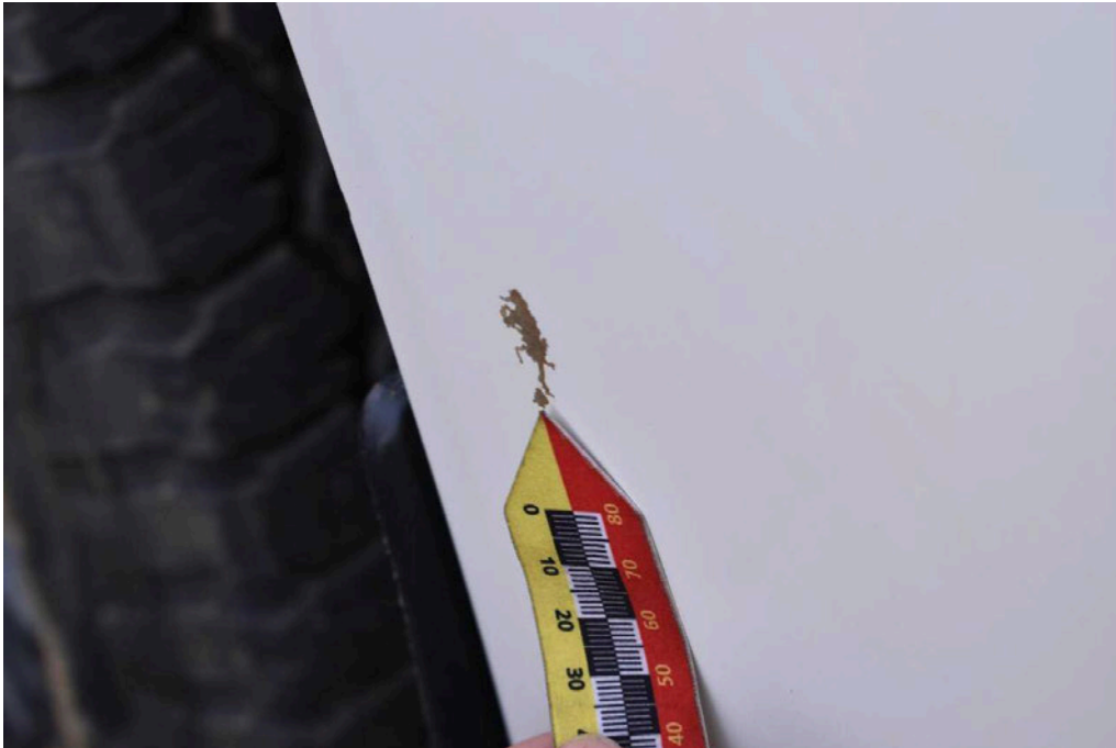
Bild 47 linke Seite Seitenwand links Kratzer/Dellen
