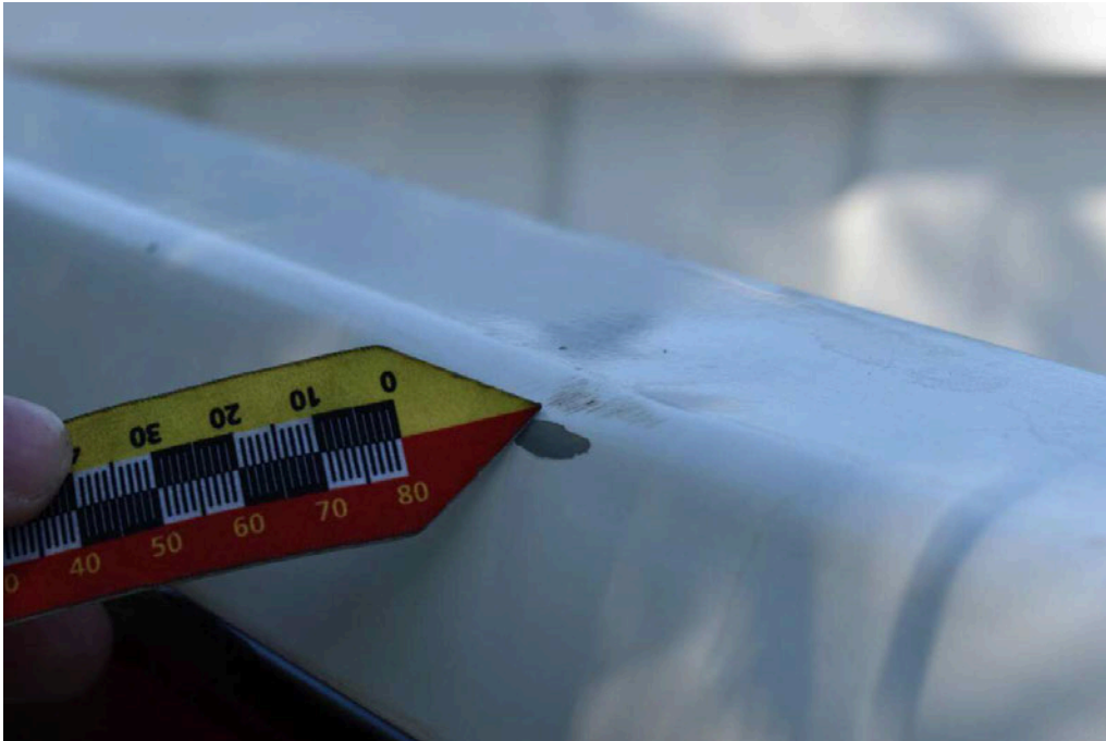
Bild 51 Fahrzeugheck Heckklappe Kratzer/Dellen
