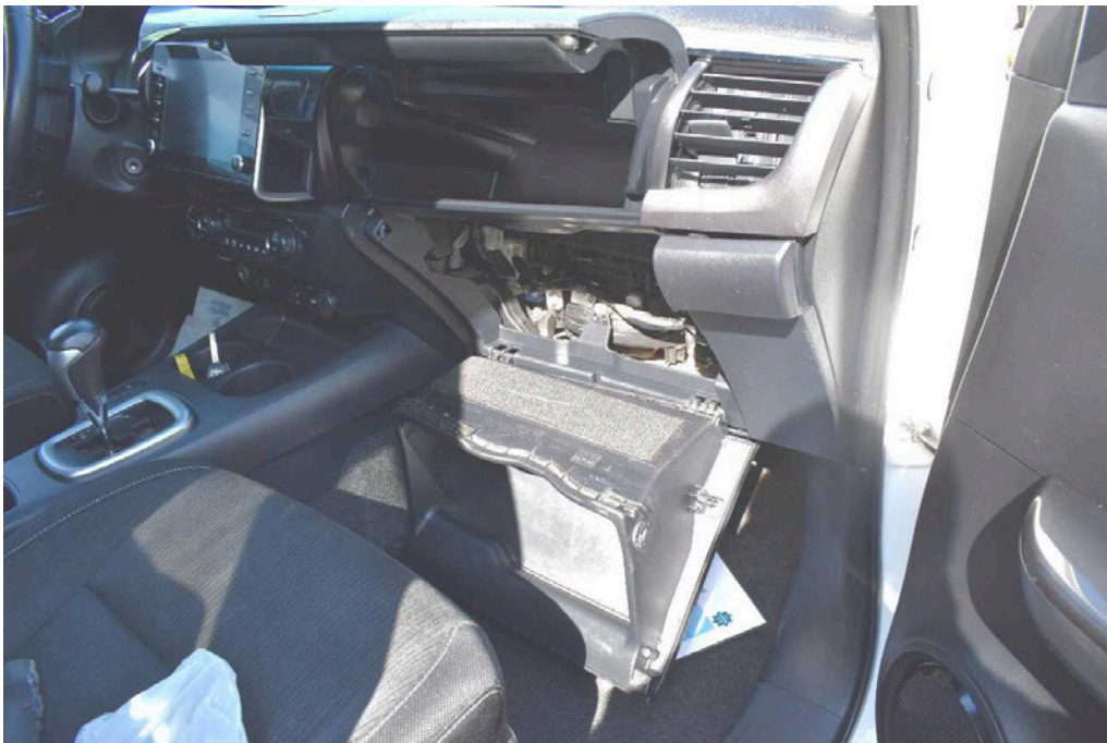
Bild 78 Innenraum Handschuhfach Dämpfer fehlt beschädigt
