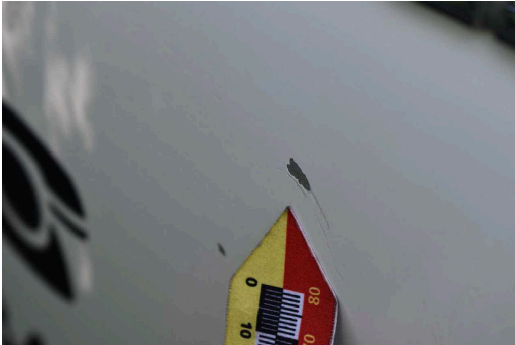
Bild 55 Fahrzeugheck Heckklappe Kratzer/Dellen
