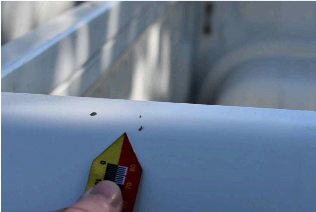
Bild 43 linke Seite Seitenwand links Kratzer/Dellen
