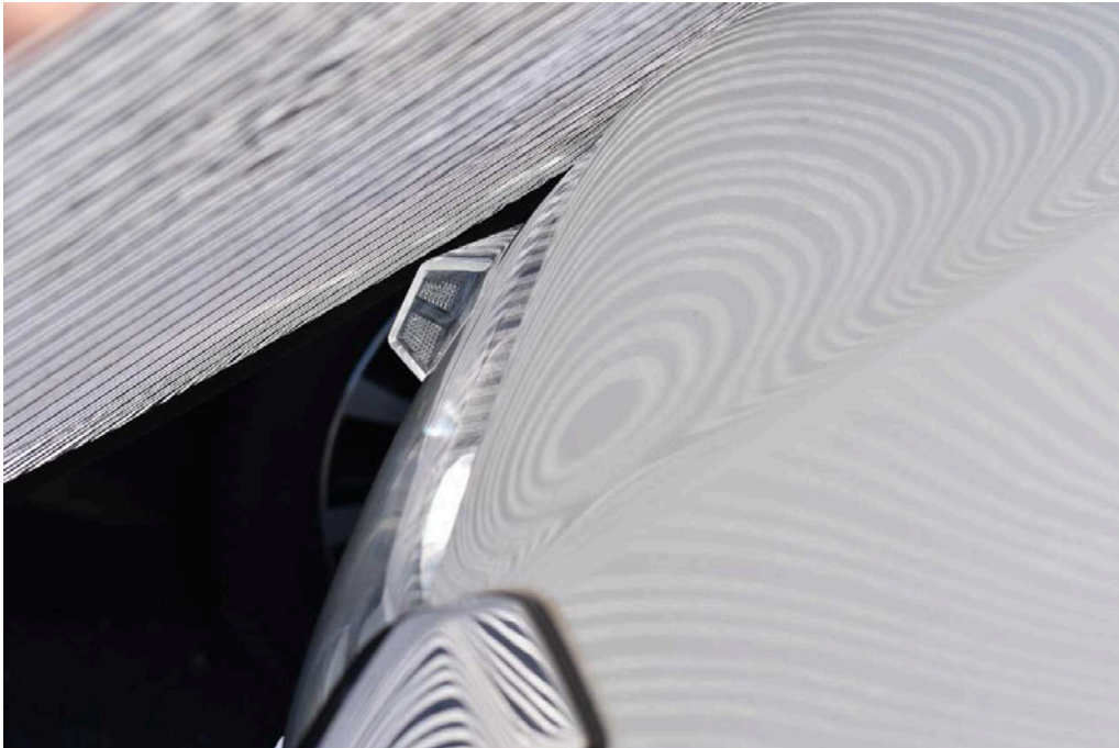
Bild 25 Fahrzeugfront Motorhaube Dellen
