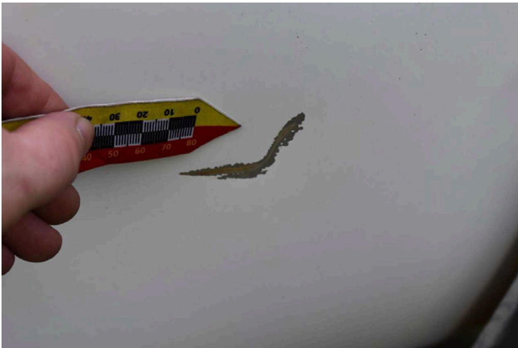
Bild 46 linke Seite Seitenwand links Kratzer/Dellen
