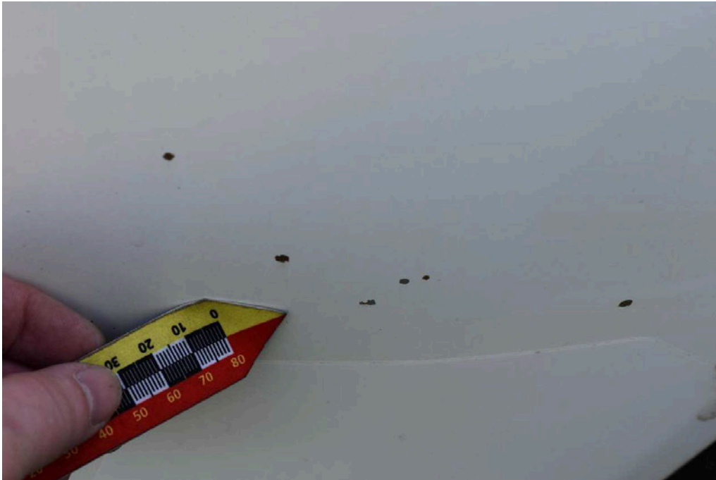
Bild 41 linke Seite Seitenwand links Kratzer/Dellen
