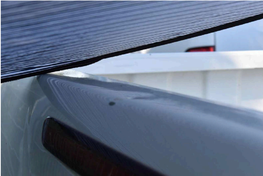
Bild 49 Fahrzeugheck Heckklappe Kratzer/Dellen
