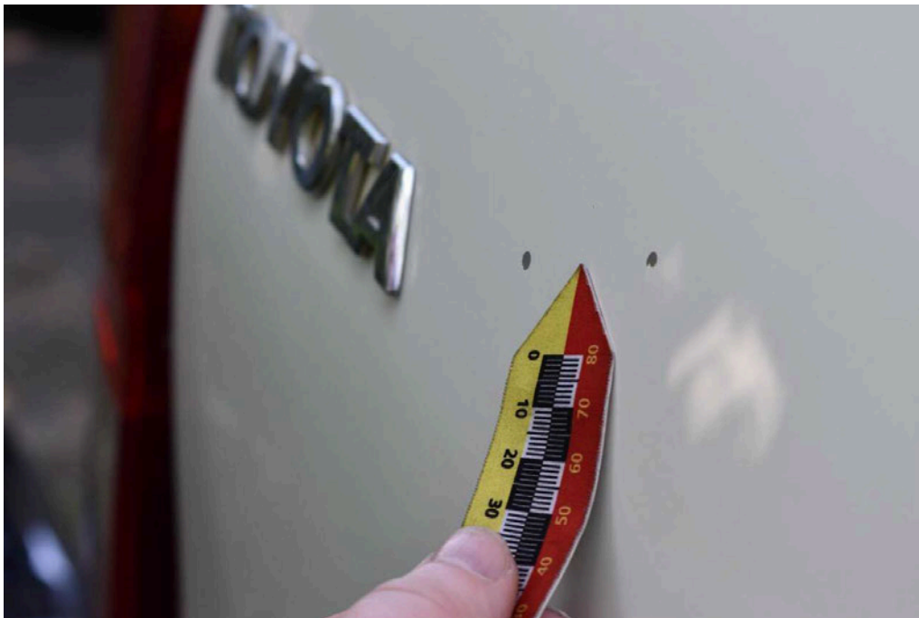
Bild 53 Fahrzeugheck Heckklappe Kratzer/Dellen
