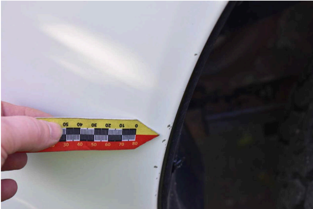
Bild 61 rechte Seite Seitenwand rechts Kratzer/Dellen
