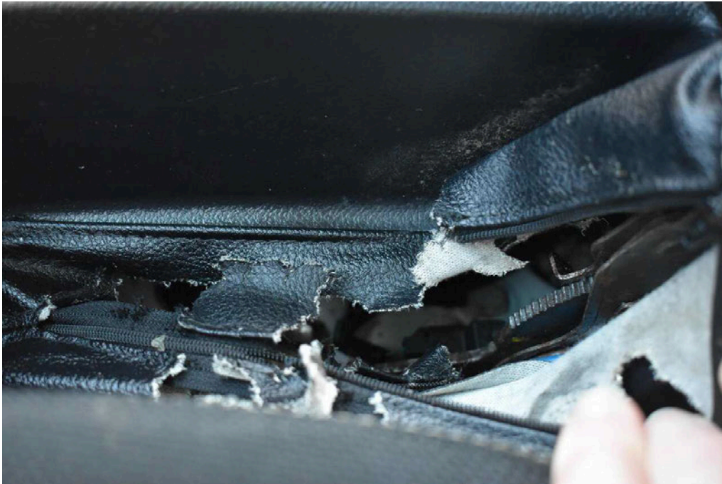
Bild 75 Innenraum Handbremshebel Abdeckung beschädigt
