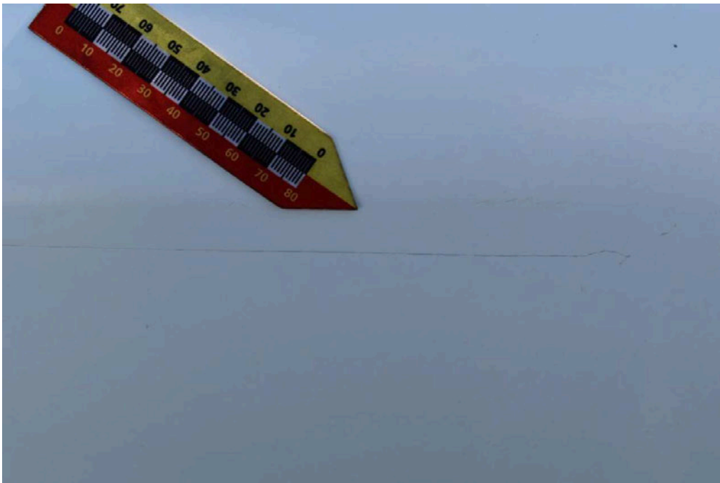
Bild 30 linke Seite Kotflügel vorne links Kratzer
