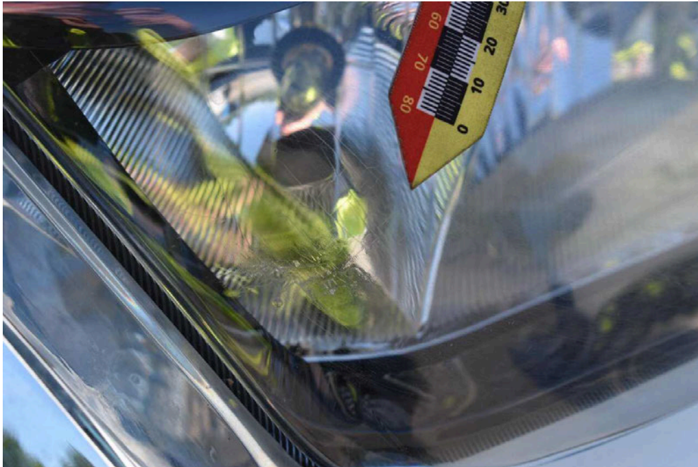
Bild 23 Fahrzeugfront Hauptscheinwerfer links beschädigt
