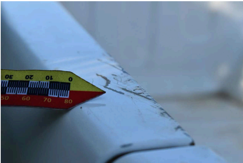
Bild 50 Fahrzeugheck Heckklappe Kratzer/Dellen
