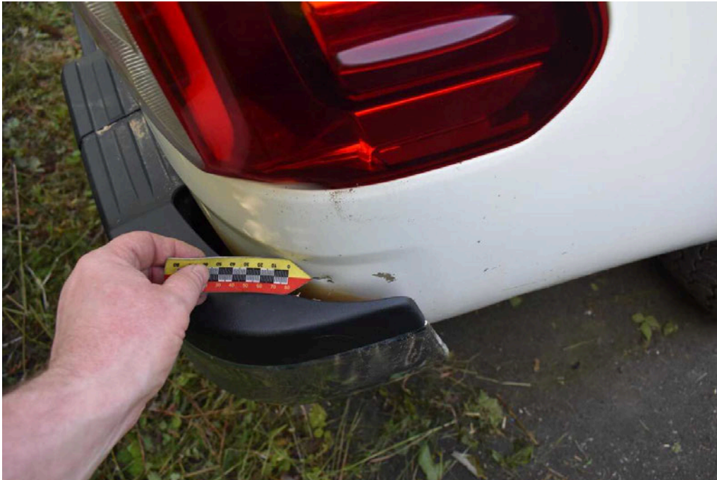
Bild 57 rechte Seite Seitenwand rechts Kratzer/Dellen
