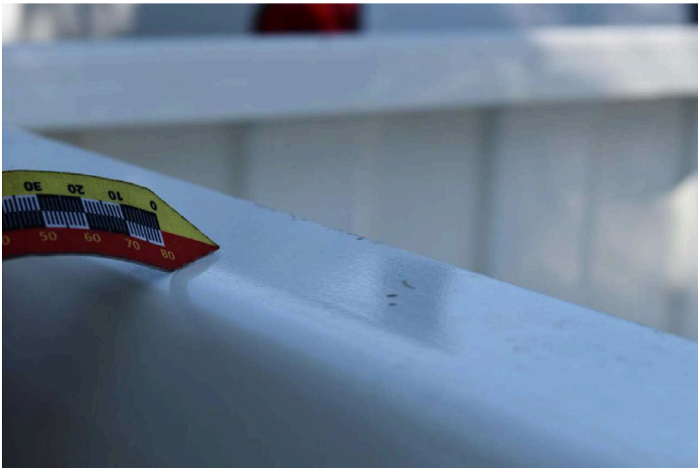
Bild 52 Fahrzeugheck Heckklappe Kratzer/Dellen
