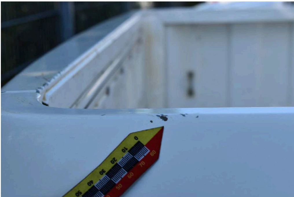
Bild 58 rechte Seite Seitenwand rechts Kratzer/Dellen
