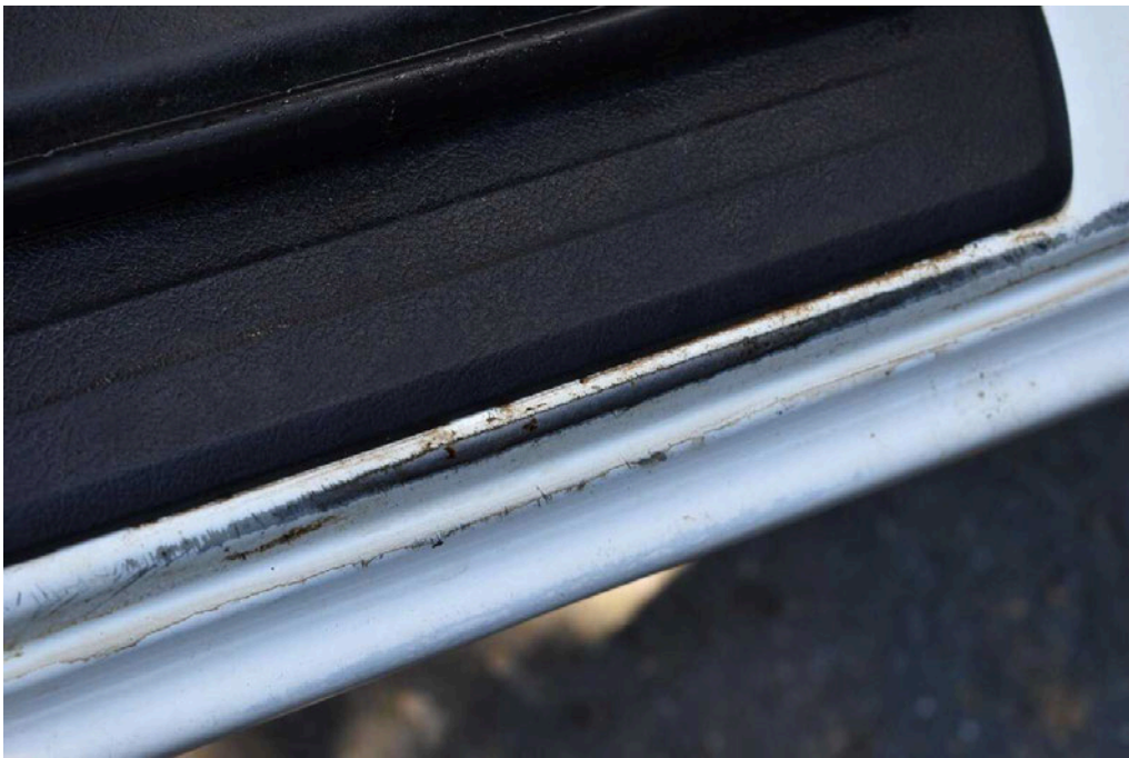
Bild 70 Innenraum Einstieg hinten rechts Lackabtrag und Korrosion
