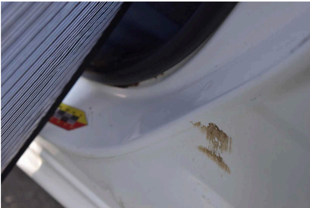
Bild 36 Innenraum Einstieg vorne links Kratzer/Dellen
