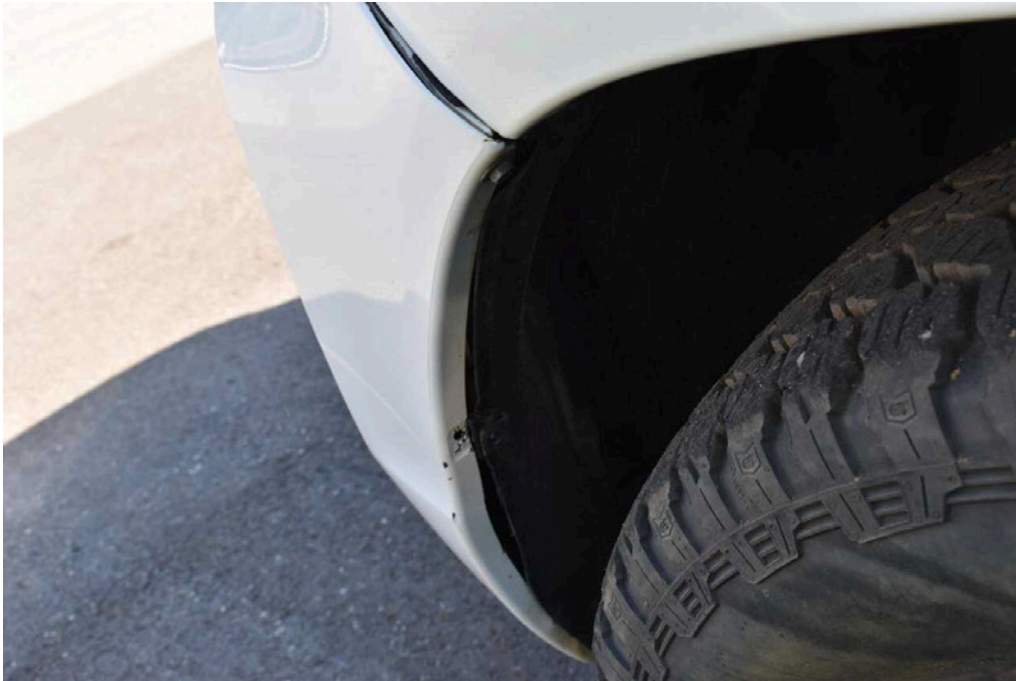
Bild 19 Fahrzeugfront Stoßfänger vorne deformiert
