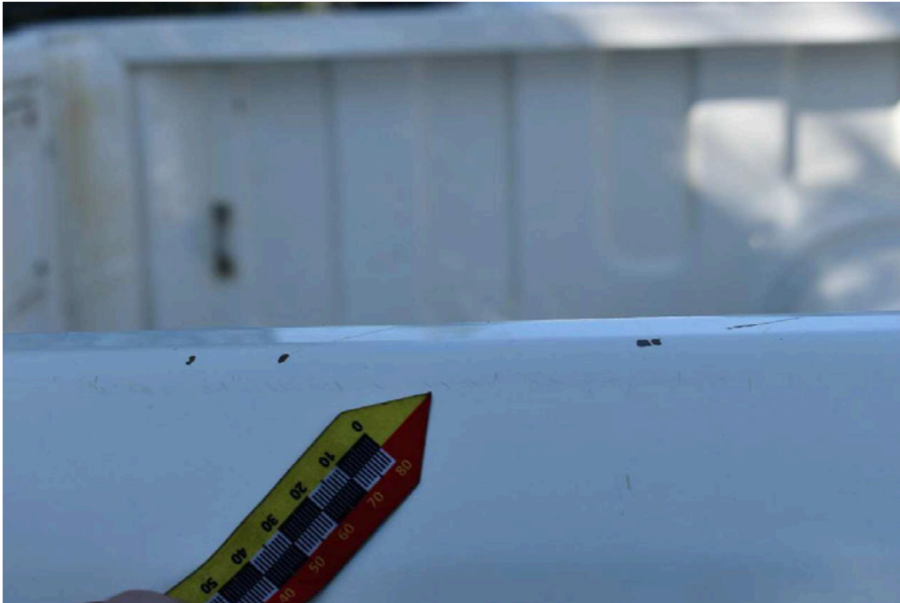
Bild 59 rechte Seite Seitenwand rechts Kratzer/Dellen
