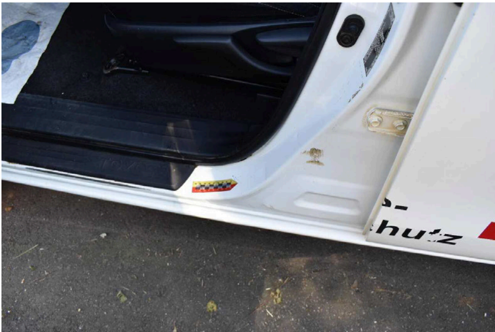
Bild 34 Innenraum Einstieg vorne links Kratzer/Dellen
