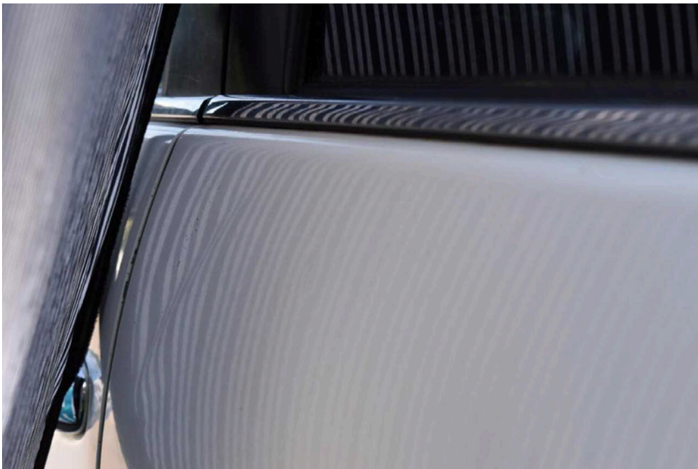
Bild 38 linke Seite Tür hinten links Dellen
