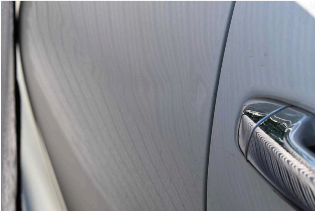
Bild 65 rechte Seite Tür hinten rechts Kratzer/Dellen
