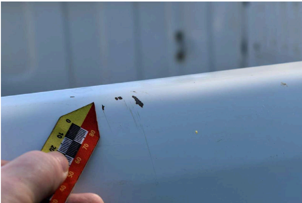
Bild 44 linke Seite Seitenwand links Kratzer/Dellen
