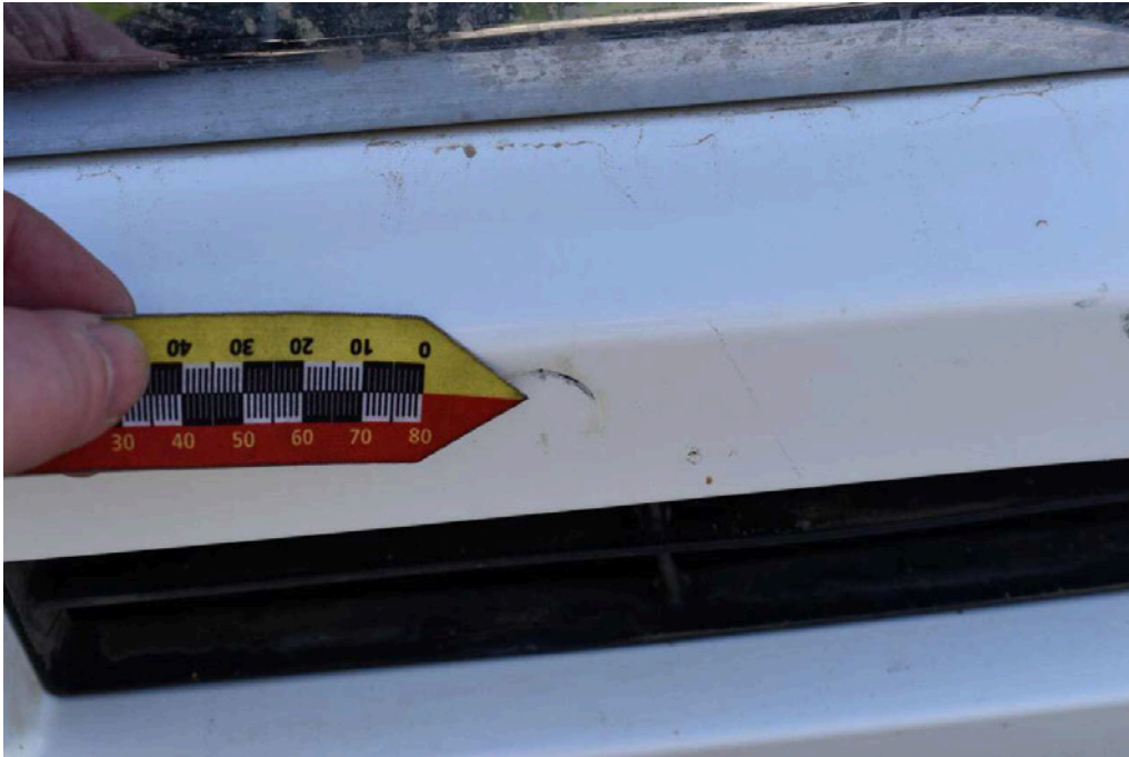
Bild 17 Fahrzeugfront Stoßfänger vorne deformiert
