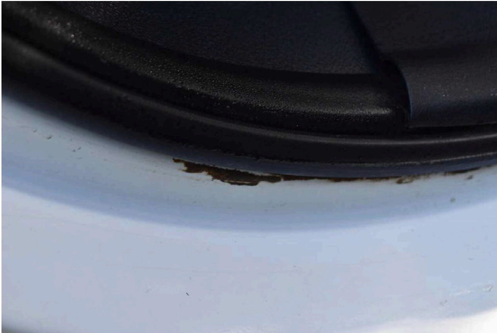
Bild 69 Innenraum Einstieg hinten rechts Lackabtrag und Korrosion
