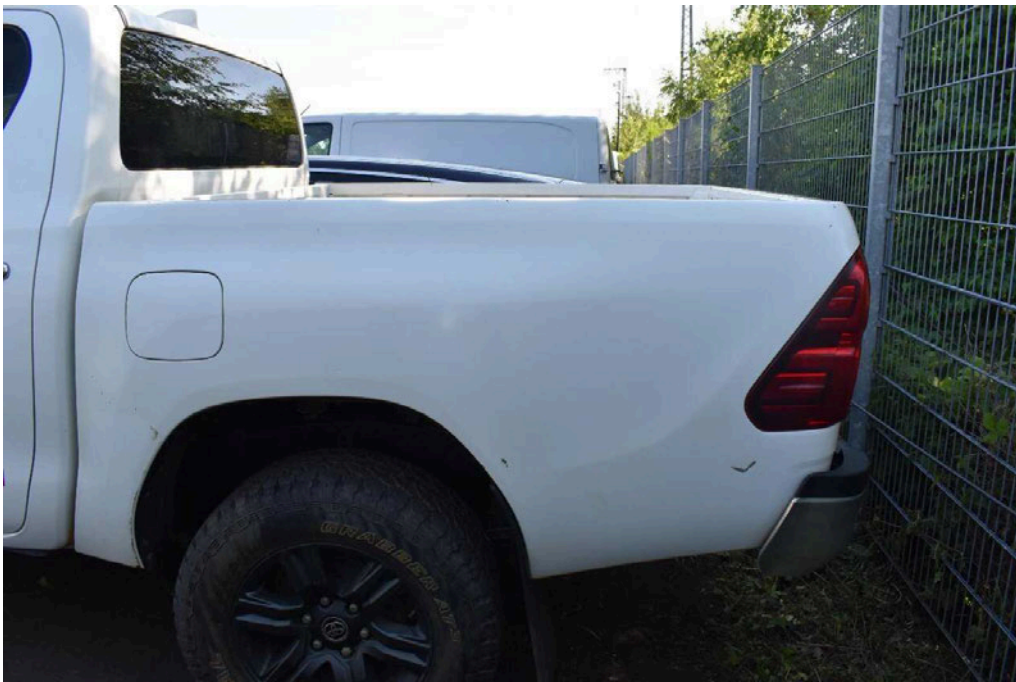
Bild 40 linke Seite Seitenwand links Kratzer/Dellen
