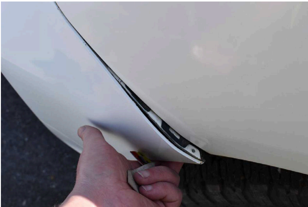
Bild 18 Fahrzeugfront Stoßfänger vorne deformiert
