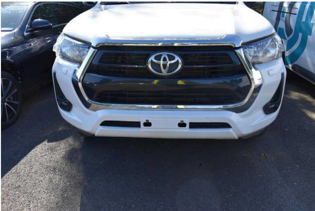
Bild 16 Fahrzeugfront Stoßfänger vorne deformiert
