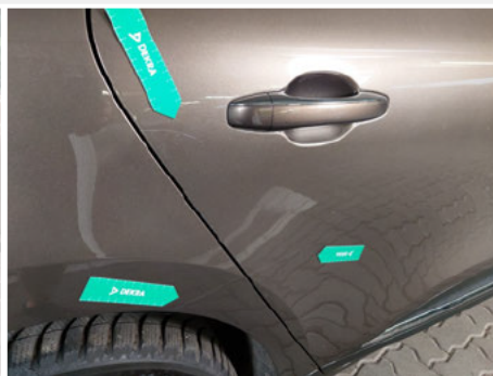
Tür / Hinten Rechts / Kratzer
