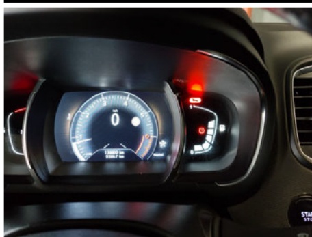
Warnleuchte Inspektion / Fehlt
