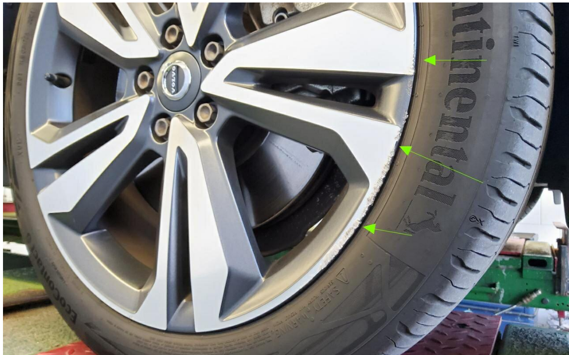
Bild 17 : Alufelge (glanzgedreht) vorne rechts verschrammt
