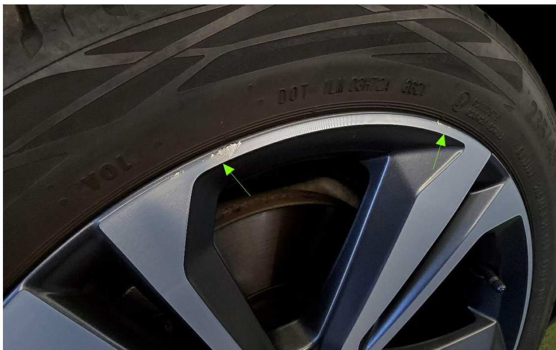
Bild 14 : Alufelge (glanzgedreht) vorne links verschrammt
