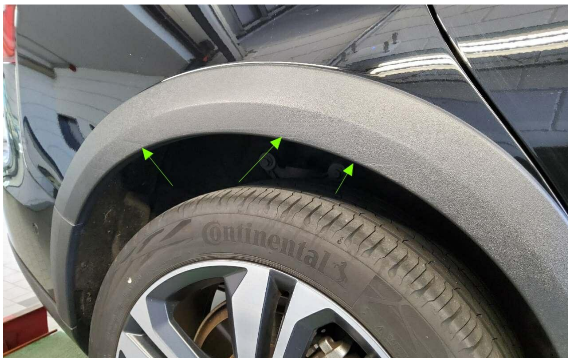
Bild 16 : Radlaufblende hinten rechts verschrammt
