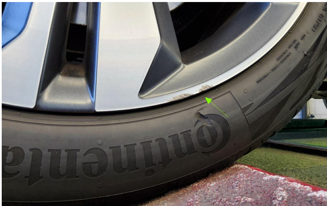
Bild 13 : Alufelge (glanzgedreht) vorne links verschrammt
