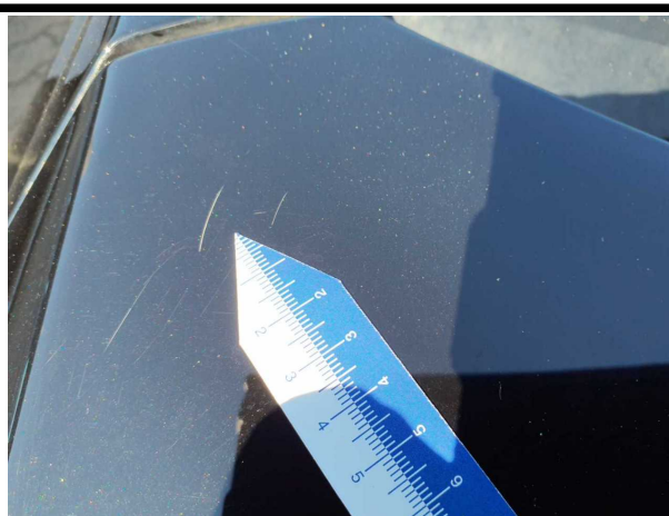
Beschädigung #8: Motorhaube: Motorhaube - Kratzer - lackieren
