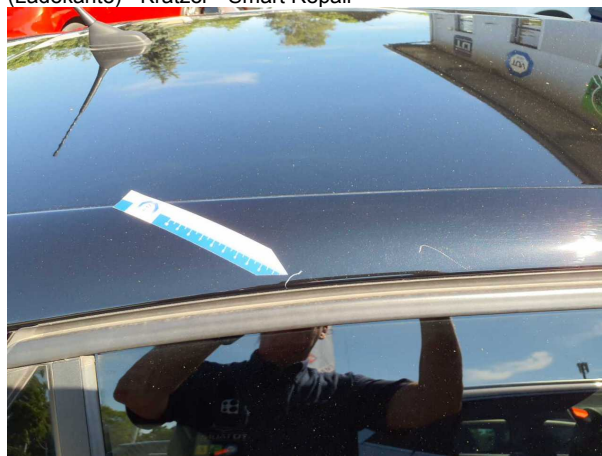
Beschädigung #3: Fahrzeugdach: Dachholm rechts - Kratzer - Smart Repair
