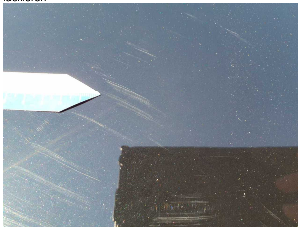
Beschädigung #8: Motorhaube: Motorhaube - Kratzer - lackieren
