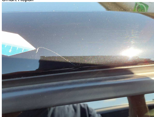
Beschädigung #3: Fahrzeugdach: Dachholm rechts - Kratzer - Smart Repair
