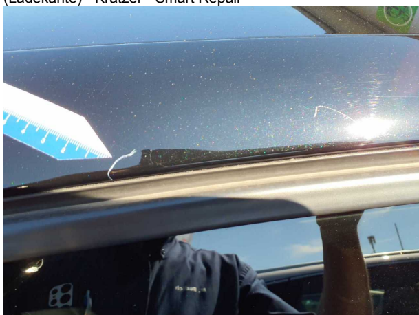
Beschädigung #3: Fahrzeugdach: Dachholm rechts - Kratzer - Smart Repair
