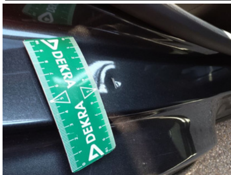
Entrée de porte / Arrière Droit / Enfoncement
