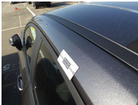
Montant de pavillon / Gauche / Malfaçon
