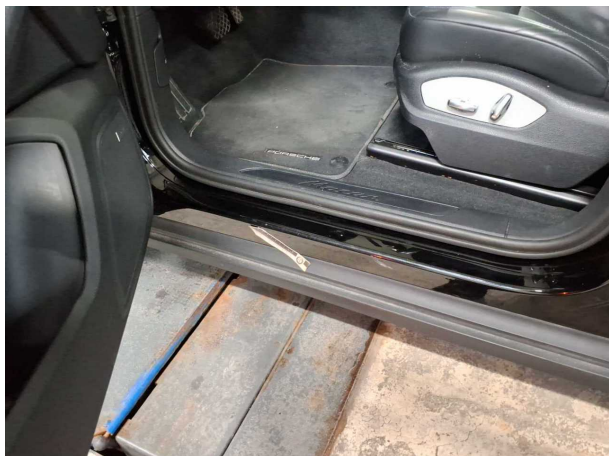
Beschädigung #1: Schweller links: Einstieg - Kratzer - Smart Repair
