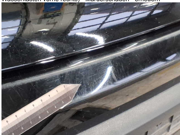
Beschädigung #7: Stossfänger hinten: Stossfänger hinten - verkratzt / verschürft - lackieren
