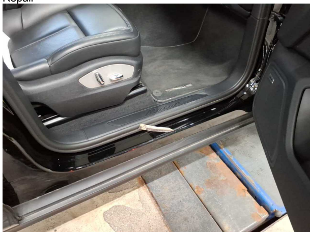
Beschädigung #2: Schweller rechts: Einstieg - Kratzer - Smart Repair
