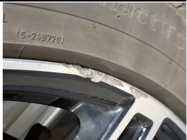
Beschädigung #10: Rad/Reifen: Leichtmetallfelge vorn rechts (Materialabrieb) - verformt - erneuern
