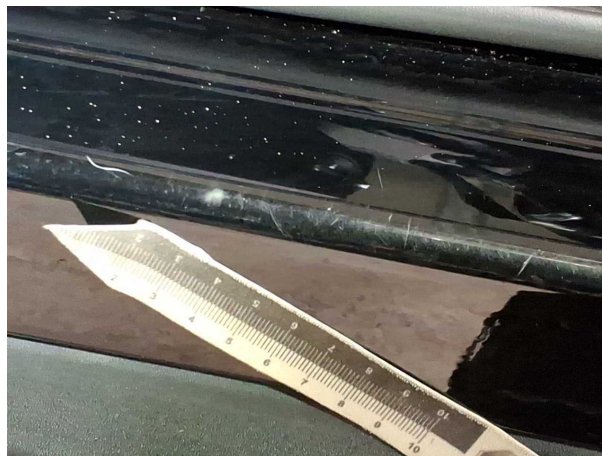
Beschädigung #1: Schweller links: Einstieg - Kratzer - Smart Repair
