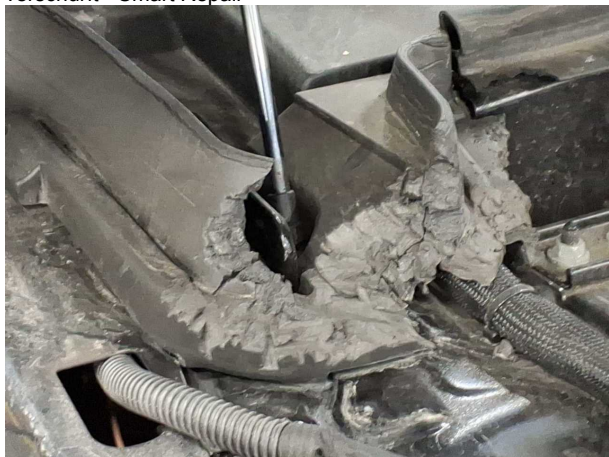
Beschädigung #6: Sonstiges: Sonstiges (Schaumteil Wasserkasten vorne rechts) - Marderschaden - erneuern
