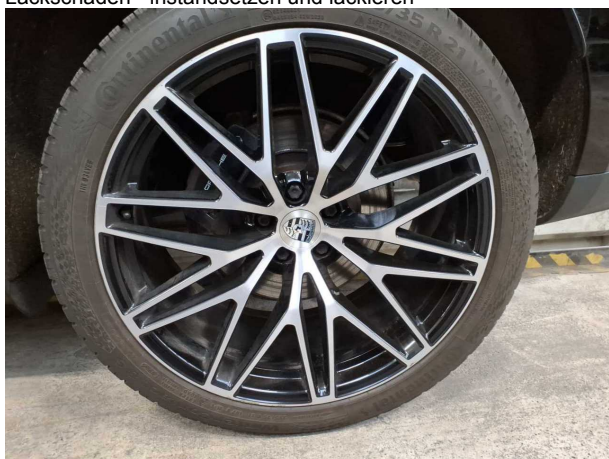
Beschädigung #9: Rad/Reifen: Leichtmetallfelge hinten links (Materialabrieb) - verkratzt / verschürft - erneuern
