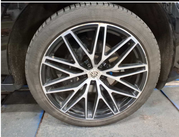
Beschädigung #10: Rad/Reifen: Leichtmetallfelge vorn rechts (Materialabrieb) - verformt - erneuern
