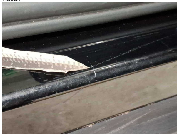
Beschädigung #2: Schweller rechts: Einstieg - Kratzer - Smart Repair
