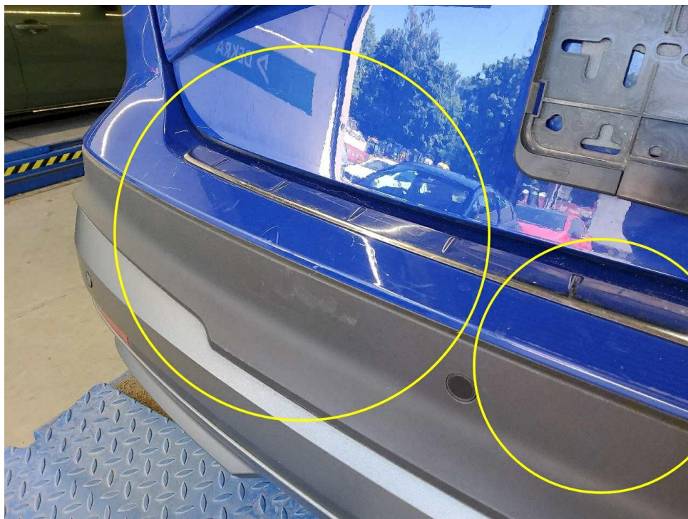
Bild 19 : Stoßfänger hinten lackierung verschrammt
