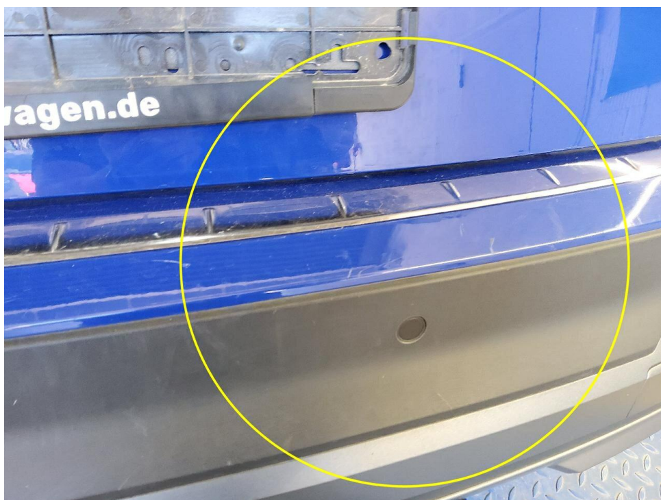
Bild 20 : Stoßfänger hinten lackierung verschrammt
