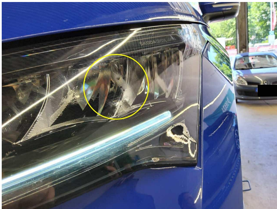
Bild 15 : Scheinwerfer links Reparatur Spuren
