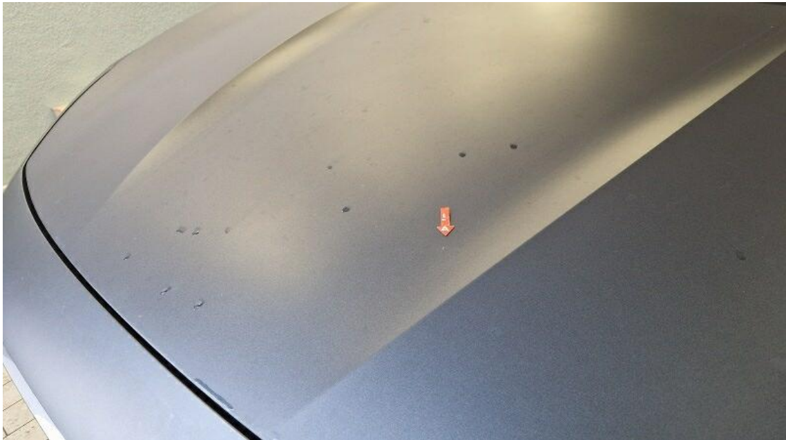
Bild 18 : Leichte Steinschläge im Frontbereich
