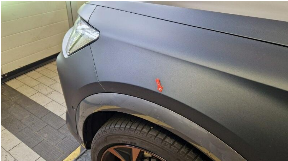
Bild 17 : Leichte Steinschläge im Frontbereich
