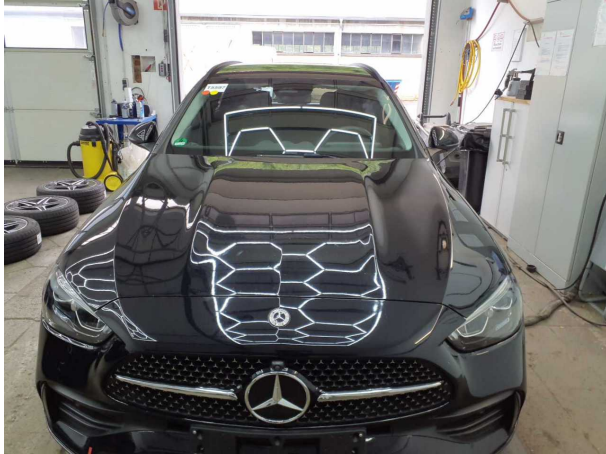
Beschädigung #1: Motorhaube: Motorhaube (Spaltmaße) - Fehlstellung - einstellen/justieren
