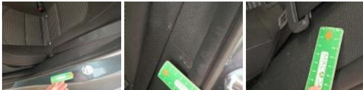
Bas de caisse int ARG, Bosse(s) et griffe(s), LI - Réparer et peindre (complet)
