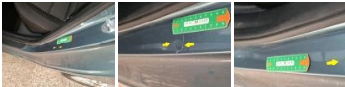
Bas de caisse int AVD, Bosse(s) et griffe(s), PDR - Débosselage ss peinture
