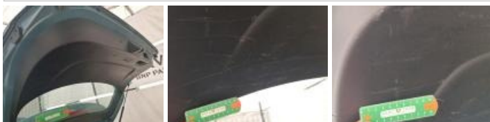
Garnit couvercle AR, Griffe(s), Réparer/rempl. (montant forfaitaire)
