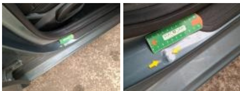
Bas de caisse int AVD, Bosse(s) et griffe(s), PDR - Débosselage ss peinture
