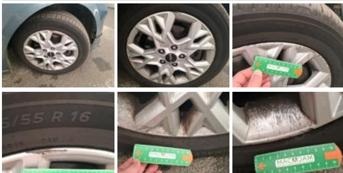
Jante alum. AVD, Griffe(s), Réparer/rempl. (montant forfaitaire)
