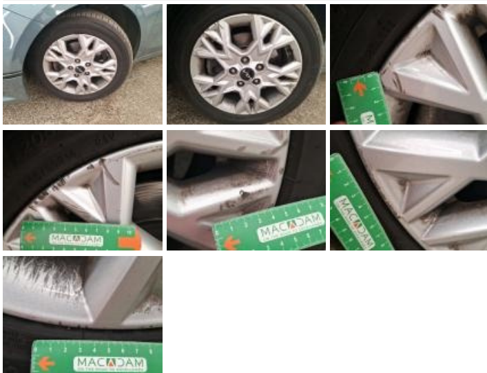
Jante alum. AVD, Griffe(s), Réparer/rempl. (montant forfaitaire)
