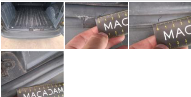
Joint de porte AR, Déchirure, E - Remplacer
