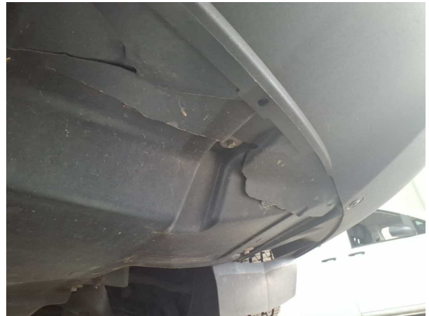
Beschädigung #6: Motor: Motorverkleidung unten (Mehrkosten möglich) - gebrochen / gerissen - erneuern
