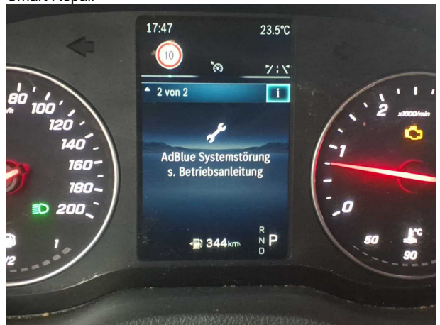
Beschädigung #4: Instrumententafel: Kontrollleuchte - leuchtet - Diagnose durchführen
