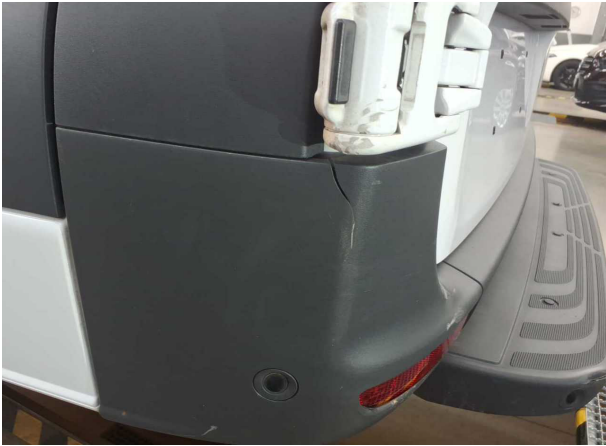
Beschädigung #8: Stossfänger hinten: Stossfänger hinten links - gebrochen / gerissen - erneuern
