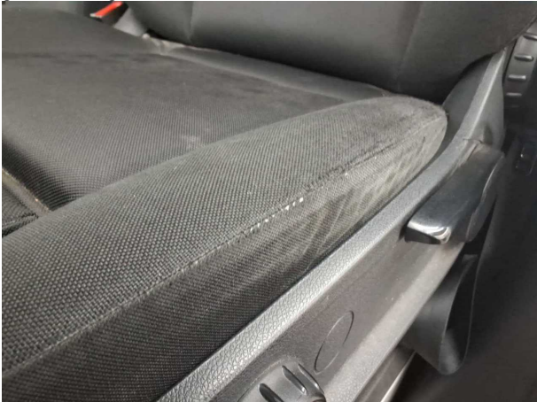
Beschädigung #10: Sitz vorn: Sitzbezug links - gebrochen / gerissen - erneuern
