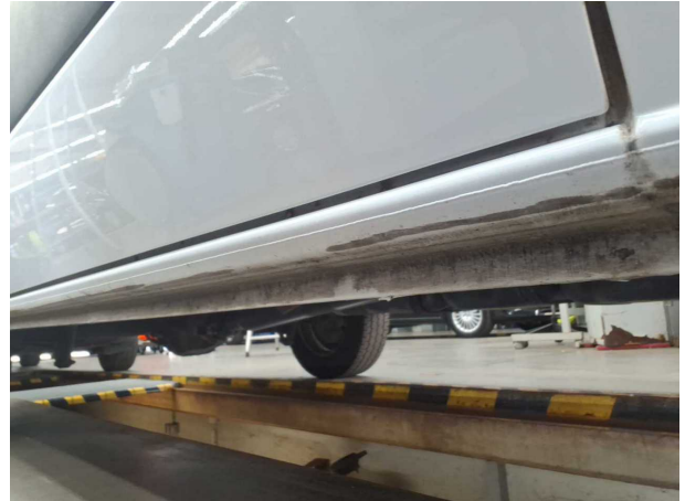
Beschädigung #11: Schweller rechts: Schweller Mitte - verkratzt / verschürft - lackieren
