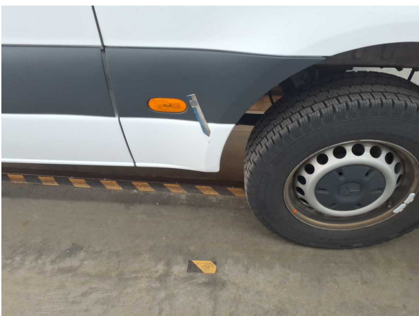
Beschädigung #7: Seitenwand links: Seitenwand (Bepankung unten mitte) - Delle / Lackschaden - instandsetzen und lackieren
