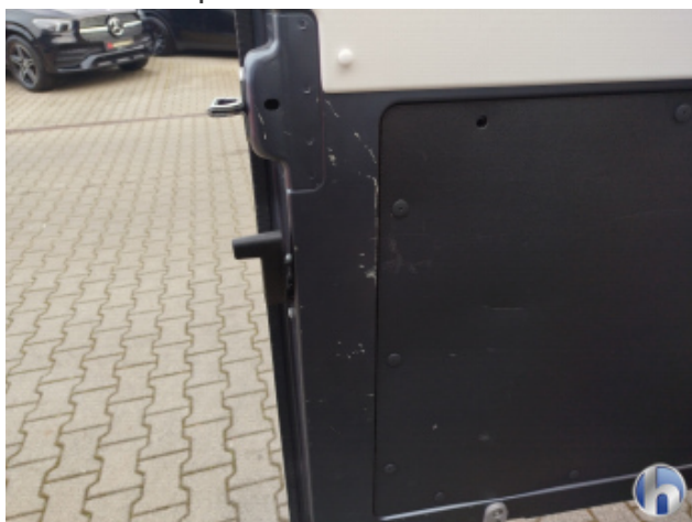
5. Türverkleidung Hinten - Links Kratzer - Smart Repair
