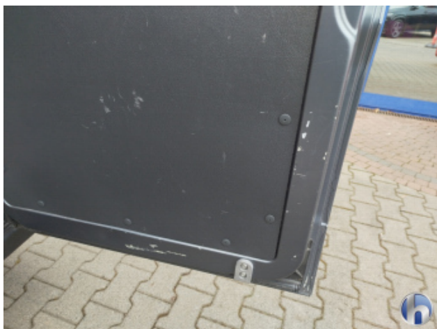
5. Türverkleidung Hinten - Links Kratzer - Smart Repair
