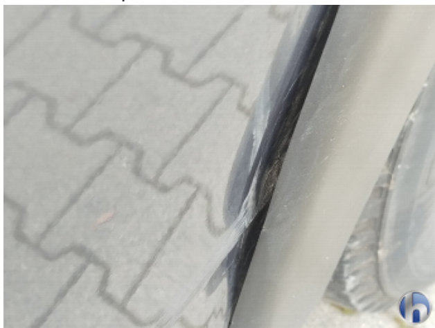
3. Seitenwand - Hinten - Links Beschädigt - Instandsetzen und Lackieren
