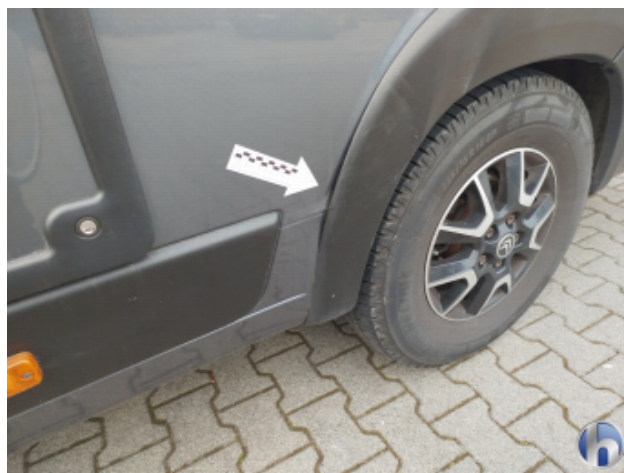
3. Seitenwand - Hinten - Links Beschädigt - Instandsetzen und Lackieren
