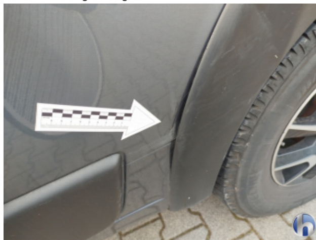
12. Radlaufverbreiterung li.hi. Abschürfung - Erneuern
