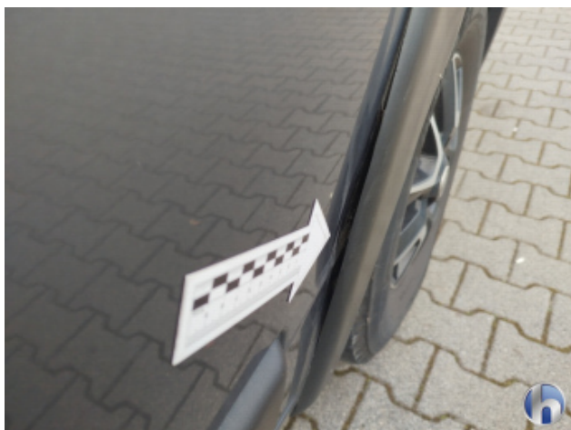
3. Seitenwand - Hinten - Links Beschädigt - Instandsetzen und Lackieren
