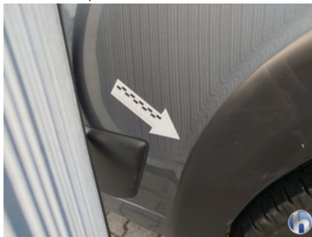
3. Seitenwand - Hinten - Links Beschädigt - Instandsetzen und Lackieren
