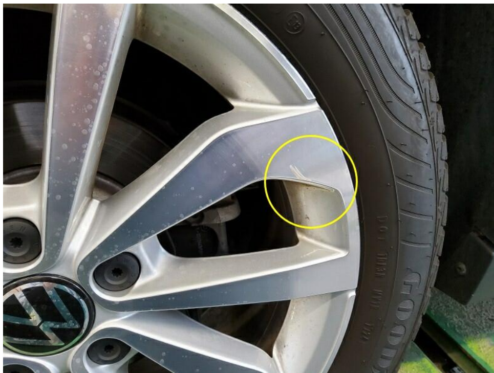
Bild 13 : Felge Hinterachse rechts verschrammt
