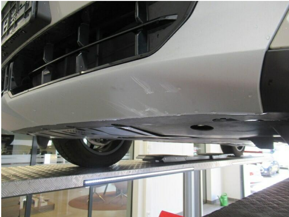
Bild 15 : Graue Blende Frontschürze verkratzt
