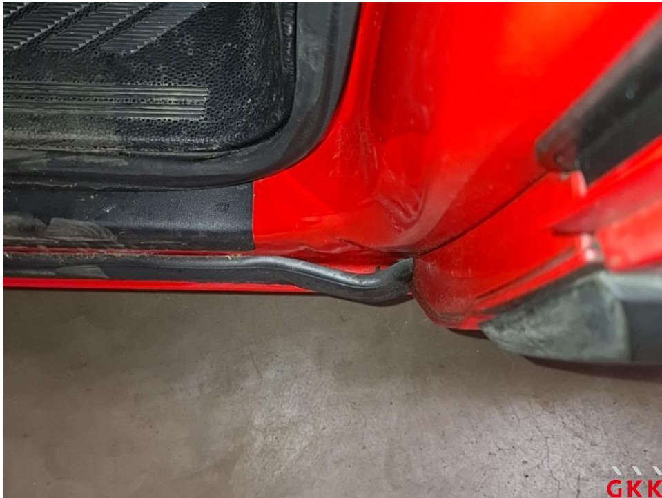
Bild 23 Tür vorne links, Dichtung -Einstieg-, beschädigt, ersetzen
