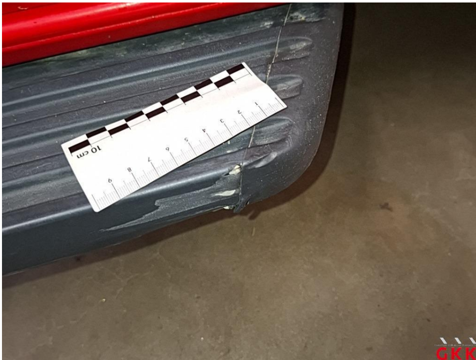
Bild 30 Trittstufe rechts, beschädigt, ersetzen
