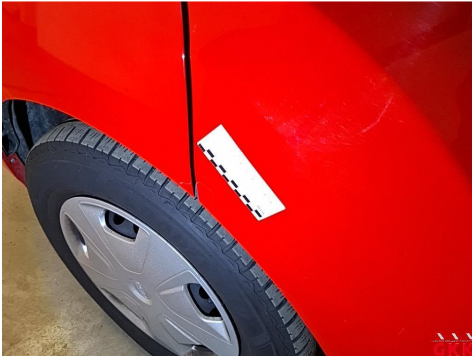
Bild 33 Tür vorne links, verkratzt, lackieren
