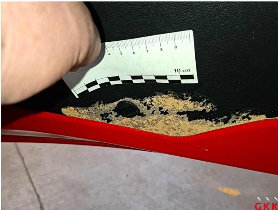
Bild 26 Hecktür rechts, Innenverkleidung, beschädigt, ersetzen
