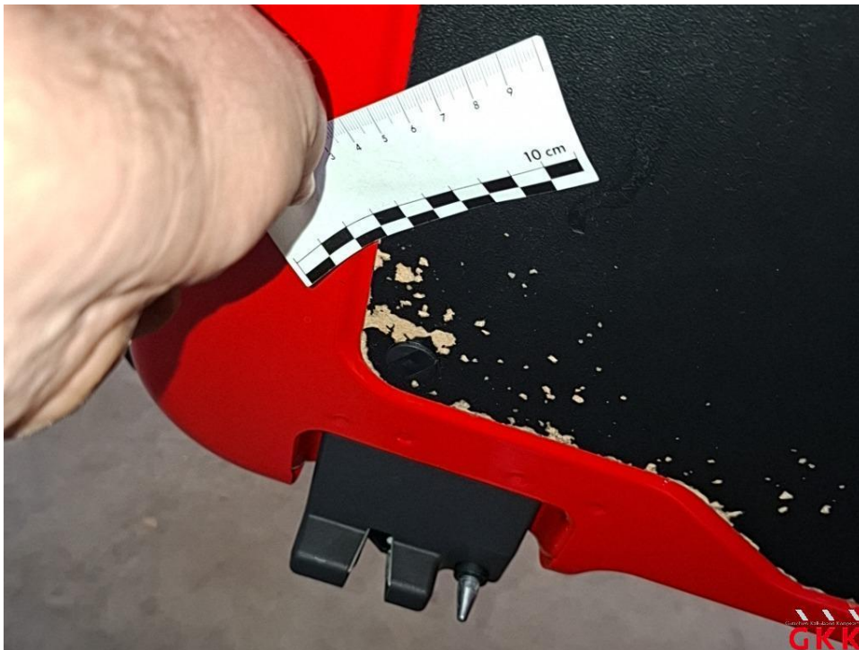
Bild 28 Hecktür links, Innenverkleidung, beschädigt, ersetzen
