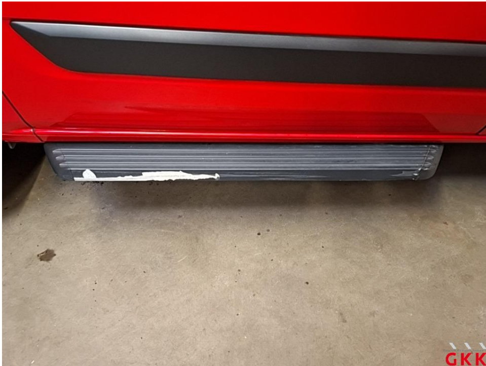
Bild 29 Trittstufe rechts, beschädigt, ersetzen
