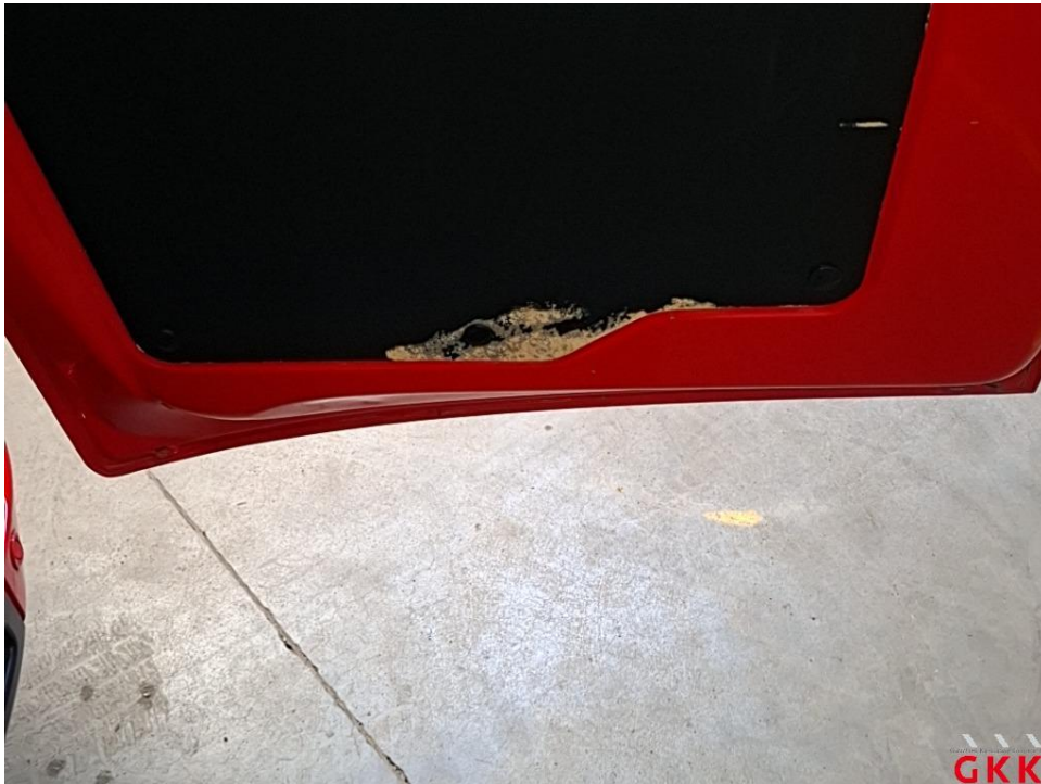
Bild 25 Hecktür rechts, Innenverkleidung, beschädigt, ersetzen
