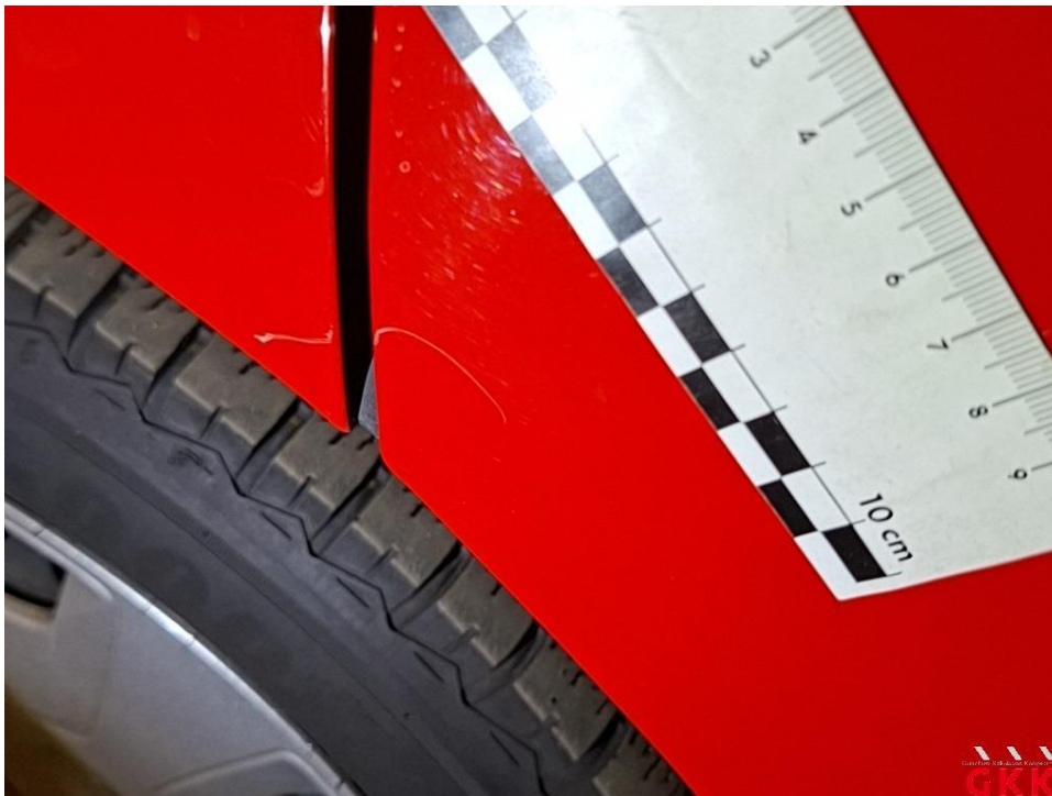
Bild 34 Tür vorne links, verkratzt, lackieren
