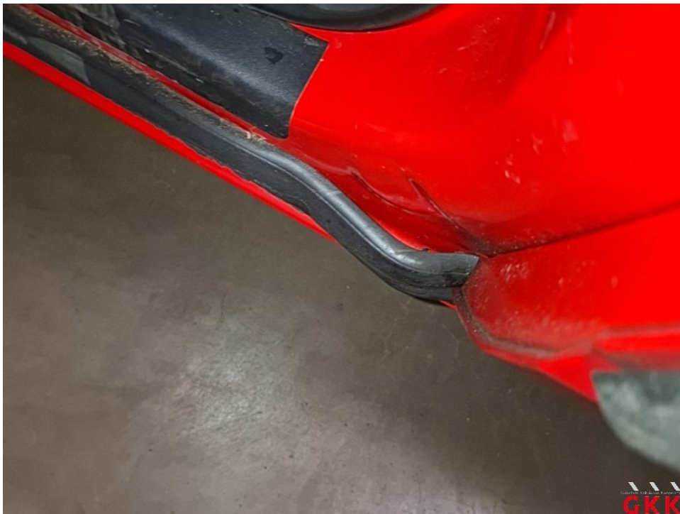
Bild 24 Tür vorne links, Dichtung -Einstieg-, beschädigt, ersetzen
