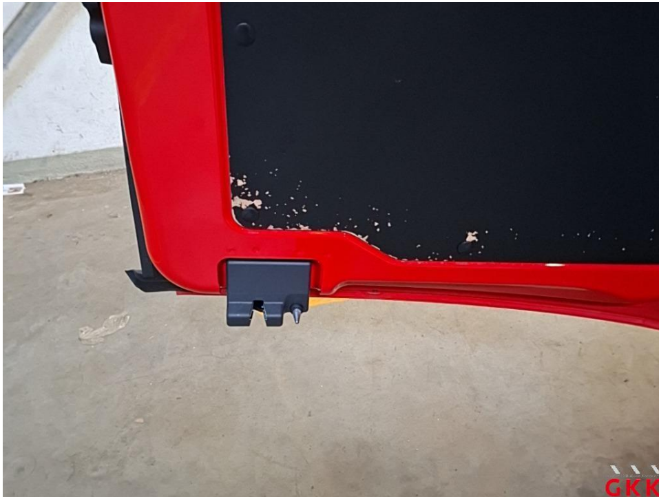
Bild 27 Hecktür links, Innenverkleidung, beschädigt, ersetzen
