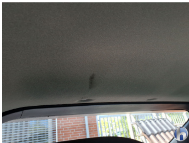
1. Dachhimmel Verschmutzt - Reinigen
