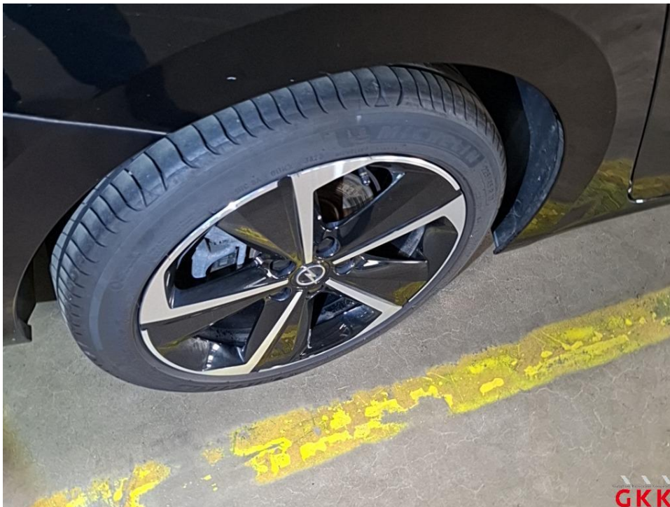
Bild 32 LM-Rad, hinten rechts, Materialabtrag, ersetzen
