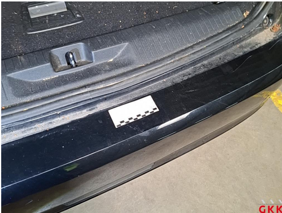
Bild 30 Stoßfänger hinten, Verkleidung -lackiert-, verkratzt, lackieren
