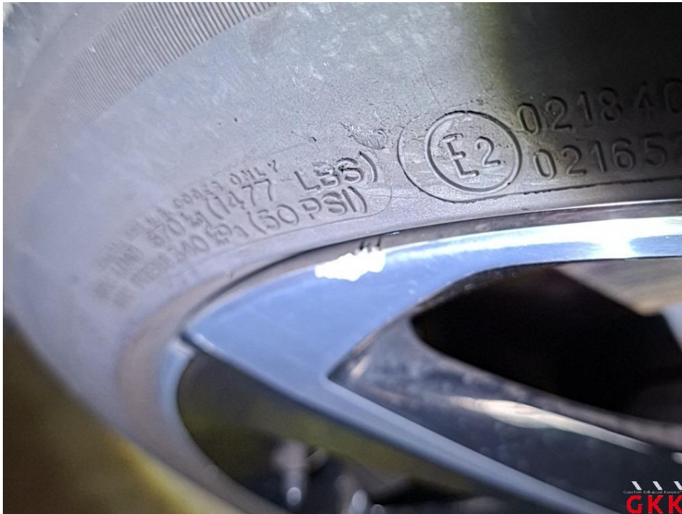
Bild 21 LM-Rad, vorne rechts, Materialabtrag, ersetzen
