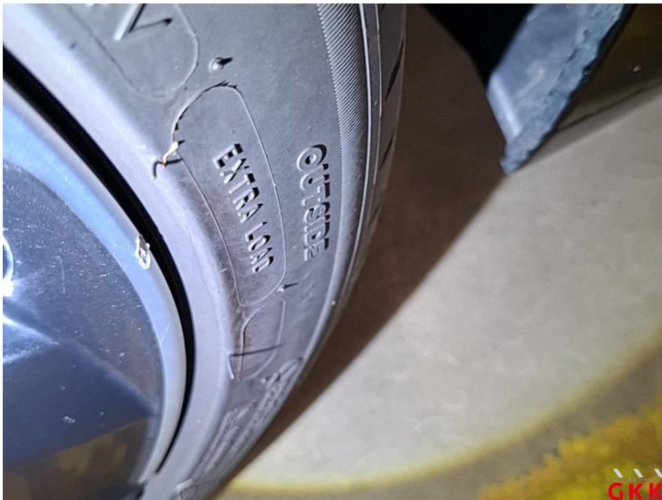
Bild 34 LM-Rad, hinten rechts, Materialabtrag, ersetzen
