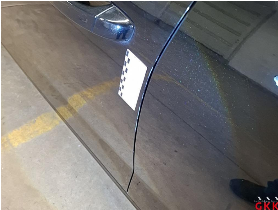
Bild 29 Tür vorne links, Kante, verkratzt, Smartrepair
