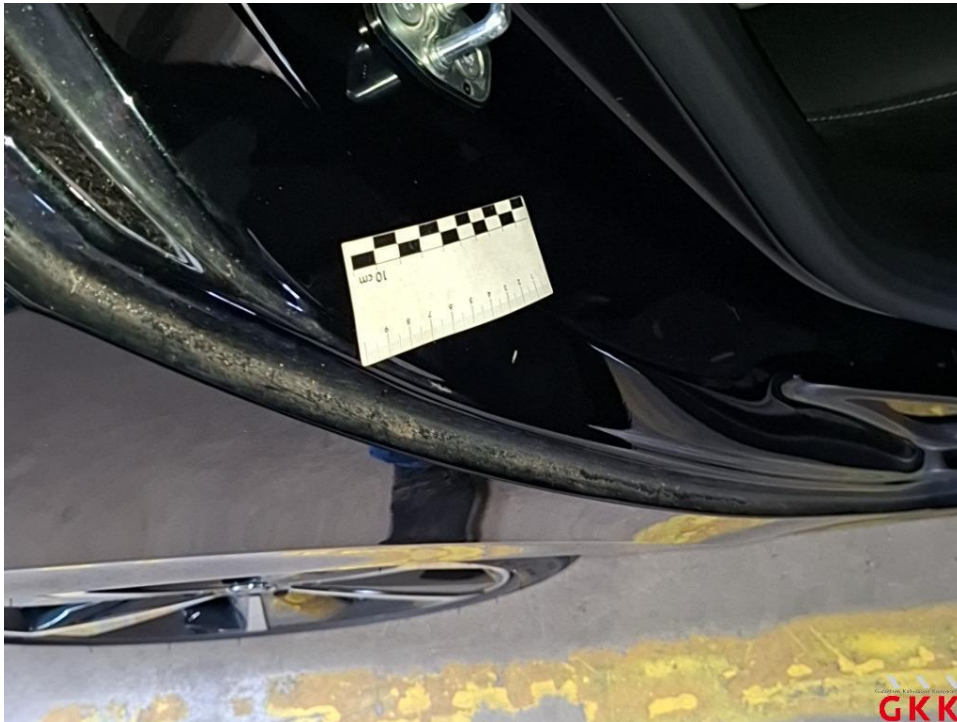
Bild 39 Tür hinten rechts, Einstieg, verkratzt, auslegen, schleifen, polieren
