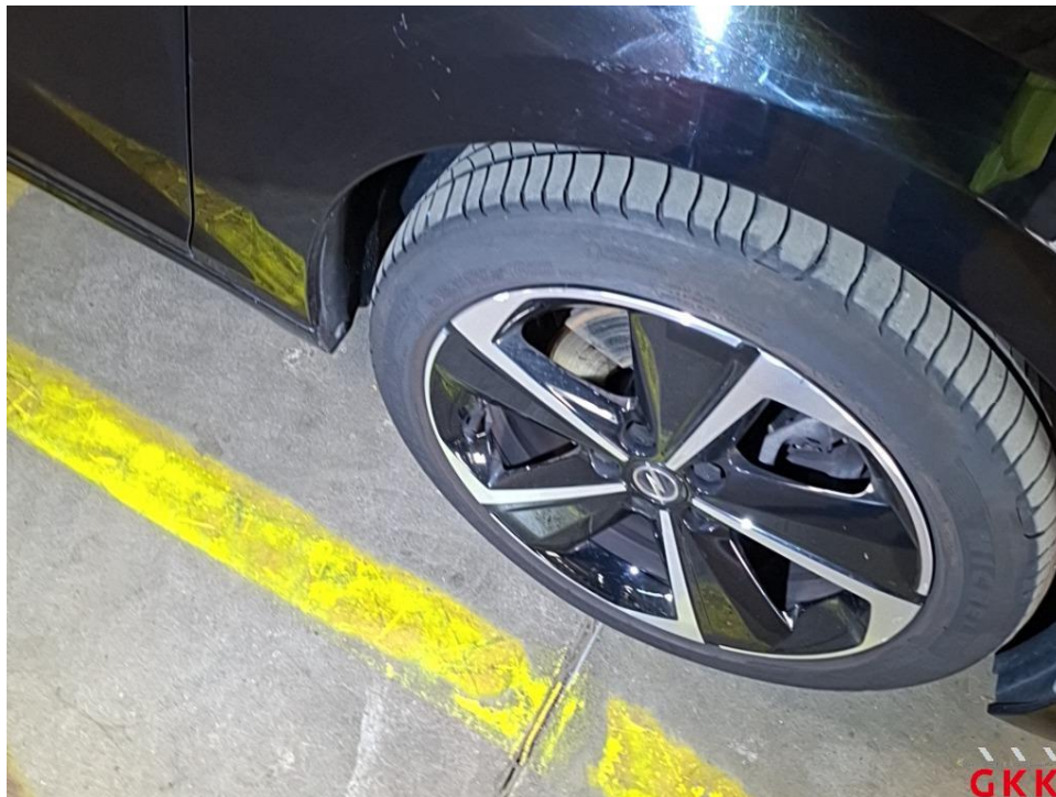
Bild 20 LM-Rad, vorne rechts, Materialabtrag, ersetzen
