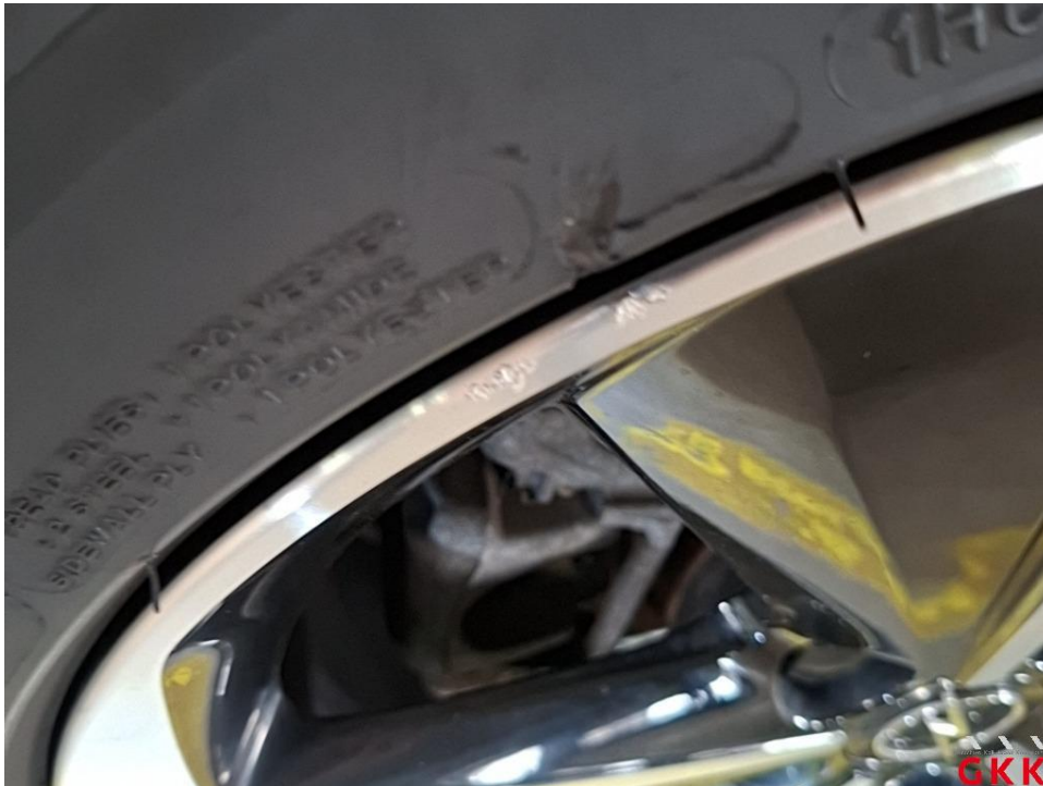
Bild 33 LM-Rad, hinten rechts, Materialabtrag, ersetzen
