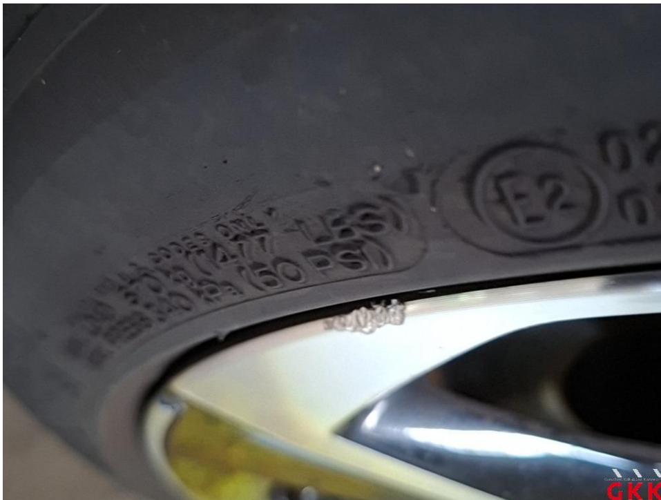
Bild 22 LM-Rad, vorne rechts, Materialabtrag, ersetzen
