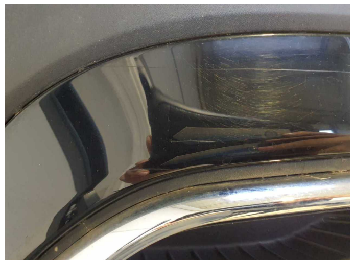
Damage 9: Rear bumper: Rear bumper (Zusätzlich Zierleiste Kratzer) - Dent / paintcoat damage - Repair and paint
