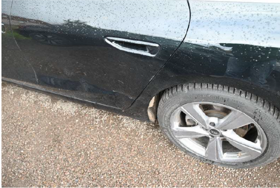
Bild 19 Altschaden: Tür und Seitenwand links hinten gedellt
