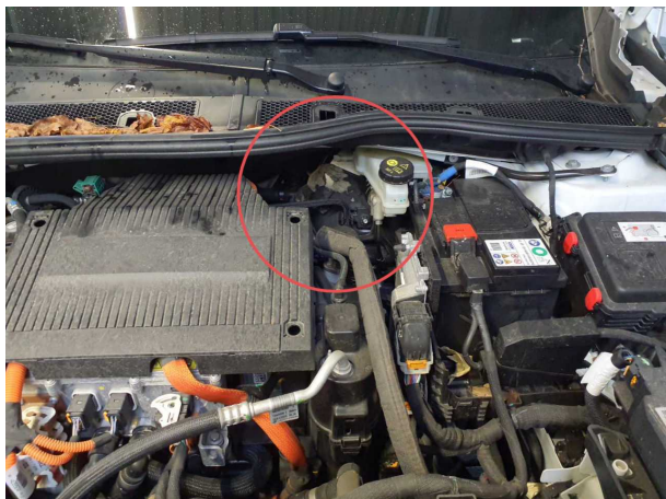
Beschädigung #1: Fahrerhaus: Dämmmatte - Marderschaden - erneuern
