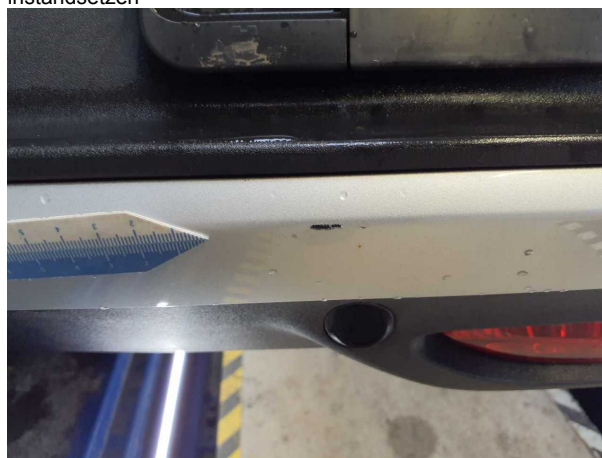
Beschädigung #3: Stoßfänger hinten: Spoiler - Kratzer - Smart Repair
