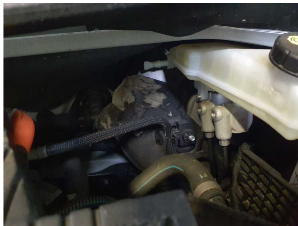
Beschädigung #1: Fahrerhaus: Dämmmatte - Marderschaden - erneuern
