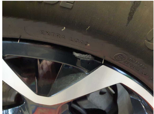
Beschädigung #4: Rad/Reifen: Leichtmetallfelge vorn rechts - verformt - erneuern
