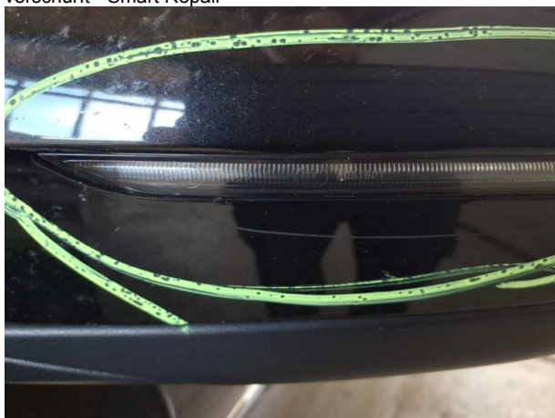
Beschädigung #4: Außenspiegel links: Abdeckkappe - verkratzt / verschürft - Smart Repair
