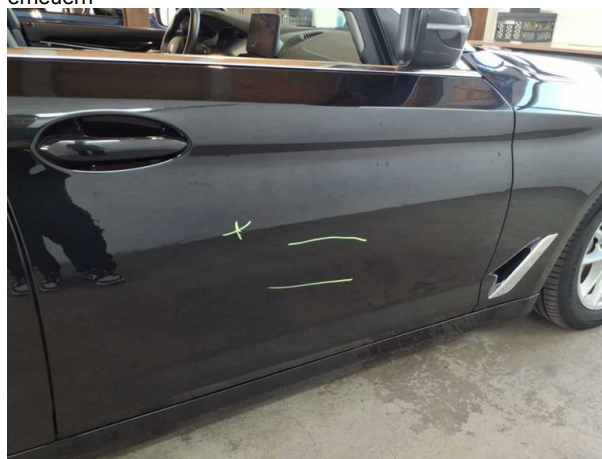
Beschädigung #6: Tür vorn rechts: Tür - nicht fachgerecht instandgesetzt - instandsetzen und lackieren
