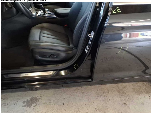
Beschädigung #3: Schweller links: Einstieg - Kratzer - auslegen / polieren
