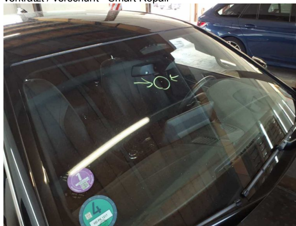
Beschädigung #5: Verglasung: Frontscheibe - Steinschlag - erneuern
