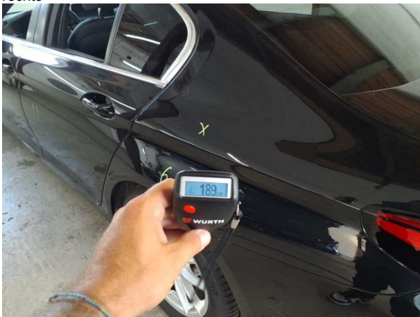
Nachlackierung 1: Heckklappe/-tür, Seitenwand links, Tür vorne rechts
