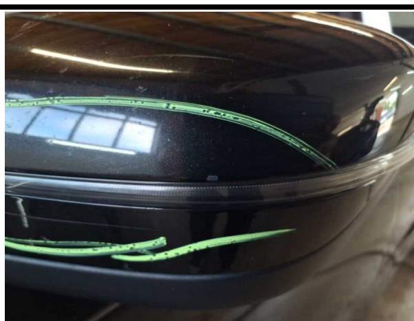
Beschädigung #4: Außenspiegel links: Abdeckkappe - verkratzt / verschürft - Smart Repair
