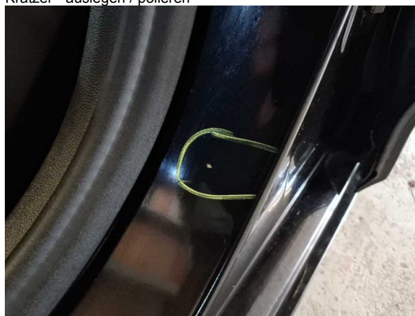
Beschädigung #3: Schweller links: Einstieg - Kratzer - auslegen / polieren
