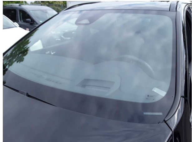
Beschädigung #5: Verglasung: Frontscheibe (im Sichtfeld) - Steinschlag - erneuern
