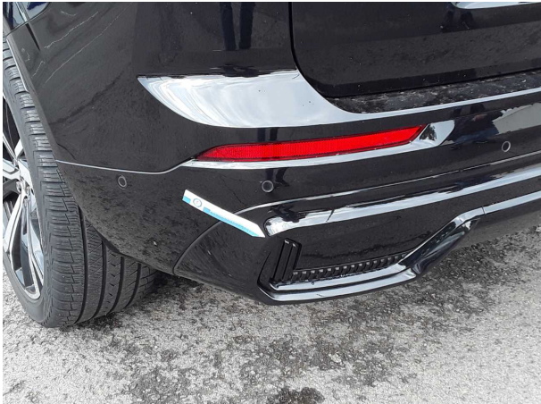
Beschädigung #1: Stossfänger hinten: Stossfänger hinten links - nicht fachgerecht instandgesetzt - lackieren
