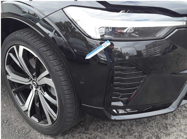
Beschädigung #2: Stossfänger vorn: Stossfänger vorn rechts - verkratzt / verschürft - lackieren
