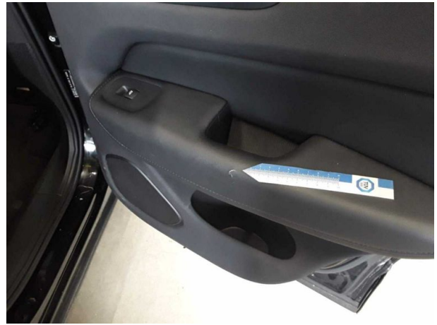
Beschädigung #6: Verkleidungen/Abdeckungen: Türverkleidung hinten rechts - gebrochen / gerissen - erneuern
