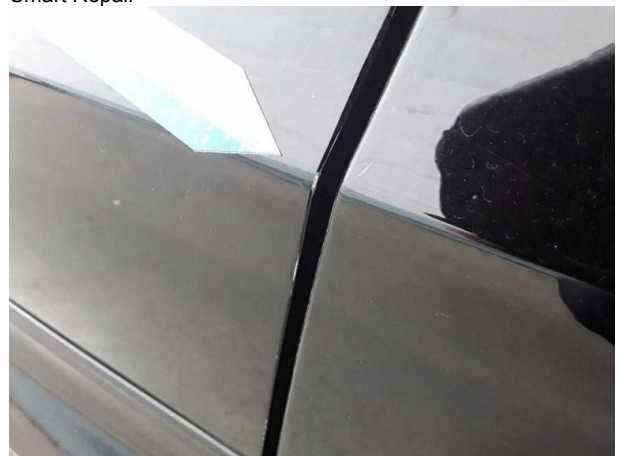
Beschädigung #3: Tür vorn links: Türkante - verkratzt / verschürft - Smart Repair
