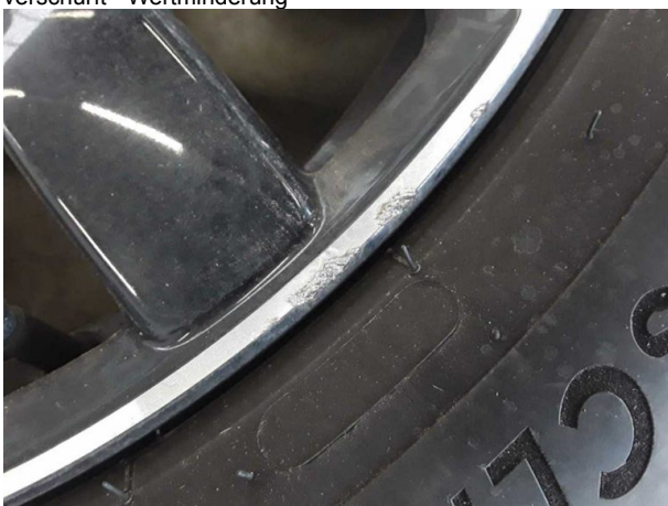
Beschädigung #5: 2.Radsatz: 1 Leichtmetallfelge - verkratzt / verschürft - Wertminderung
