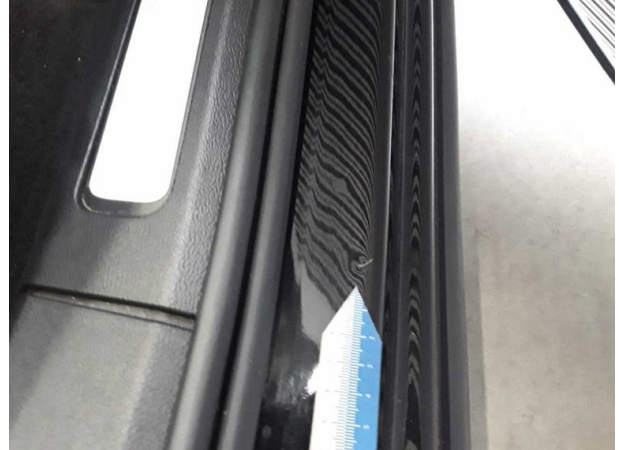
Beschädigung #1: Schweller rechts: Einstieg - Delle(n) - Sm... Repair
