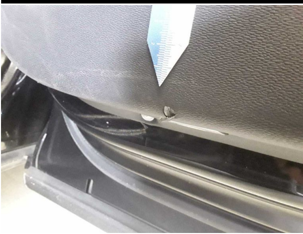
Beschädigung #6: Verkleidungen/Abdeckungen: Türverkleidung hinten rechts - gebrochen / gerissen - erneuern
