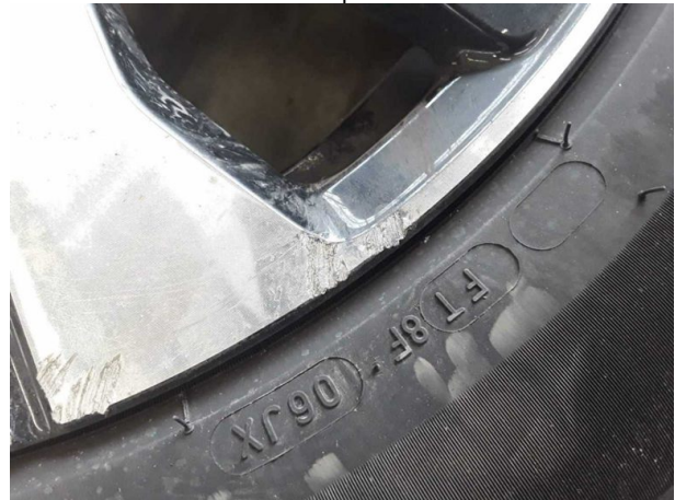
Beschädigung #5: 2.Radsatz: 1 Leichtmetallfelge - verkratzt / verschürft - Wertminderung
