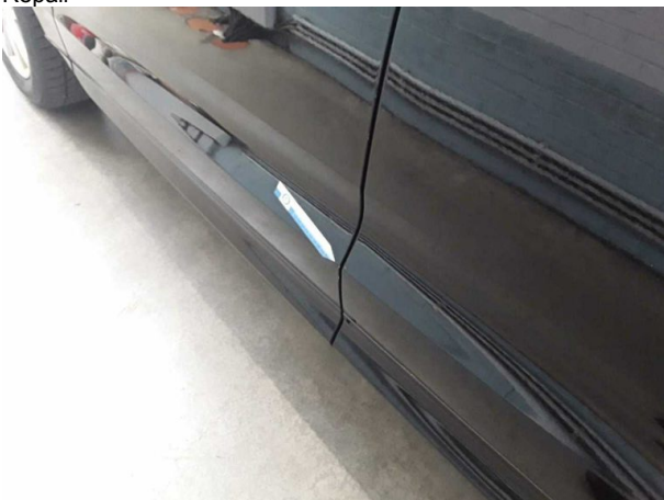
Beschädigung #3: Tür vorn links: Türkante - verkratzt / verschürf... Smart Repair
