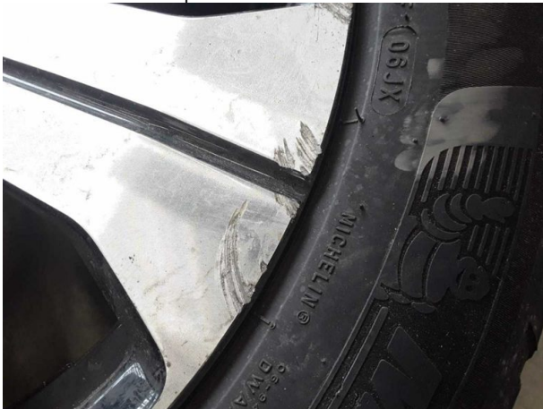
Beschädigung #5: 2.Radsatz: 1 Leichtmetallfelge - verkratzt / verschürft - Wertminderung
