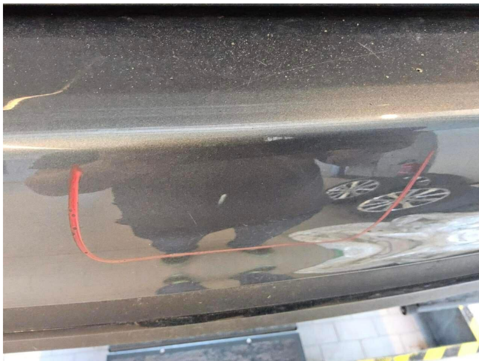
Bild 16 : Stoßfänger hinten Lackierung, verschrammt, smart repair
