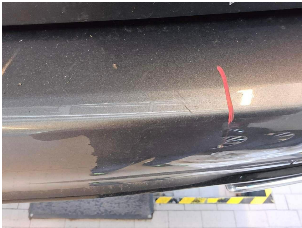
Bild 15 : Stoßfänger hinten Lackierung, verschrammt, smart repair
