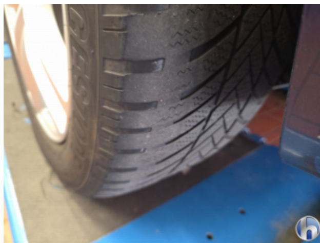
7. Reifen Hinten - Links Nicht Verkehrssicher - Erneuern
