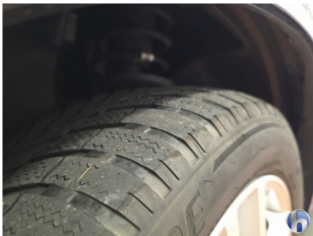
8. Reifen Vorne - Links Nicht Verkehrssicher - Erneuern
