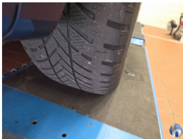
6. Reifen Hinten - Rechts Nicht Verkehrssicher - Erneuern
