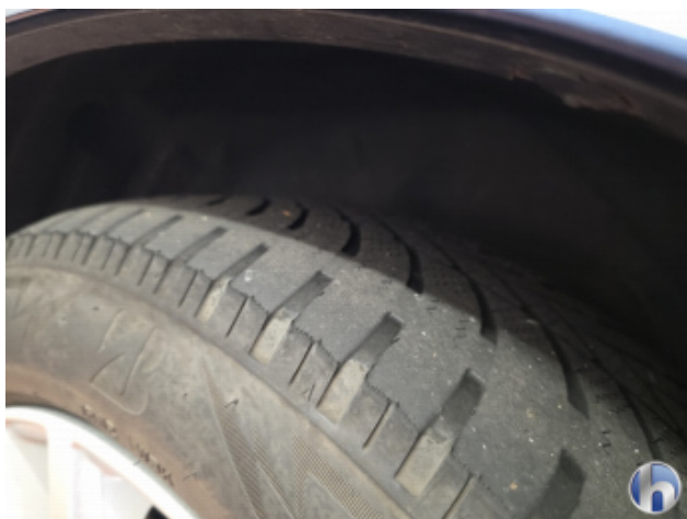
7. Reifen Hinten - Links Nicht Verkehrssicher - Erneuern
