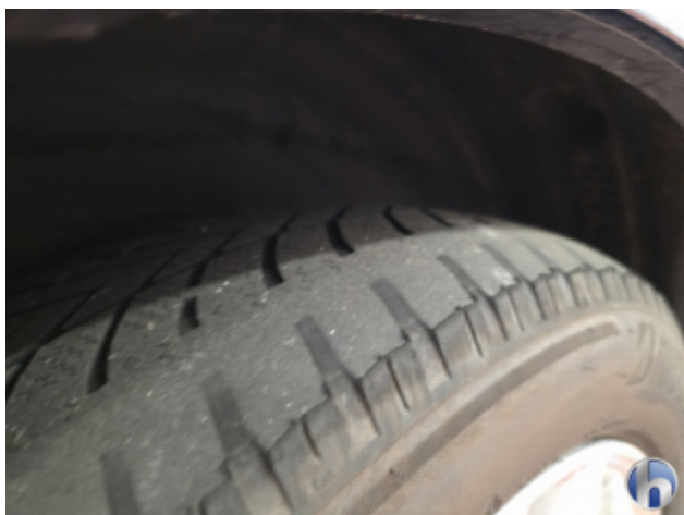
6. Reifen Hinten - Rechts Nicht Verkehrssicher - Erneuern
