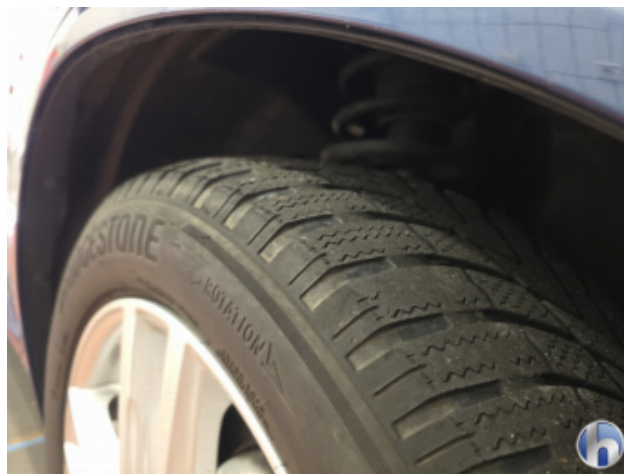
9. Reifen Vorne - Rechts Nicht Verkehrssicher - Erneuern
