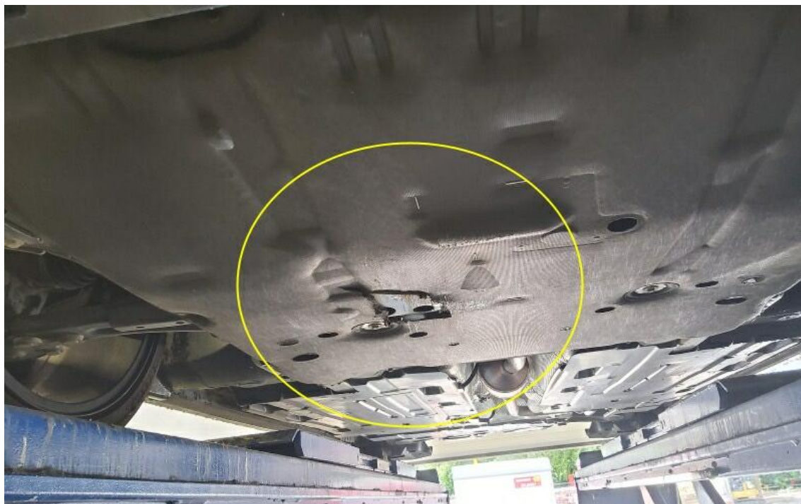
Bild 11 : Unterboden, Unterfahrschutz vorne und mitte + Vorderachsträge streifend verschrammt
