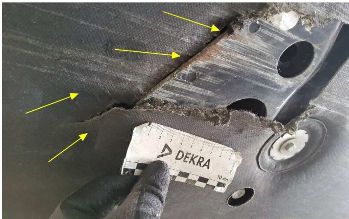
Bild 12 : Unterboden, Unterfahrschutz vorne und mitte + Vorderachsträge streifend verschrammt
