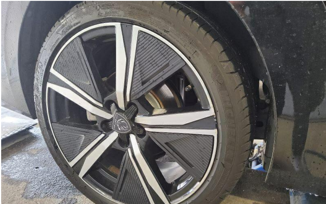
Bild 17 : Felge hinten rechts (glanzgedreht), zerkratzt
