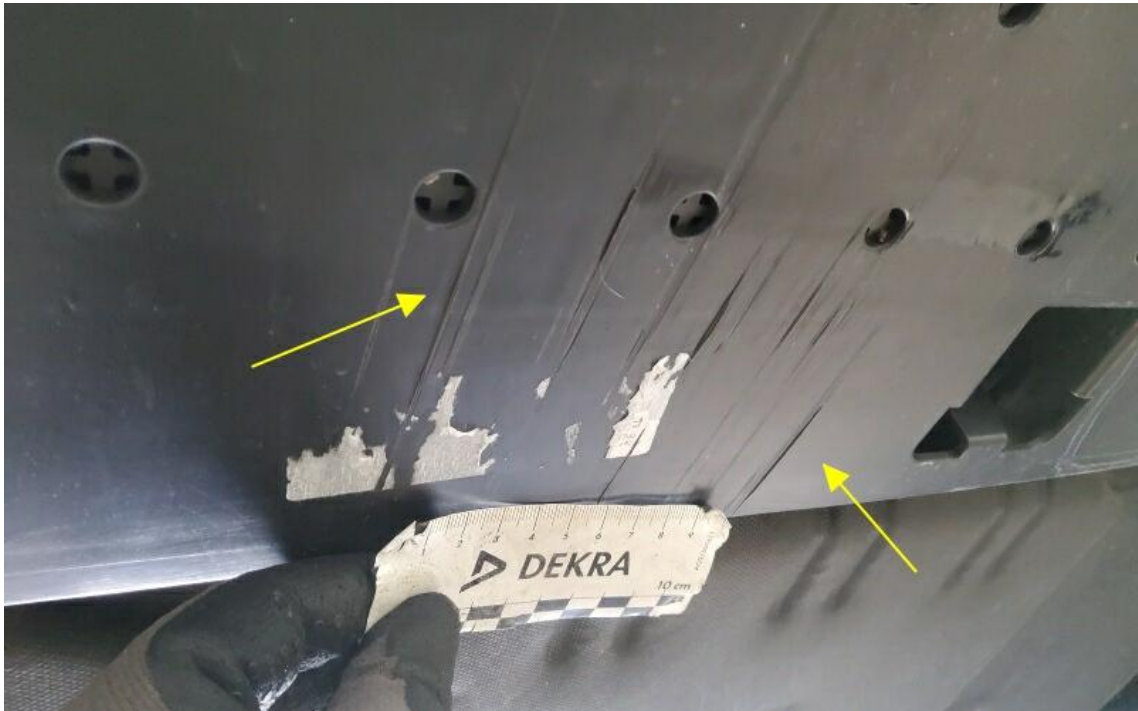
Bild 13 : Unterboden, Unterfahrschutz vorne und mitte + Vorderachstrage streifend verschrammt
