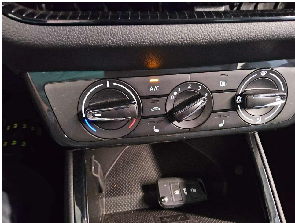
Bild 14 : Innenraumlüfter und Klimaanlage funktionieren nur auf Stufe 4
