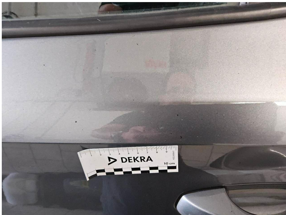
Bild 16 : Kompletter Fahrzeuglack mit schwarzen eingebrannten Pickeln überzogen
