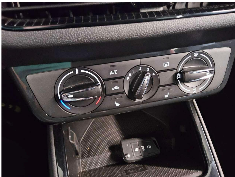
Bild 13 : Innenraumlüfter und Klimaanlage funktionieren nur auf Stufe 4
