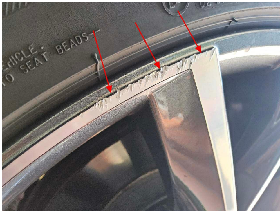
Bild 18 : Felge vorne rechts beschädigt
