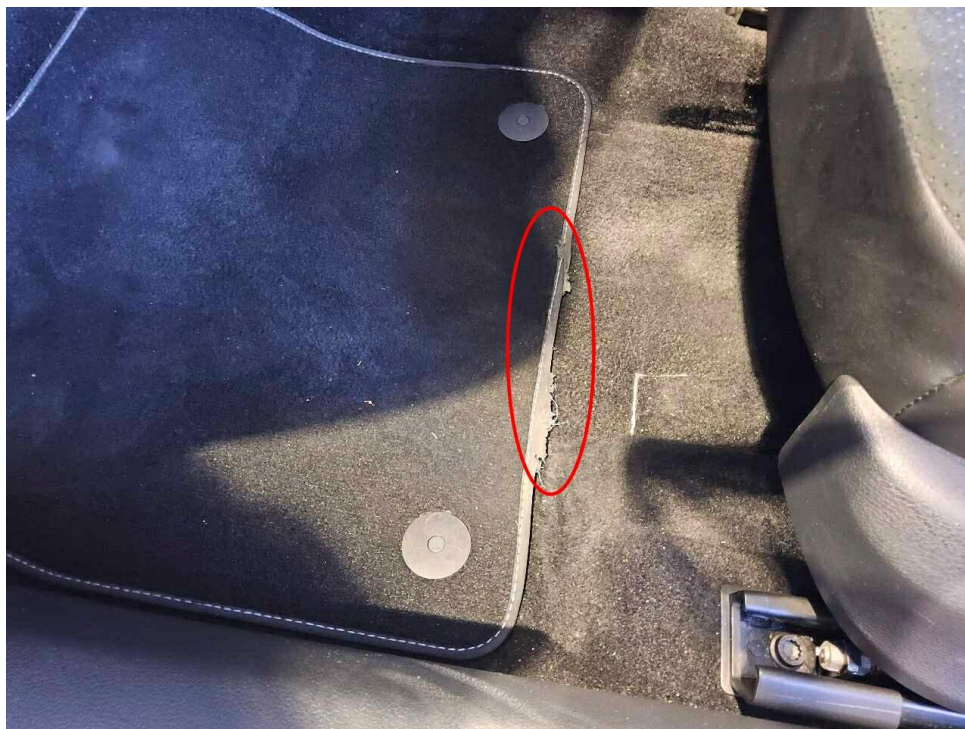
Bild 15 : Fußmatte vorne links beschädigt
