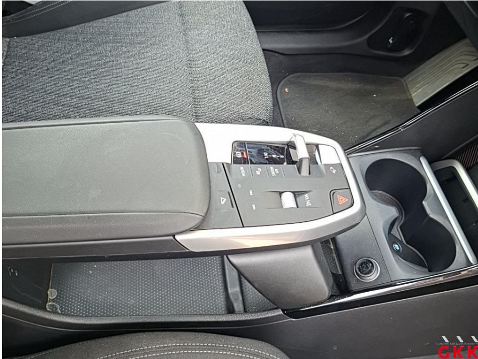
Bild 13. Mittelkonsole, Blende, beschädigt, ersetzen
