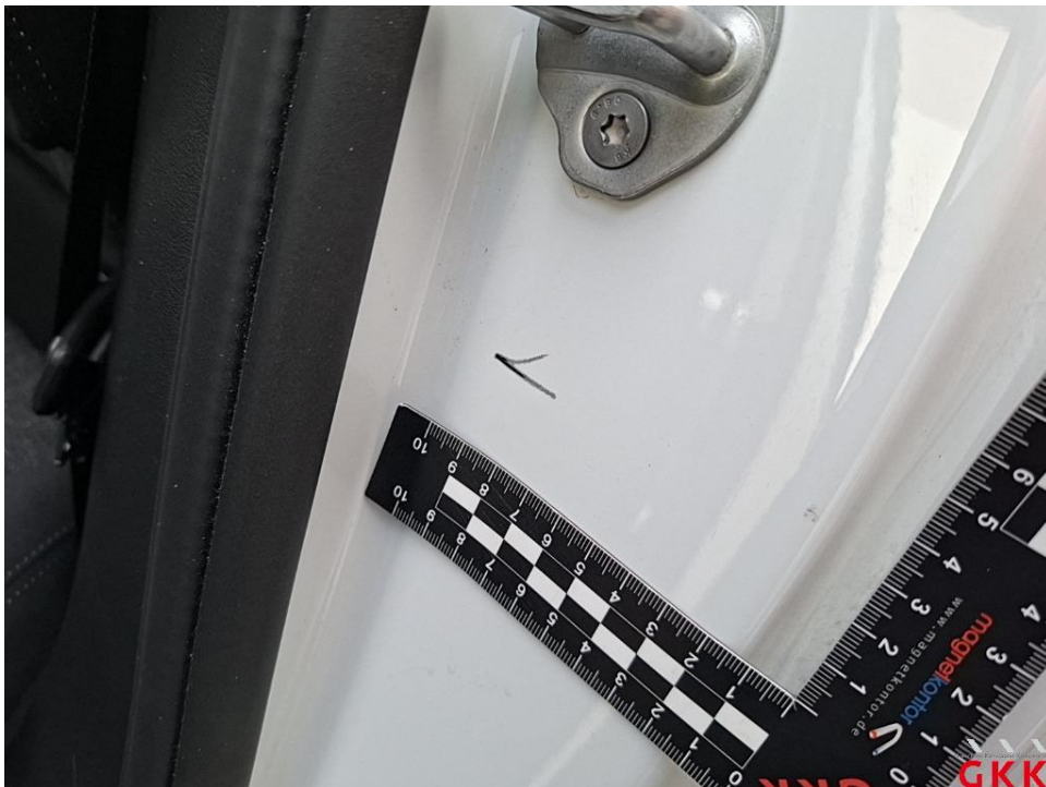
Bild 22. Tür hinten links, Einstieg, verkratzt, lackieren
