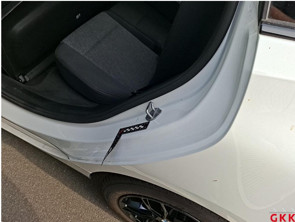
Bild 21. Tür hinten links, Einstieg, verkratzt, lackieren
