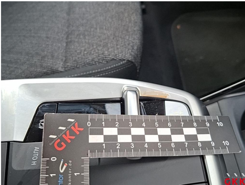
Bild 14. Mittelkonsole, Blende, beschädigt, ersetzen
