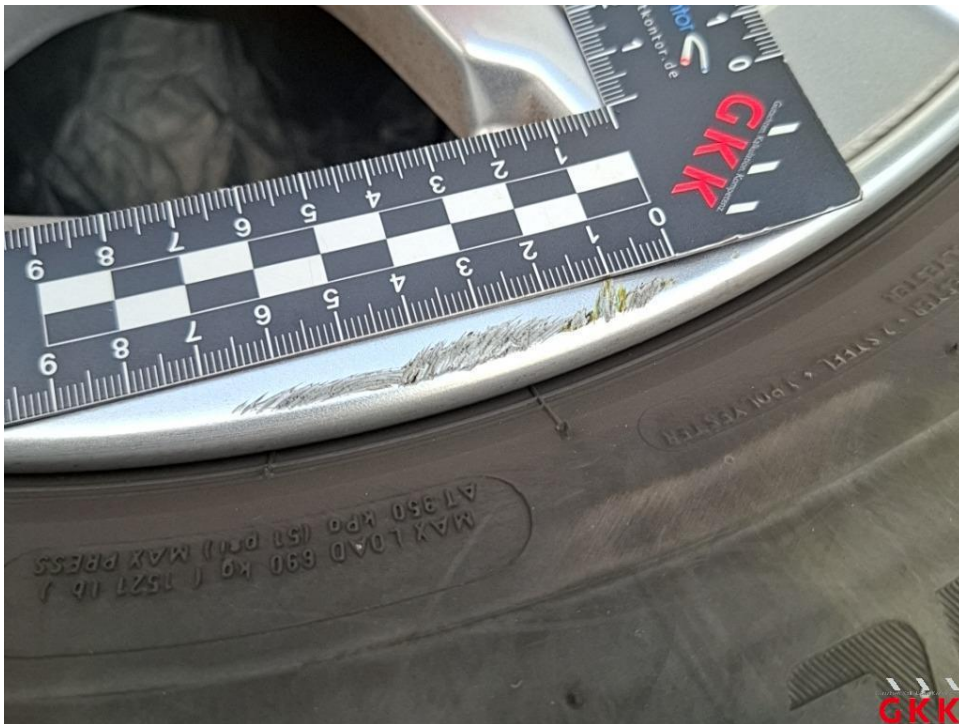
Bild 24. LM-Rad, 1 x beiliegend, Materialabtrag, ersetzen
