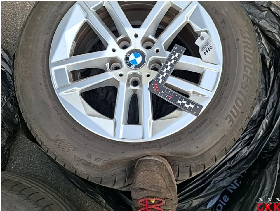
Bild 27. Reifen, 1 x beiliegend, Luftdruck zu gering / drucklos, ersetzen
