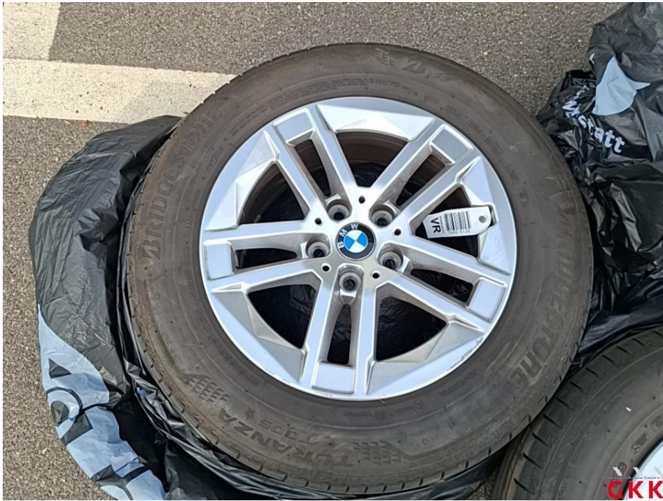
Bild 23. LM-Rad, 1 x beiliegend, Materialabtrag, ersetzen
