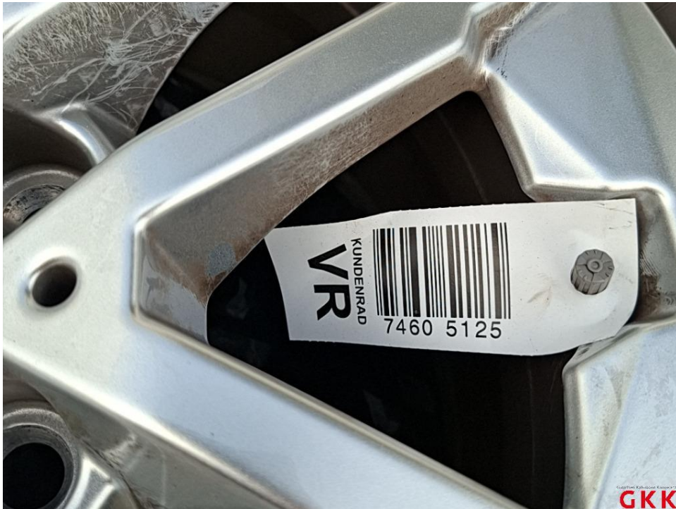
Bild 25. LM-Rad, 1 x beiliegend, Materialabtrag, ersetzen
