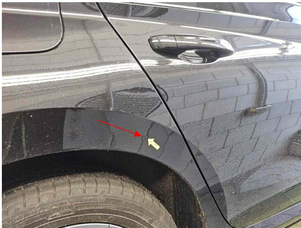
Bild 18 : Seitenteil links eingedellt
