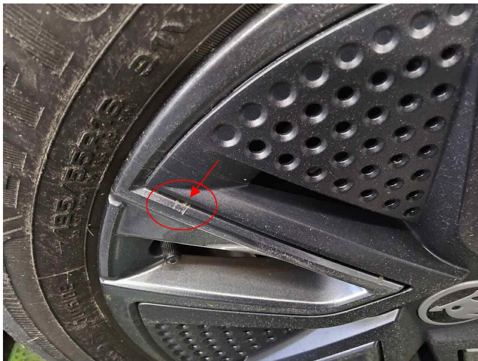
Bild 17 : Felge hinten links verschrammt
