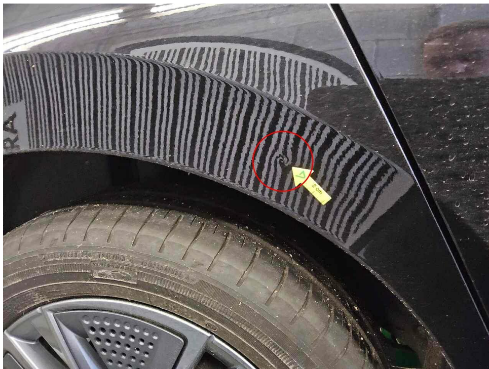
Bild 19 : Seitenteil links eingedellt
