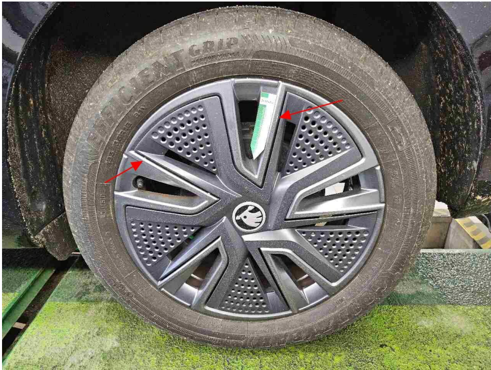
Bild 15 : Felge hinten links verschrammt
