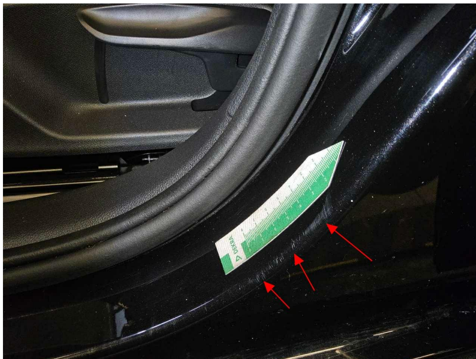
Bild 13 : Tür vorne links Einstieg zerkratzt
