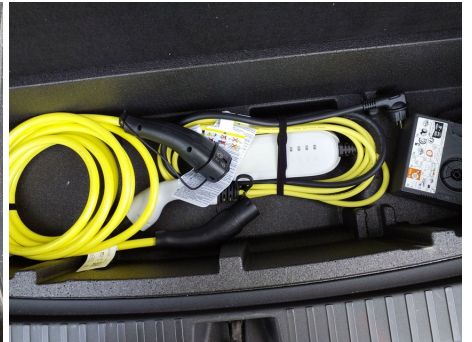
Elementos faltantes / Cable de carga lenta (Type 2, Mode 2)
