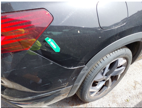
Aleta / Trasero Derecho / Abolladura
