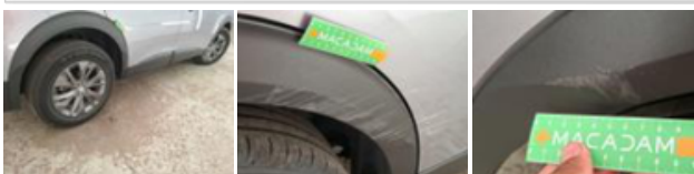
Moulure d'aile ARD, Déformé / Forcé, E - Remplacer
