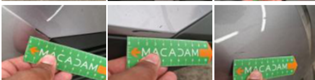
Moulure d'aile ARD, Déformé / Forcé, E - Remplacer
