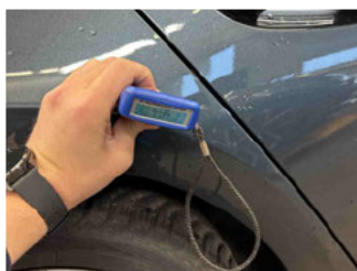
Lackstärke Seitenwand hinten rechts
