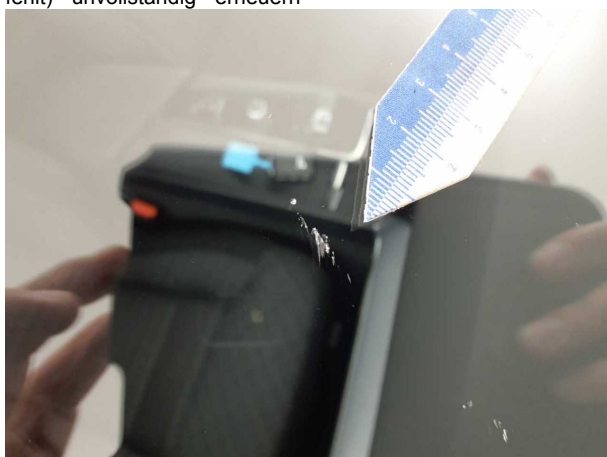
Beschädigung #3: Verglasung: Frontscheibe - Kratzer - erneuern
