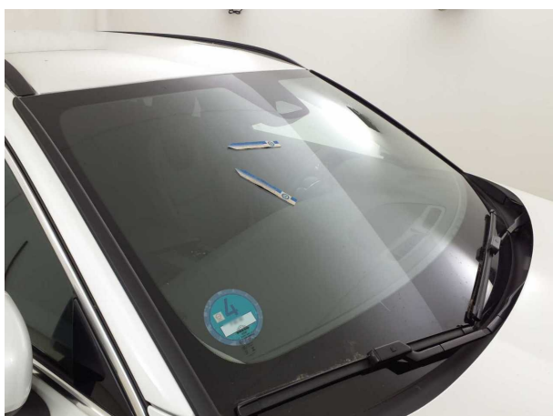
Beschädigung #3: Verglasung: Frontscheibe - Kratzer - erneuern
