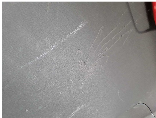
Beschädigung #1: Verkleidungen/Abdeckungen: Heckdeckel, Innenverkleidung - verkratzt / verschürft - erneuern
