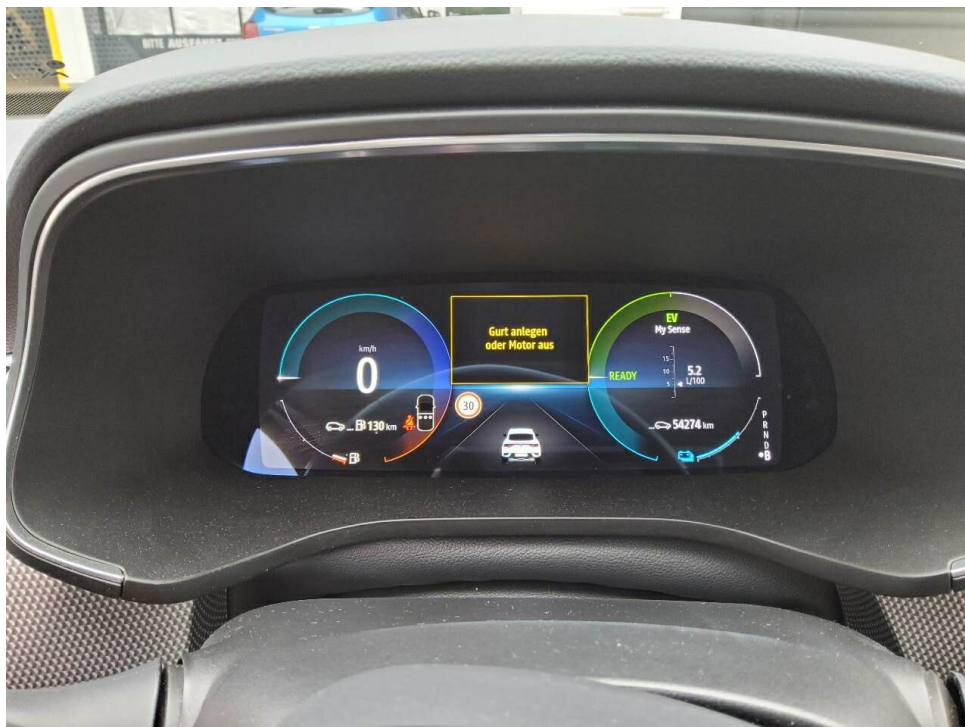
Bild 6 : Kombiinstrument (betriebsbereit) mit Kilometerstand
