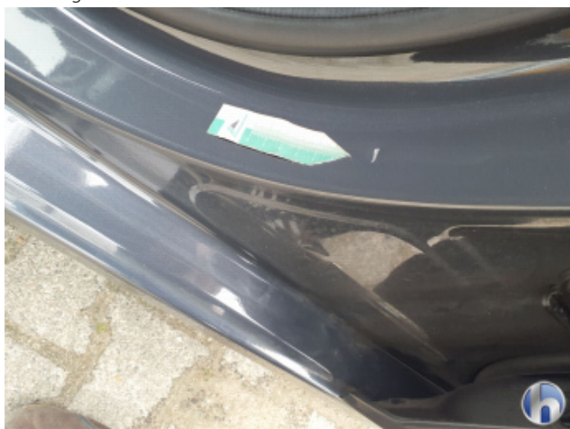
1. Schweller - Links Gebrauchsspuren - Ohne Reparatur
