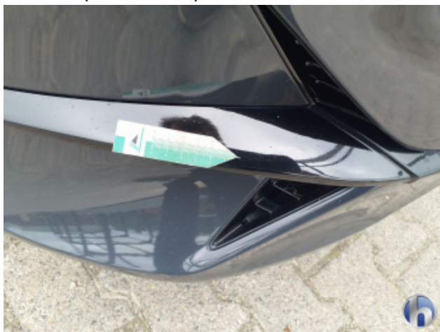
11. Zierelement Front Beschädigt - Erneuern
