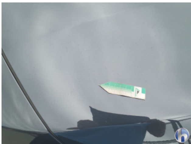
5. Motorhaube Kratzer - Nacharbeiten
