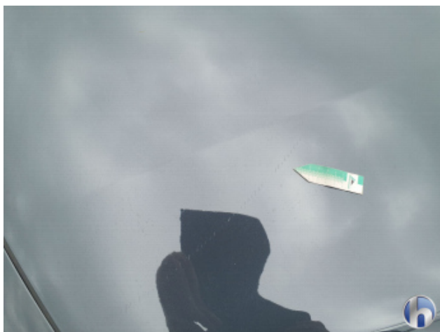
5. Motorhaube Kratzer - Nacharbeiten
