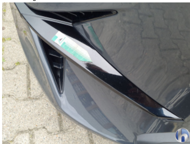
11. Zierelement Front Beschädigt - Erneuern
