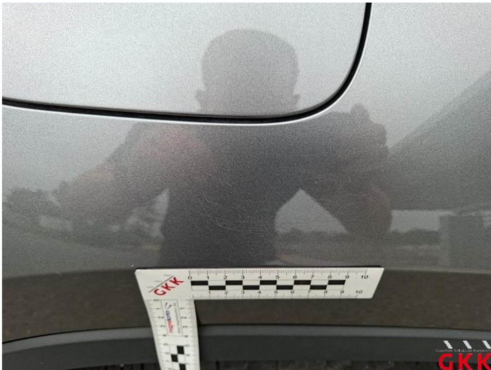
Bild 48. Seitenwand rechts, verkratzt, auslegen, schleifen, polieren
