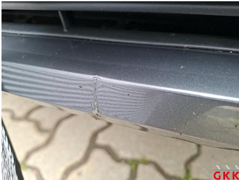
Bild 40. Stoßfänger vorne, Verkleidung unterhalb -lackiert-, beschädigt, ersetzen
