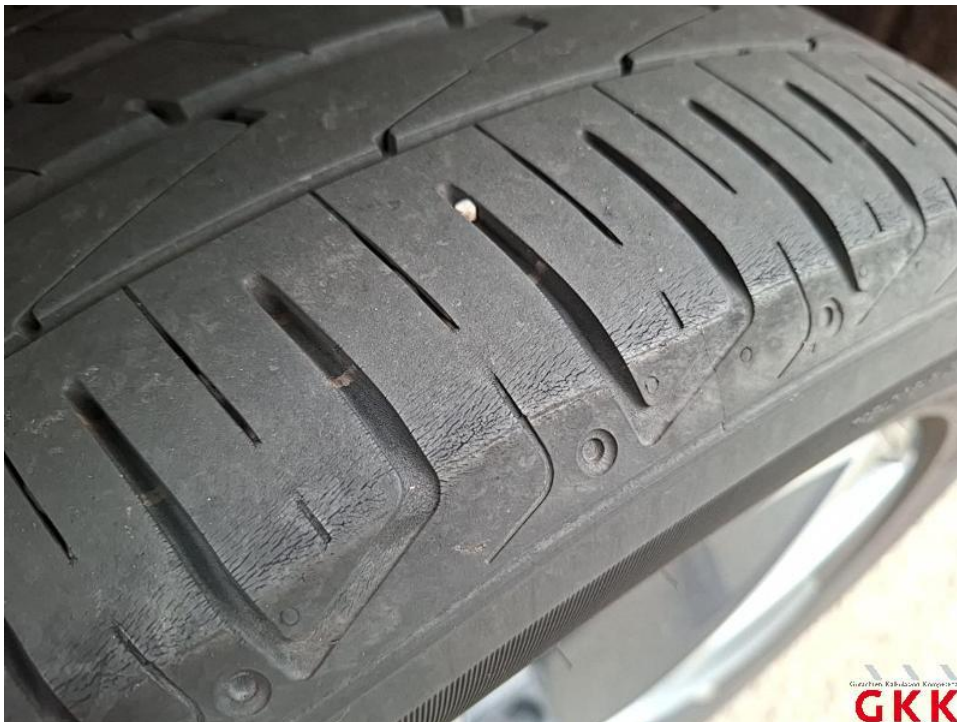
Bild 19. Reifen, hinten links und rechts, porös, ersetzen
