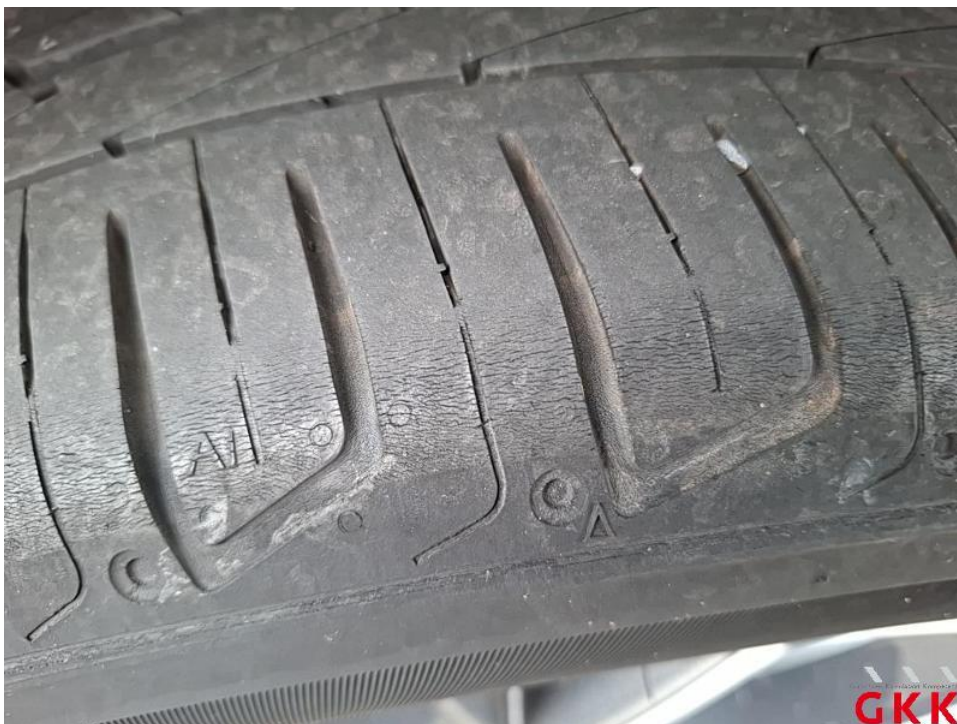
Bild 20. Reifen, hinten links und rechts, porös, ersetzen
