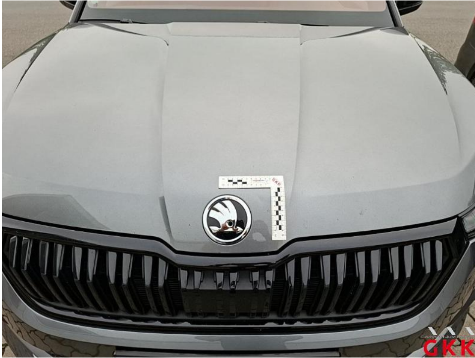
Bild 29. Motorhaube, bis 3 Dellen / Bauteil, kalt drücken
