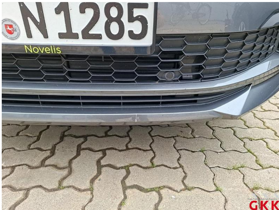
Bild 38. Stoßfänger vorne, Verkleidung unterhalb -lackiert-, beschädigt, ersetzen
