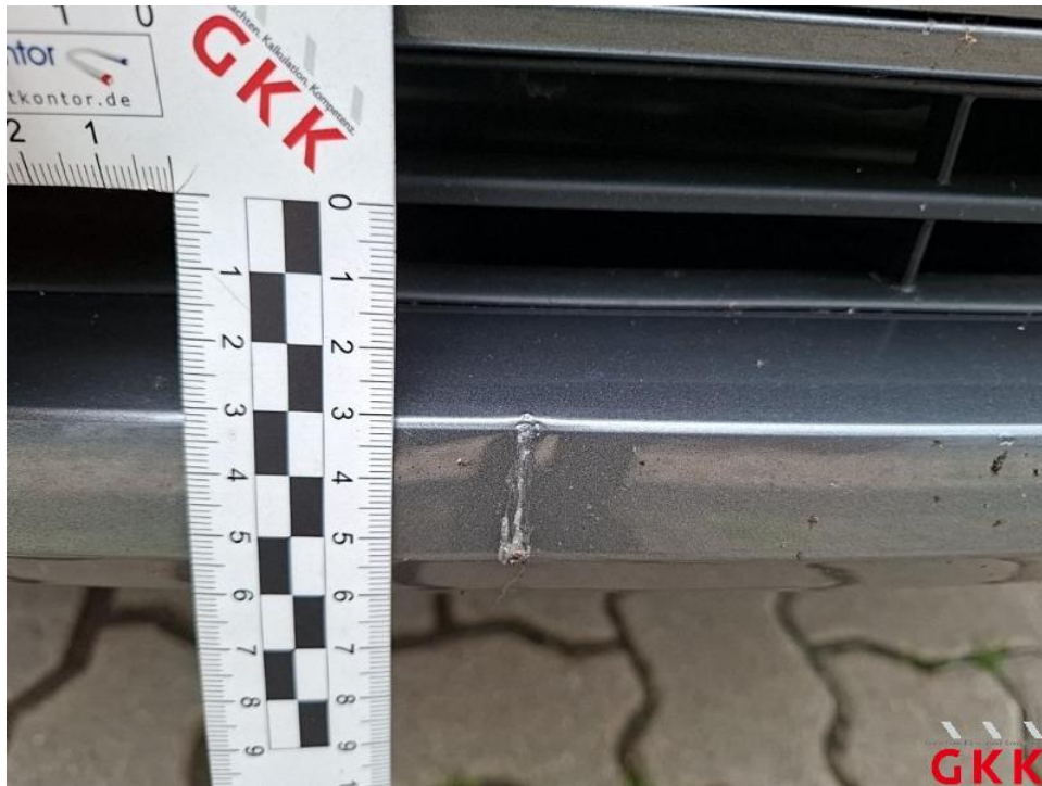
Bild 39. Stoßfänger vorne, Verkleidung unterhalb -lackiert-, beschädigt, ersetzen
