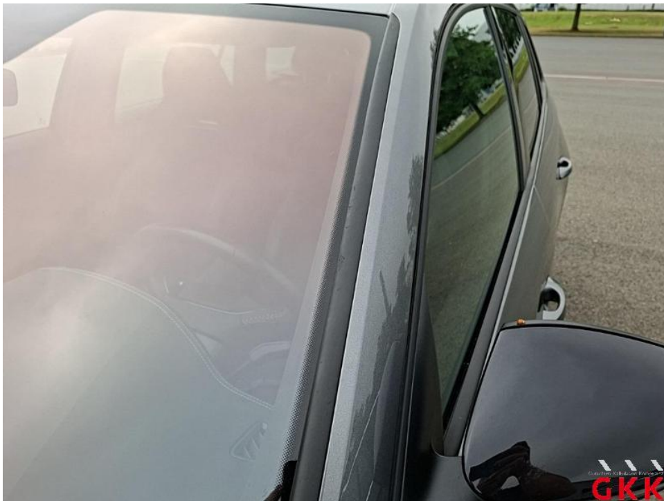
Bild 34. Frontscheibe, Leiste -links-, verkratzt, ersetzen
