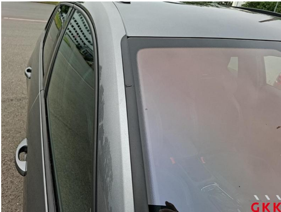
Bild 36. Frontscheibe, Leiste -rechts-, verkratzt, ersetzen
