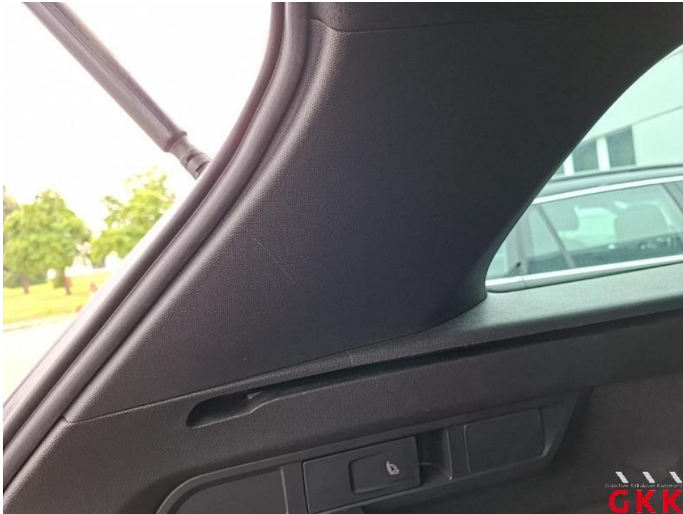
Bild 23. D- Säule links, Innenverkleidung, verkratzt, ersetzen
