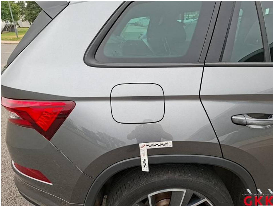
Bild 47. Seitenwand rechts, verkratzt, auslegen, schleifen, polieren
