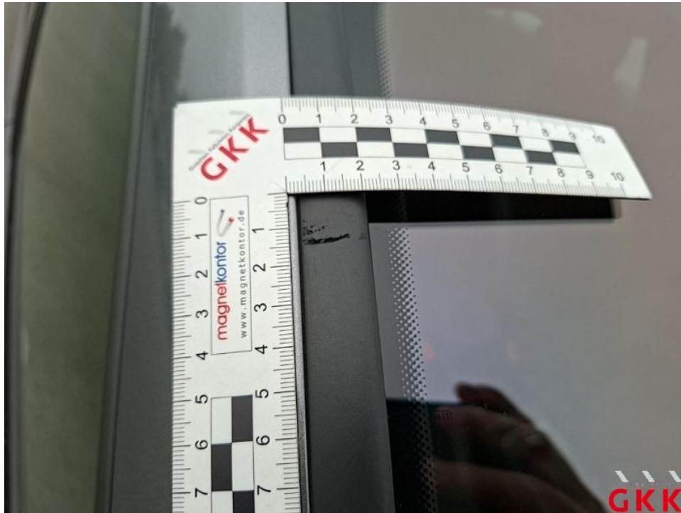
Bild 37. Frontscheibe, Leiste -rechts-, verkratzt, ersetzen
