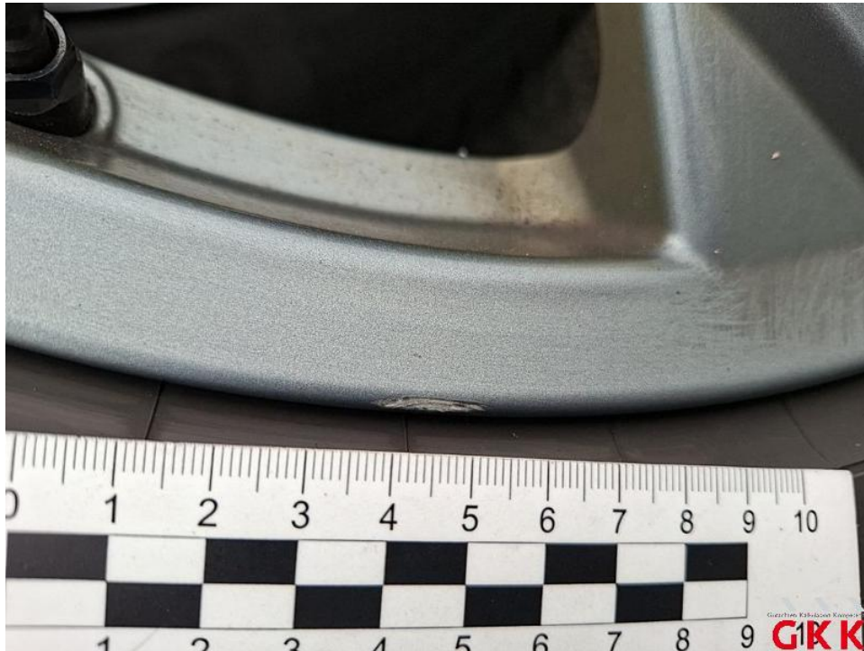
Bild 17. LM-Rad, 1 x beiliegend, verkratzt, Smartrepair
