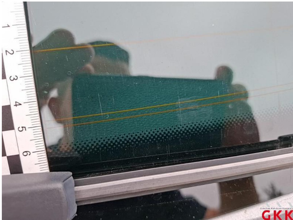
Bild 44. Heckscheibe, getönt, verkratzt, ersetzen
