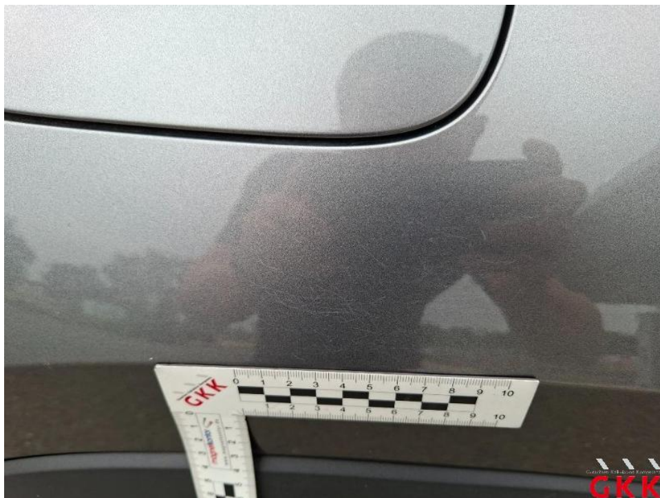
Bild 49. Seitenwand rechts, verkratzt, auslegen, schleifen, polieren
