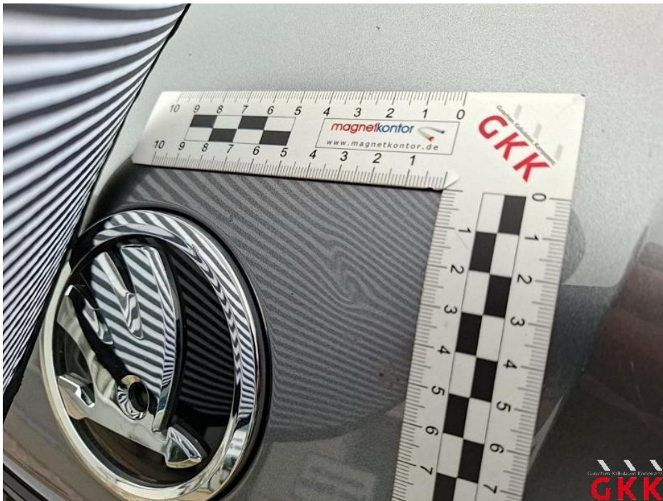
Bild 30. Motorhaube, bis 3 Dellen / Bauteil, kalt drücken
