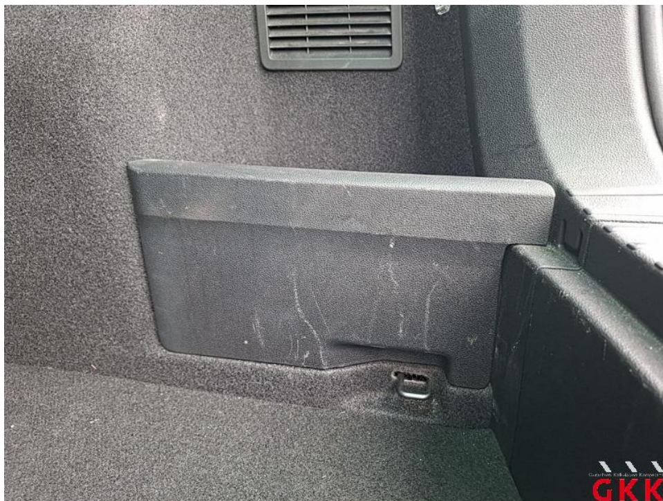
Bild 21. Seitenwand rechts, Innenverkleidung -Klappe-, verkratzt, ersetzen
