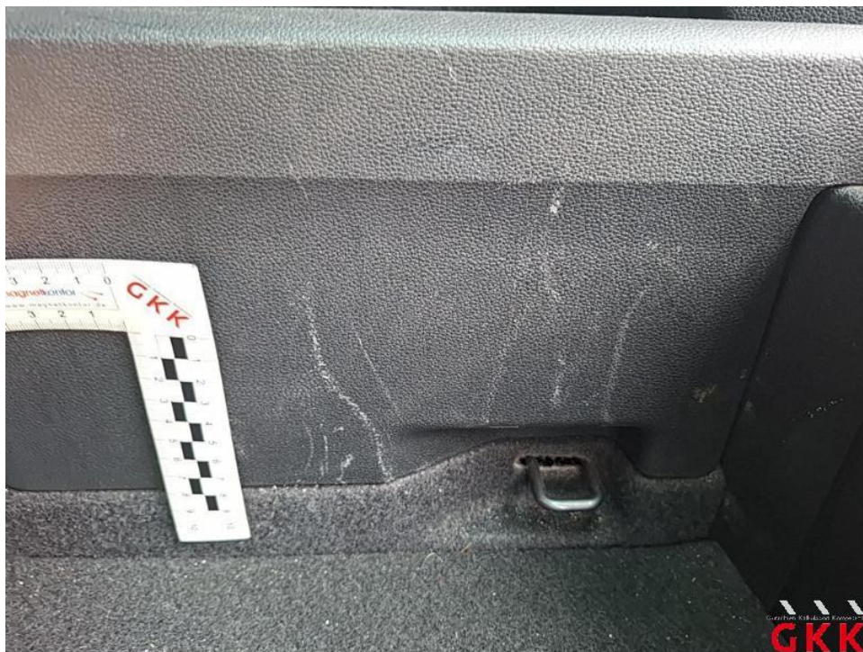
Bild 22. Seitenwand rechts, Innenverkleidung -Klappe-, verkratzt, ersetzen
