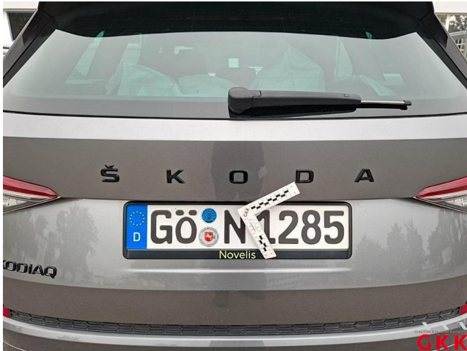
Bild 45. Heckklappe, oberhalb, verkratzt, auslegen, schleifen, polieren
