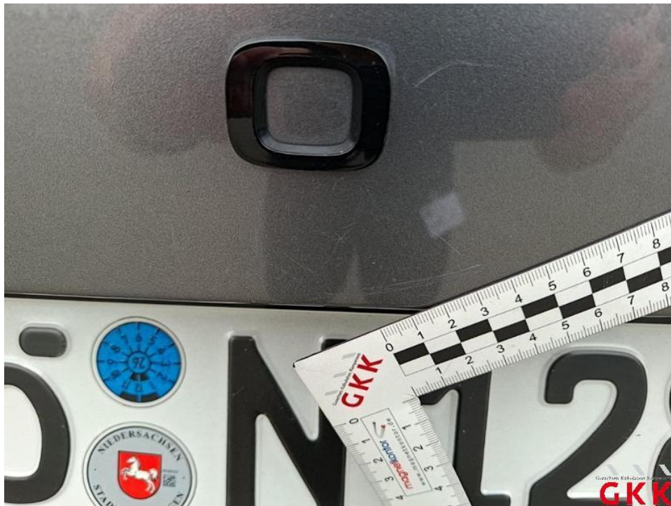
Bild 46. Heckklappe, oberhalb, verkratzt, auslegen, schleifen, polieren
