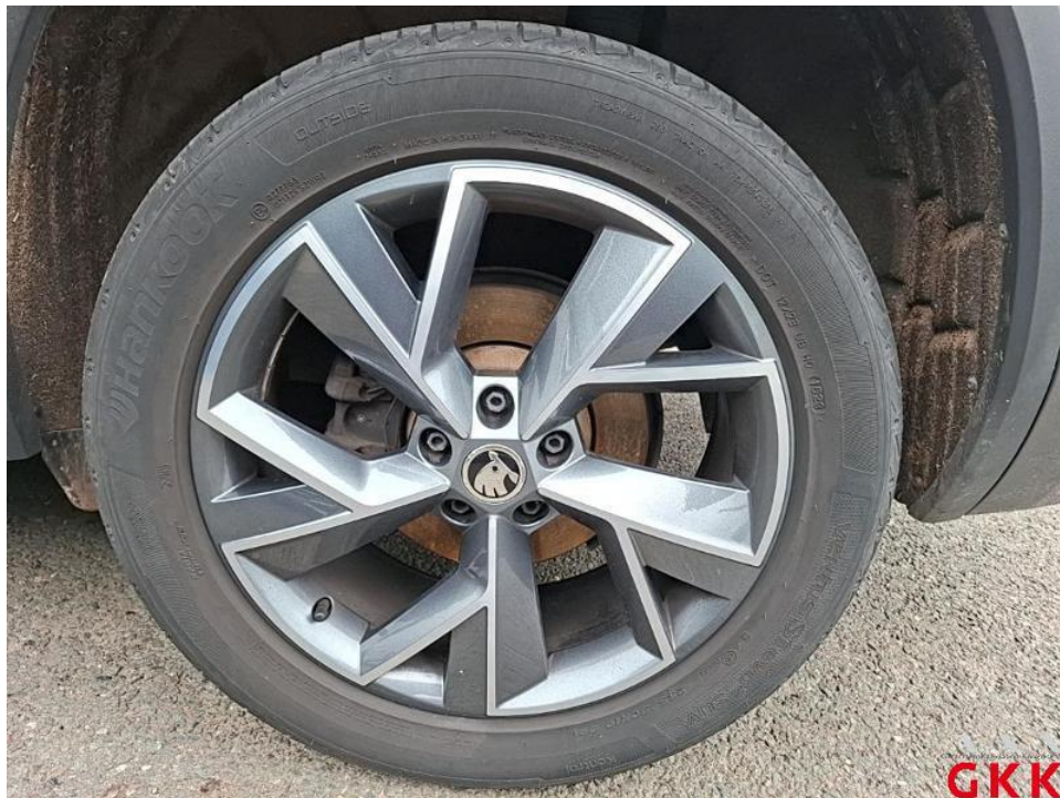
Bild 18. Reifen, hinten links und rechts, porös, ersetzen
