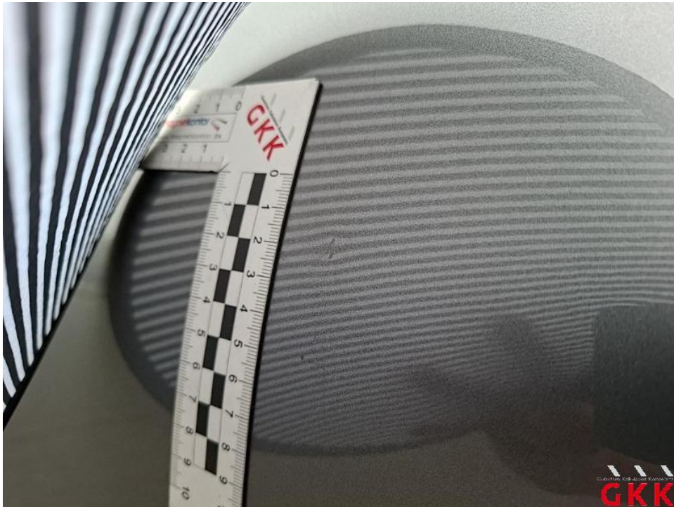
Bild 33. Tür hinten rechts, beschädigt, instand setzen - lackieren
