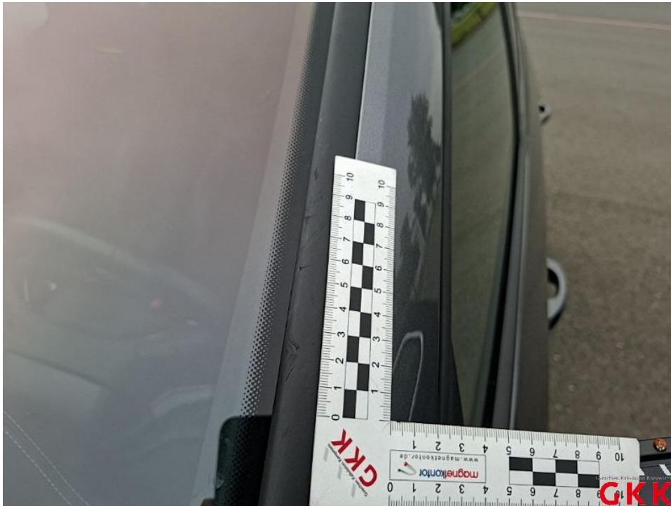
Bild 35. Frontscheibe, Leiste -links-, verkratzt, ersetzen
