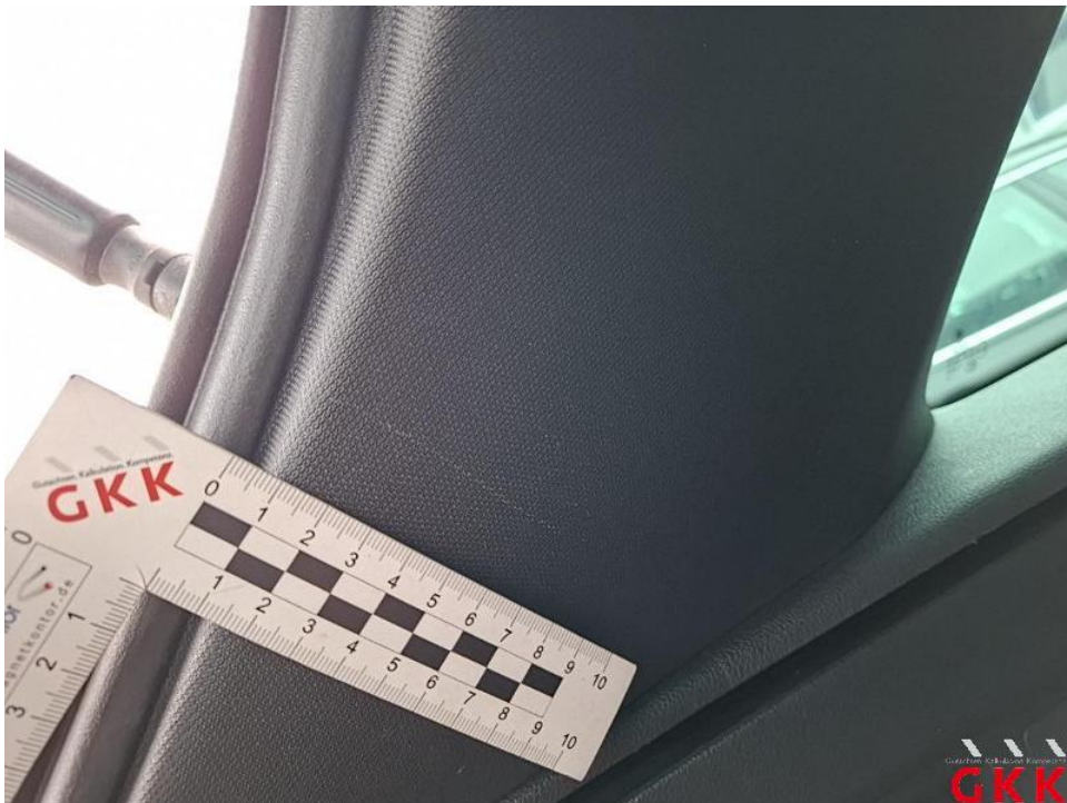
Bild 24. D- Säule links, Innenverkleidung, verkratzt, ersetzen
