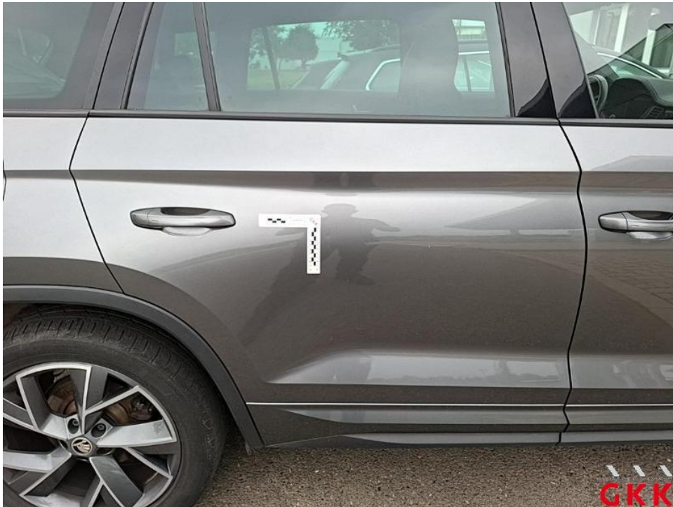
Bild 31. Tür hinten rechts, beschädigt, instand setzen - lackieren
