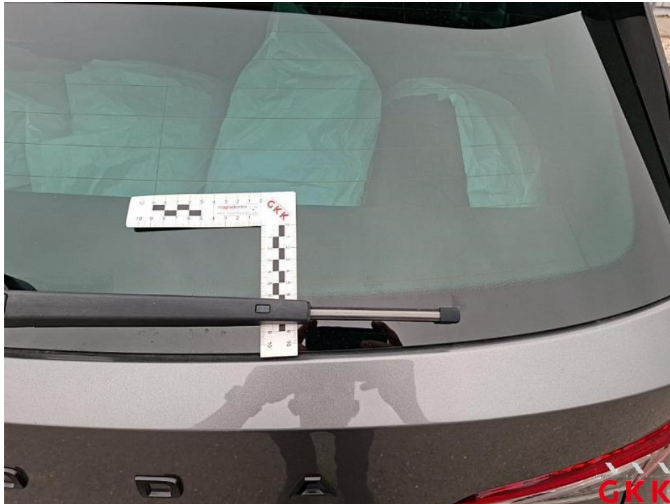
Bild 43. Heckscheibe, getönt, verkratzt, ersetzen
