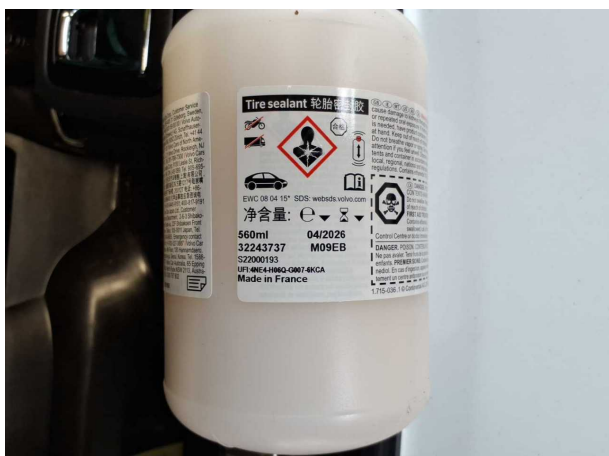
Beschädigung #2: Ausrüstung: Tirefit Füllmittel - abgelaufen - erneuern
