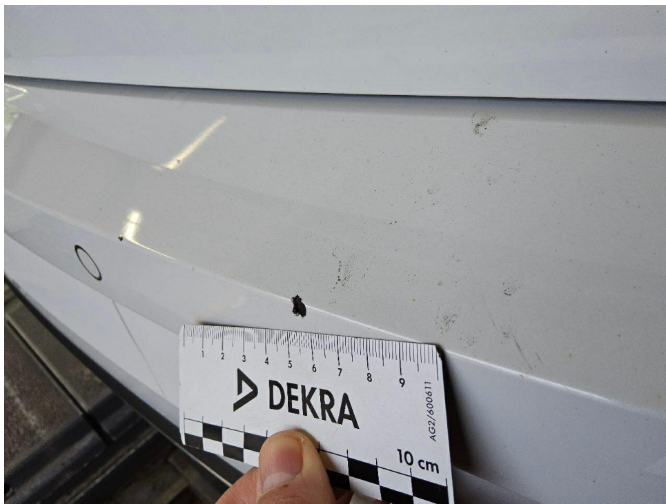
Bild 24 : Stoßfänger hinten zerkratzt
