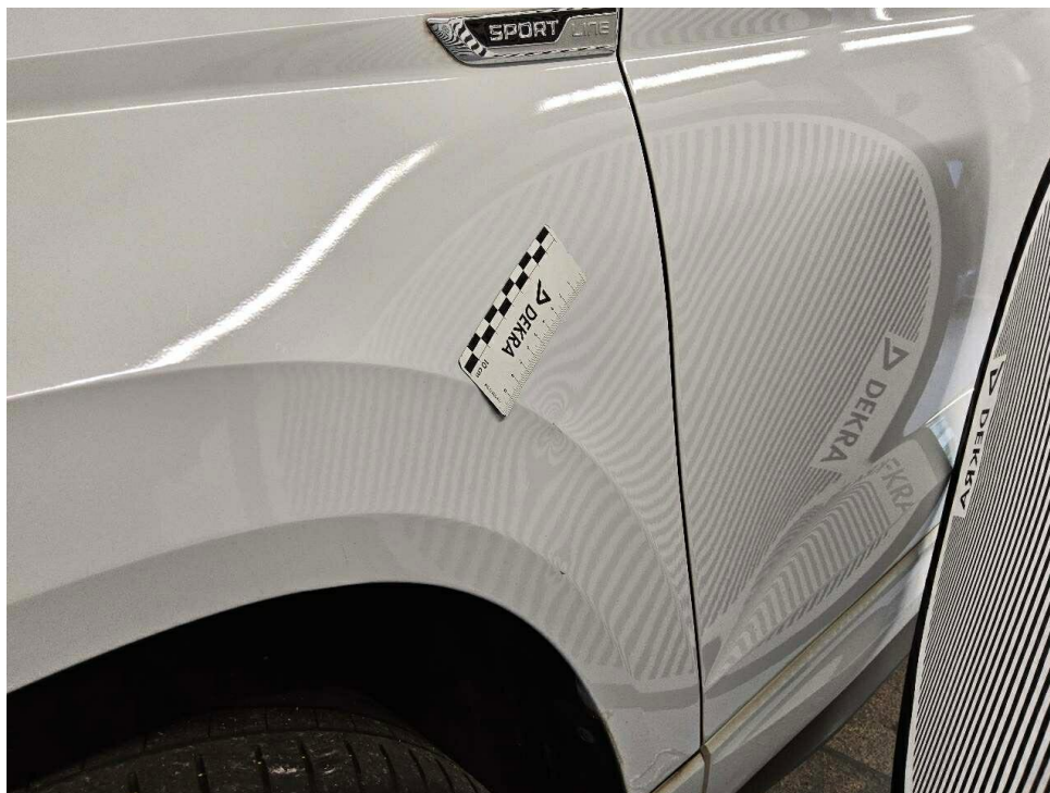
Bild 21 : Kotflügel links deformiert
