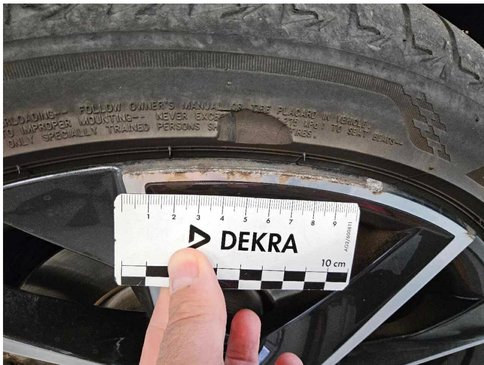
Bild 19 : Alufelge vorne links zerkratzt glanzgedreht
