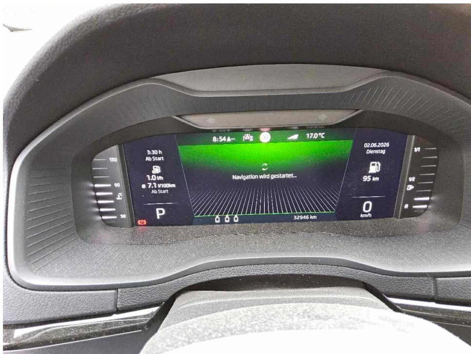
Bild 6 : Kombiinstrument (betriebsbereit) mit Km-Stand
