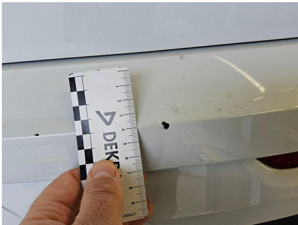
Bild 23 : Stoßfänger hinten zerkratzt
