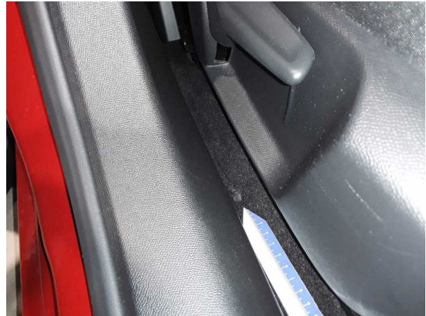
Beschädigung #1: Verkleidungen/Abdeckungen: Teppichboden vorn rechts - Brandloch - Smart Repair
