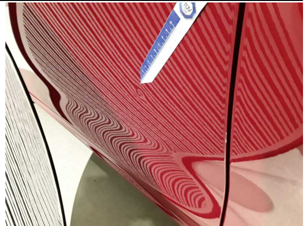
Beschädigung #3: Tür vorn links: Tür - Delle / Lackschaden - instandsetzen und lackieren
