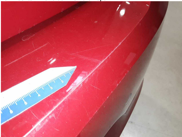
Beschädigung #2: Stossfänger hinten: Stossfänger hinten - verkratzt / verschürft - lackieren
