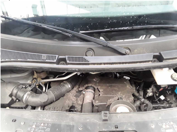
Beschädigung #4: Motor: Motorabdeckung - Marderschaden - erneuern
