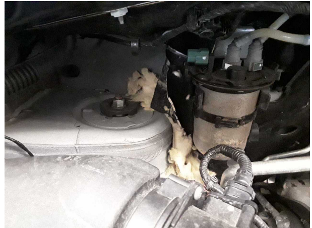
Beschädigung #5: Fahrerhaus: Dämmmatte - Marderschaden - erneuern
