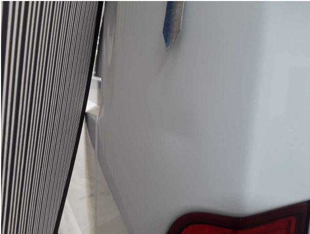
Beschädigung #3: Seitenwand links: Seitenwand - Delle(n) - Smart Repair
