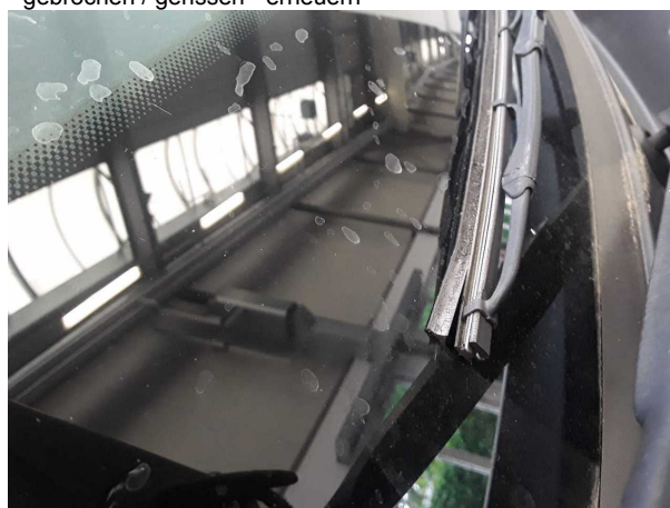
Beschädigung #2: Scheibenreinigung: Scheibenwischerblätter vorn - gebrochen / gerissen - erneuern
