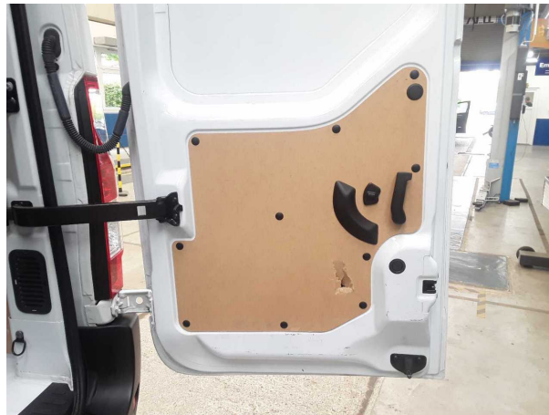
Beschädigung #1: Heckklappe/-tür: Verkl. Hecktür Hartfaser unten - gebrochen / gerissen - erneuern
