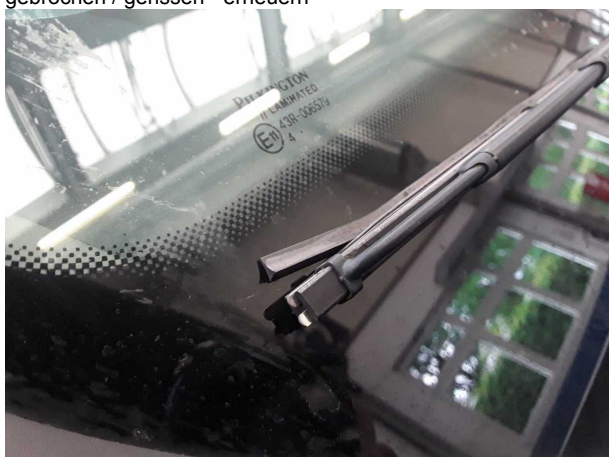
Beschädigung #2: Scheibenreinigung: Scheibenwischerblätter vorn - gebrochen / gerissen - erneuern
