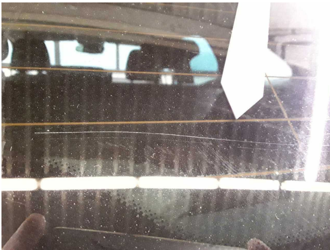
Damage 4: Vehicle glazing: Rear window (Verkratzt/verschürft im Sichtbereich) - Scratched - Replace
