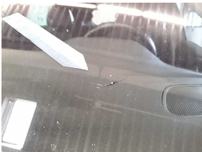
Damage 8: Vehicle glazing: Windscreen (Mit Rissbildung im Fahrersichtfeld) - Stone chips - Replace
