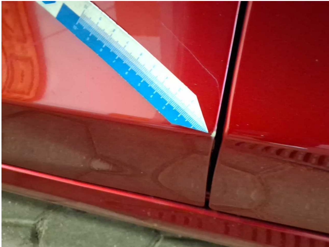
Beschädigung 5: Tür vorn links: Tür - verkratzt / verschürft - lackieren
