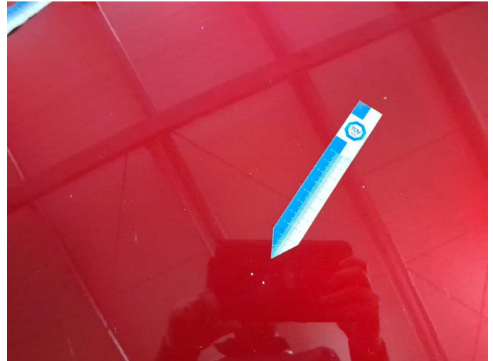
Beschädigung 7: Motorhaube: Motorhaube - Steinschlag - lackieren
