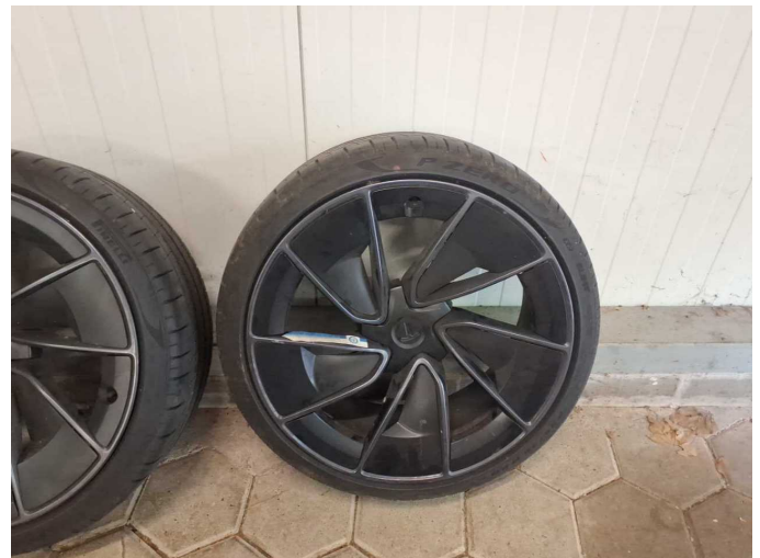
Beschädigung 9: 2.Radsatz: 3 Leichtmetallfelgen - verkratzt / verschürft - erneuern
