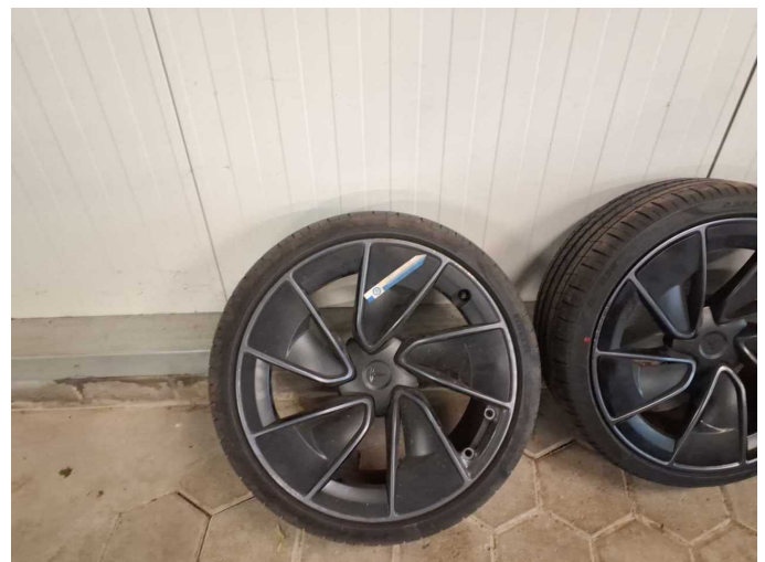
Beschädigung 9: 2.Radsatz: 3 Leichtmetallfelgen - verkratzt / verschürft - erneuern
