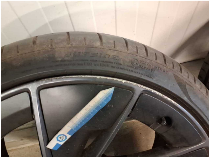
Beschädigung 9: 2.Radsatz: 3 Leichtmetallfelgen - verkratzt / verschürft - erneuern
