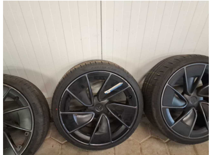
Beschädigung 9: 2.Radsatz: 3 Leichtmetallfelgen - verkratzt / verschürft - erneuern
