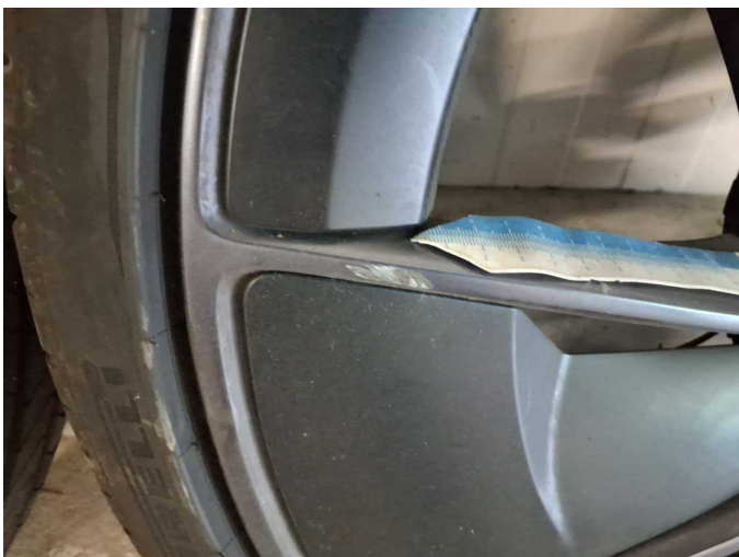
Beschädigung 9: 2.Radsatz: 3 Leichtmetallfelgen - verkratzt / verschürft - erneuern
