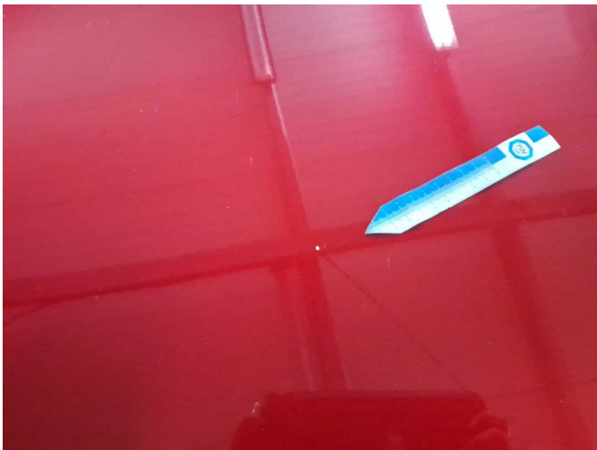
Beschädigung 7: Motorhaube: Motorhaube - Steinschlag - lackieren
