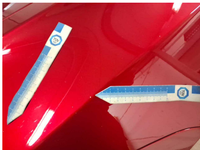
Beschädigung 4: Kotflügel links: Kotflügel links - Steinschlag - lackieren
