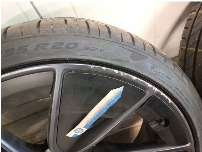
Beschädigung 9: 2.Radsatz: 3 Leichtmetallfelgen - verkratzt / verschürft - erneuern
