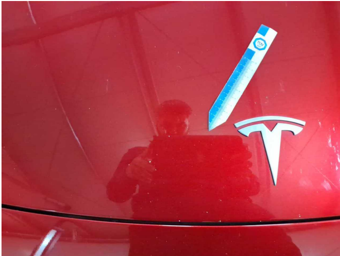
Beschädigung 7: Motorhaube: Motorhaube - Steinschlag - lackieren
