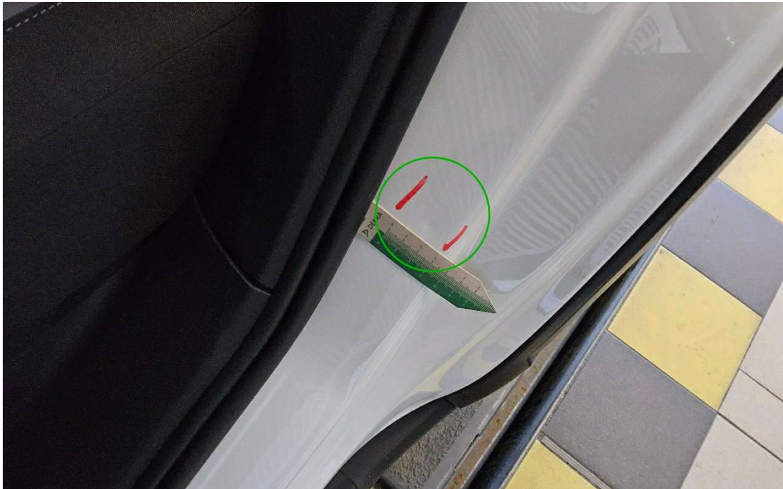
Bild 19 : Tür hinten links Einstieg, eingedellt, smart repair
