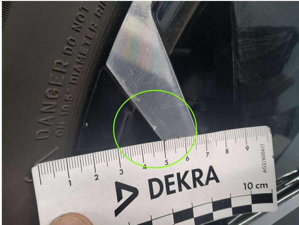
Bild 17 : Felge vorne links (glanzgedreht), Steinschlag
