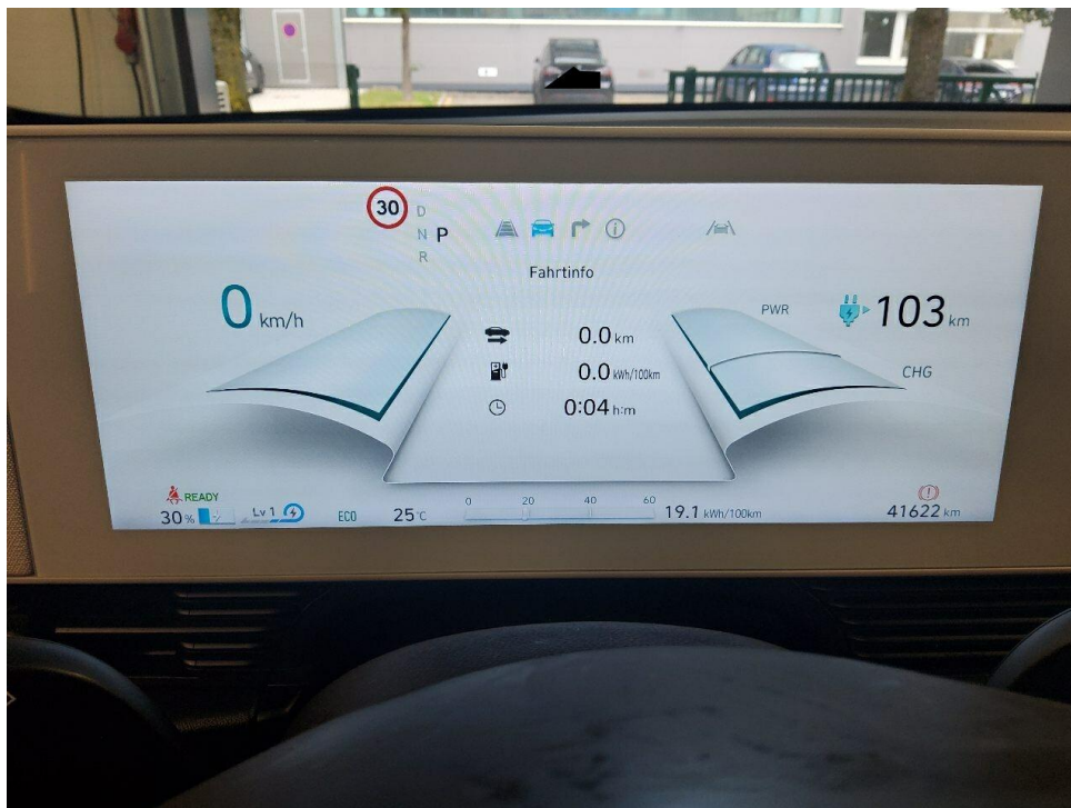
Bild 6 : Kombiinstrument (betriebsbereit) mit Km-Stand
