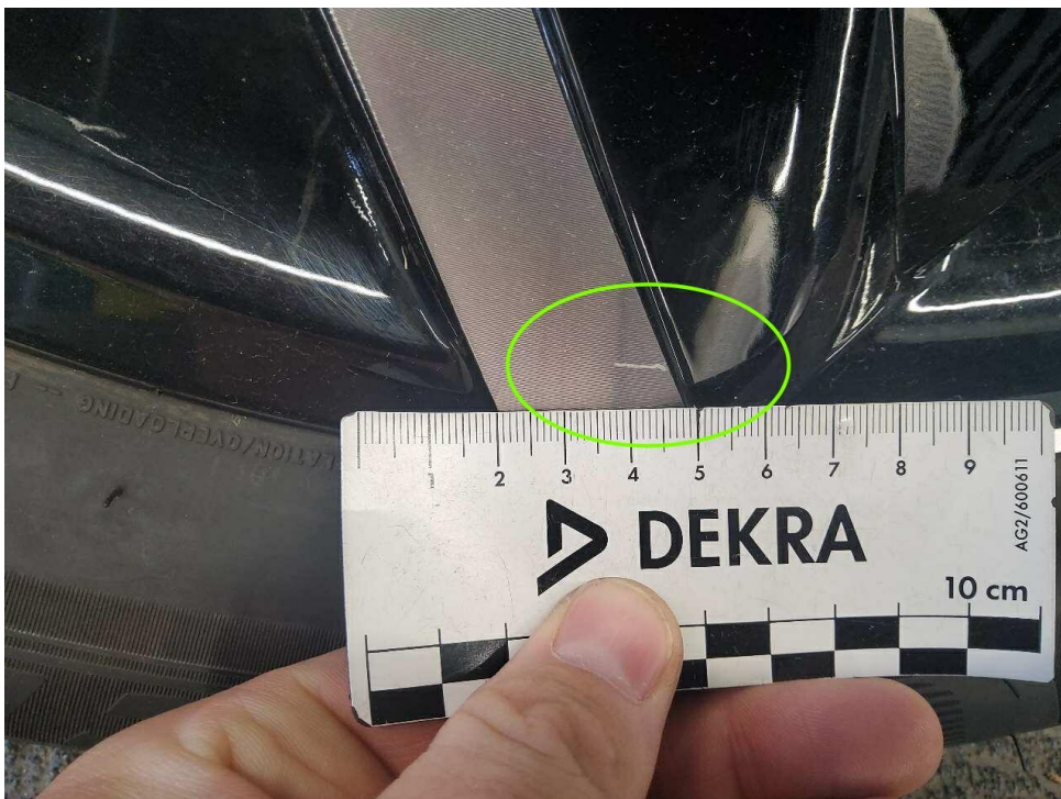
Bild 20 : Felge hinten rechts (glanzgedreht), Oxidation
