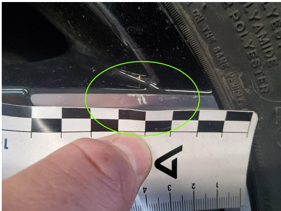
Bild 18 : Felge hinten links (glanzgedreht), Klarlackablösung
