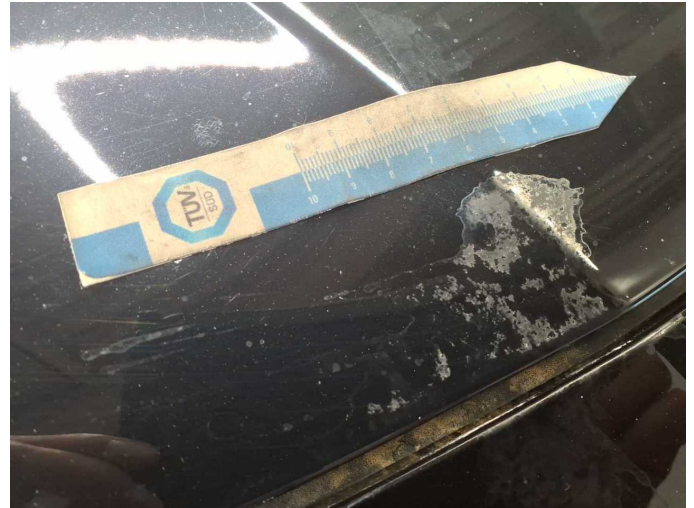
Damage 6: Bonnet: Bonnet (Verätzungen + Kratzer) - Paint defect - Paint
